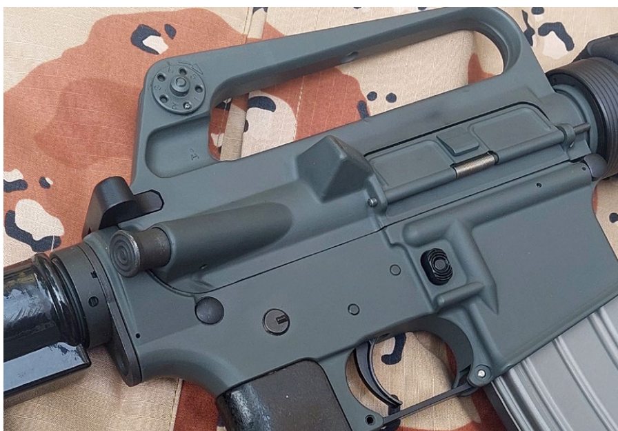
Runde Schließhilfen kamen ebenfalls erst mit dem Upgrade zum M16A2
