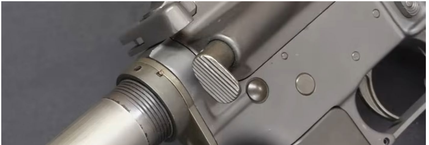
Erst mit der Einführung des M16A2 erhielt die Schließhilfe einen runden Knopf. Bei allen XM16A1 und CAR-15 Modellen war sie tropfenförmig
