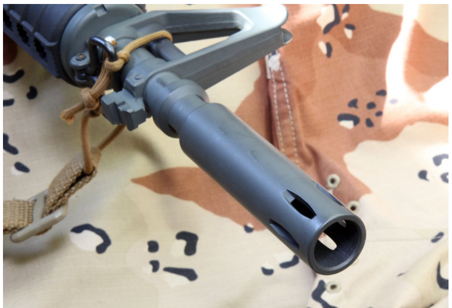
Der elf Zentimeter lange „Moderator“ sollte mit der Einführung in den 1960er Jahren vor allem den extrem lauten Mündungsknall der kurzen 10"-Läufe reduzieren. Er wurde zu einem offensichtlichen Erkennungsmerkmal aller XM177. Bei der OA-15 Kleinserie ist er fest mit dem Lauf verbaut
