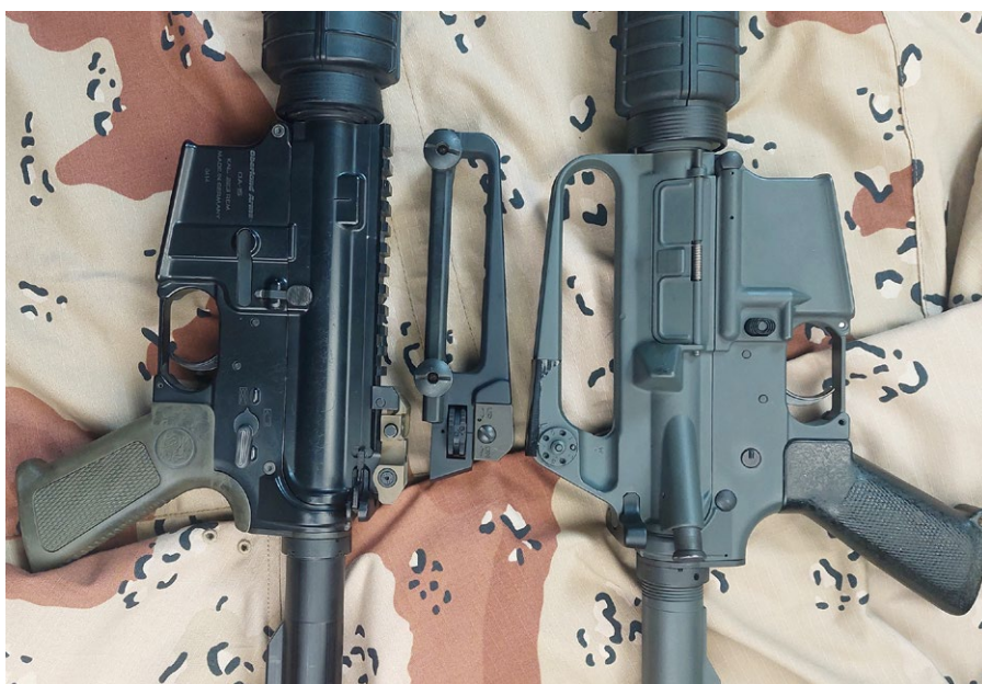
Verdeutlicht den Unterschied: Links im Bild das Black Label M4 mit dem sog. Flat-Top Receiver. Die Visiereinrichtung ist abnehmbar und besitzt die typische Rändelschraube zur Höhenkorrektur, wie sie von den U.S. Marines in den 1980er Jahren gefordert wurde, um auch Ziele außerhalb des durchgehenden Visierbereichs bekämpfen zu können. Rechts das A1-Visier eines XM16, bzw. M16A1 bzw. XM177
