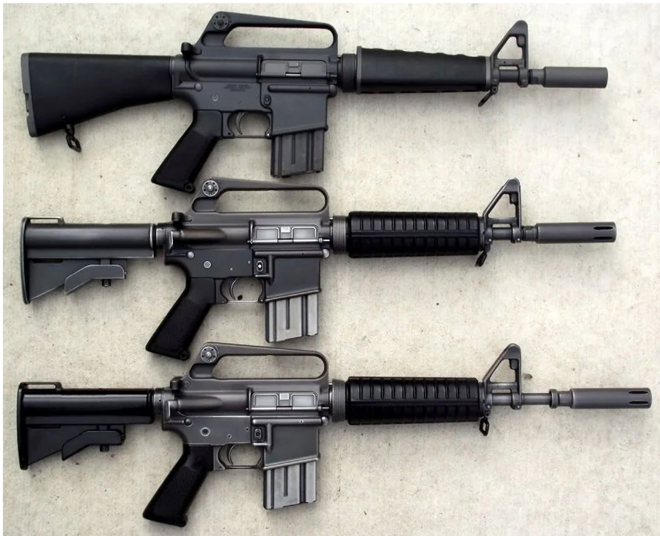
Von oben: Colt Model 607, auch als Baby-M16 bezeichnet hatte einen verkürzten Trapezförmigen Vorderschaft des XM16. Der Hinterschaft ist ausziehbar. Keine Schließhilfe. Der „Moderator“ ist noch 3" lang. Der Lower Receiver besitzt noch den sog. „Slabside Mag Well“, ohne Kontur um den Magazinauslöser. Colt Model 609: Das XM177E1: 10"-Lauf, Forward-Assist, 4,5"-Moderator Colt Model 639: XM177E2: 11,5"-Lauf und ebenfalls Forward-Assist und 4,5"-Moderator
