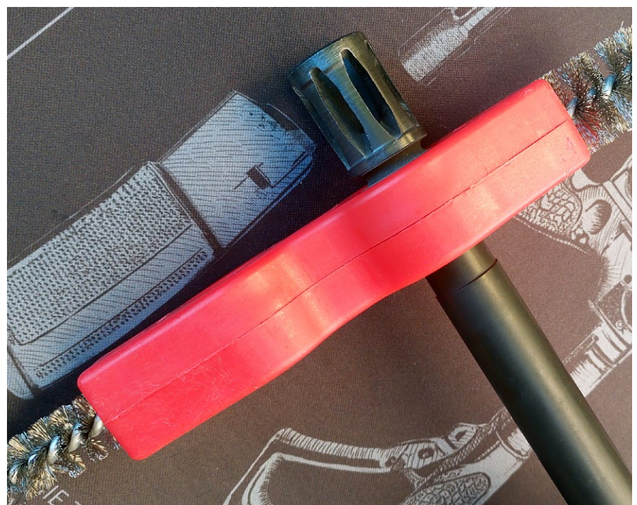
A2-Feuerdämpfer können leicht von Pulverschmauch befreit werden
