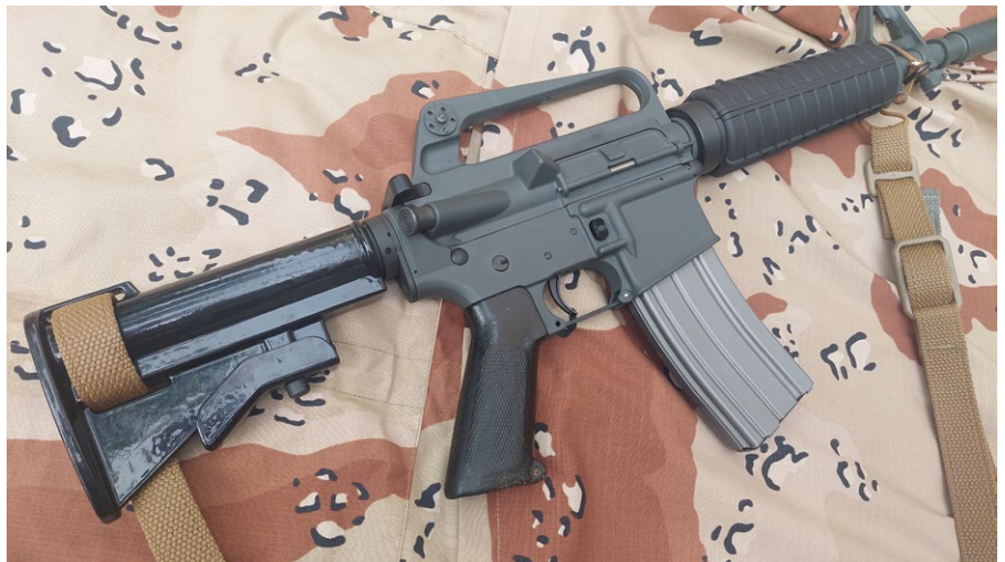
Das Griffstück ist ein Originalteil der M16A1 Baureihe. Der runde Vorderschaft hat einen geringeren Durchmesser als die M4-Schäfte, wie sie bspw. an den Black Label Gewehren von Oberland verbaut wurden
