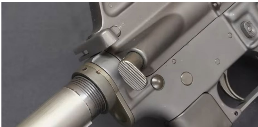
Nur Modelle mit dem Zusatz E1 hatten überhaupt einen „Forward Assist“ (Schließhilfe) und dieser war tropfenförmig
