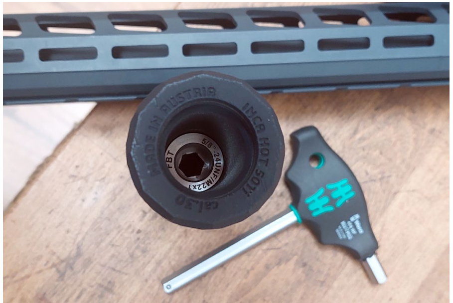
Mittels Gewindeadapter werden die M22x1 des FBT-Dämpfers auf die 5/8"-24 UNEF der Ruger reduziert. Der Gewindeadapter sollte vorzugsweise in den Dämpfer eingeklebt werden
