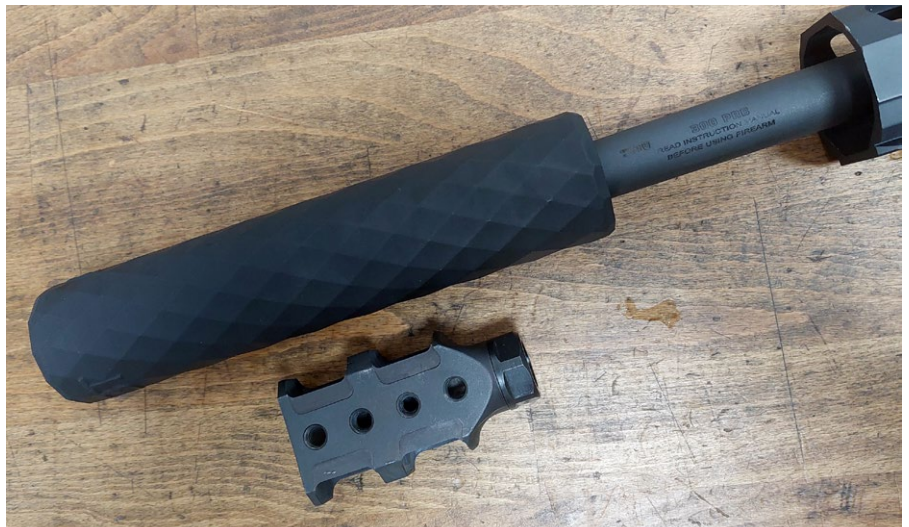
Als Overbarrel-Dämpfer erhöht er die Gesamtlänge der Waffe um gerade einmal sechs Zentimeter
