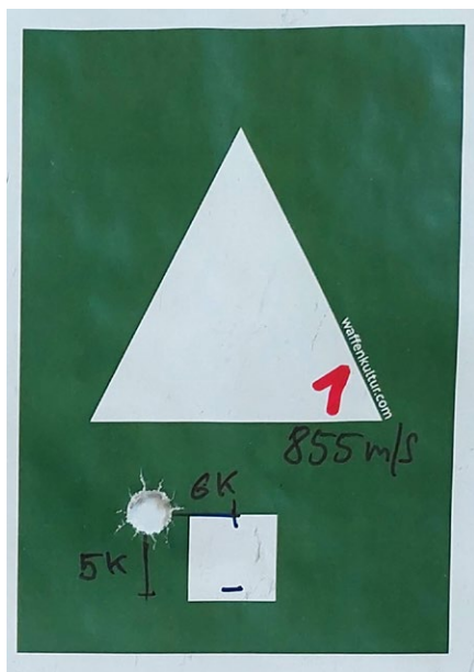
Auswertung Coldbore Shot ff. in der zweiten Trainingssitzung: Schuss 1) 855 Meter pro Sekunde, fünf Klick hoch, 6 Klick links Schuss 2) 856 Meter pro Sekunde, drei Klick hoch, 6 Klick links Schuss 3/4/5) durchschnittlich 855 Meter pro Sekunde, Gruppe drei Klick hoch, 6 Klick links
