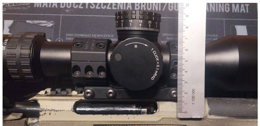
Das Offset bezeichnet den Abstand zwischen Laufseele und Objektiv (Hier: 46 Millimeter). Die Messung sollte mit Sorgfalt erfolgen. ZF-Aufbauten mit mehr als sechzig Millimeter Offset sind für das Scharfschützenwesen ungeeignet
