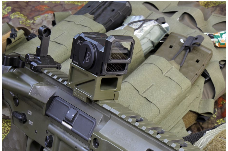
Die Opferlinse lässt sich entfernen
