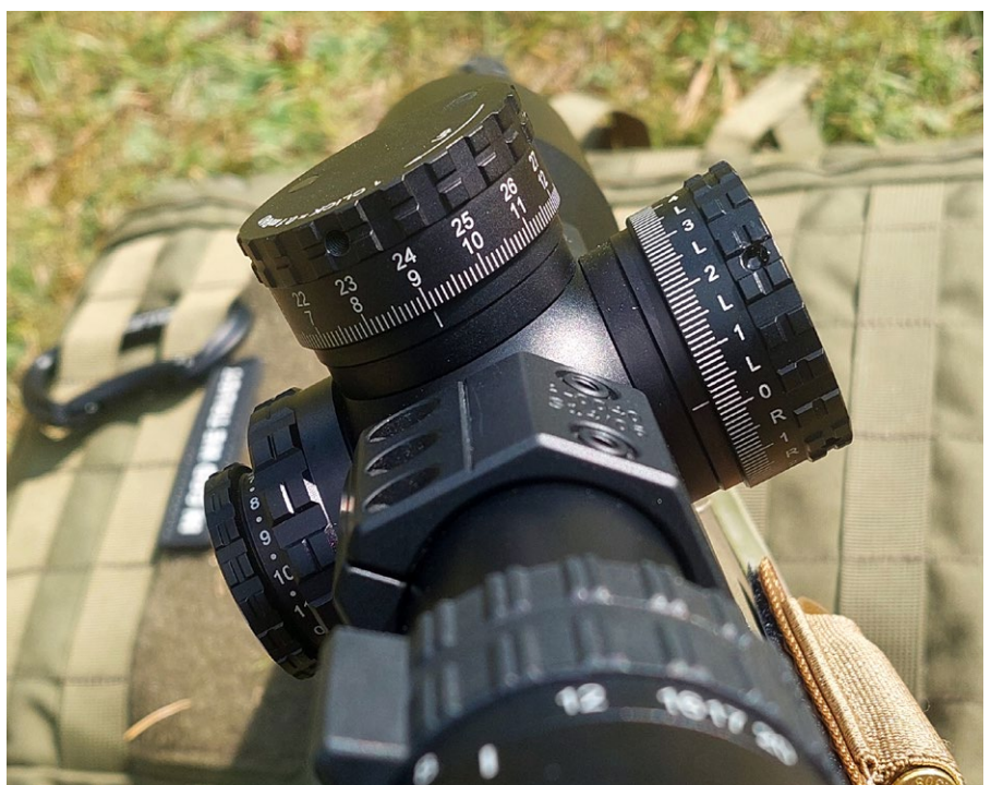
Die mittige Kerbe auf der SPUHR-Montage dient als Hilfsmittel, das ZF unverkantet auszurichten
