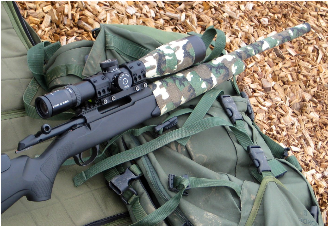
Die Ausrüstung wird gegen den Schütze arbeiten, wenn beim Versuch der Waffentarnung der Lauf seiner freischwingenden Eigenschaft beraubt wird
