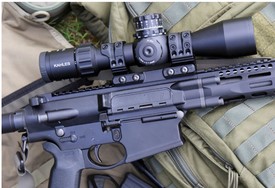
Im direkten Vergleich zum Savage AR-10 der Vor-Seite sind die Defizite offensichtlich: Die Blockmontage baut zu hoch. Bei einem AR-typischen Schaftsystem erhält der Schütze keine stabile Kopfposition. Präzisionsverluste sind die Folge
