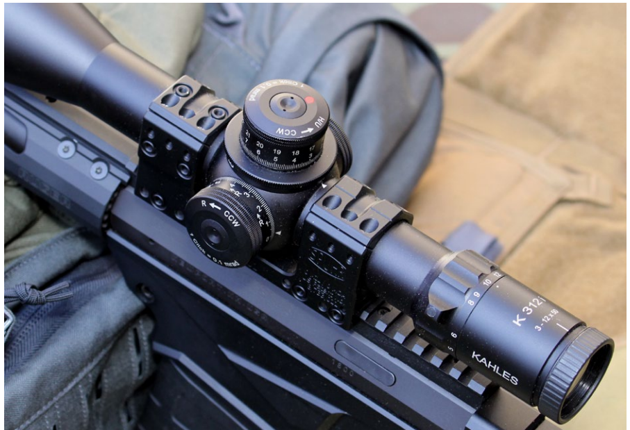
Kahles-Variante Seitenturm links: Diese Sondervariante sollte grds. mit Türmen in ccw-Drehrichtung ausgestattet sein
