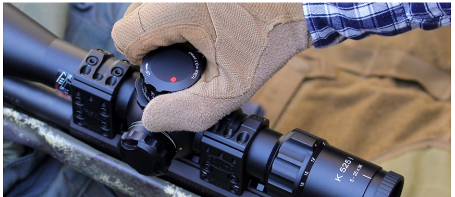
Standardhandhabung: Bei einer cw-Drehrichtung werden die Türme mit der rechten Hand bedient und zur Daumenspitze hin gedreht. Was einer Korrektur nach oben bzw. nach rechts entspricht
