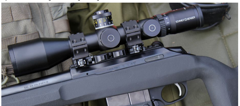
Auch dieses ZF sitzt zu hoch. Darüber hinaus sind Blockmontagen mit Schnellspannsystem auf ZF-Waffen nicht notwendig
