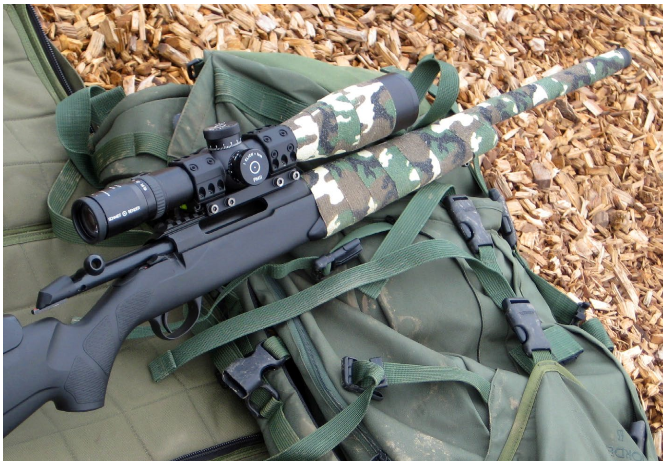
Die Ausrüstung wird gegen den Schütze arbeiten, wenn beim Versuch der Waffentarnung der Lauf seiner freischwingenden Eigenschaft beraubt wird
