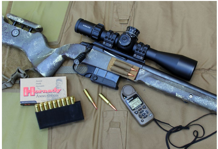
Das Kaliber 6.5 Creedmoor hat sich querschnittlich etabliert. Bei identischen Rückstoßverhalten hat die 6.5CM für Schüsse zwischen 800 und 1.000 Meter ballistische Vorteile gegenüber einer .308 Win.
