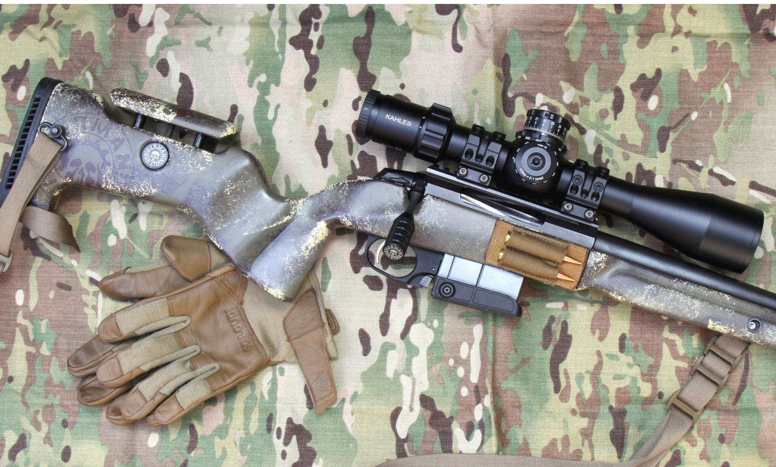
Korrekte Montage eines Kahles 525i auf einer Tikka T3 im German Gun Stock Schaft „Reaper“. Konstruktionsbedingt wäre aufgrund der vorgeneigten 20-MOA-Picatinny-schiene jede Blockmontage zu hoch. Deshalb wurden hier die Montageringe SR-4000 von SPUHR verbaut. Die stufenlos höhenverstellbare Schaftbacke muss lediglich um einen Zentimeter erhöht werden
