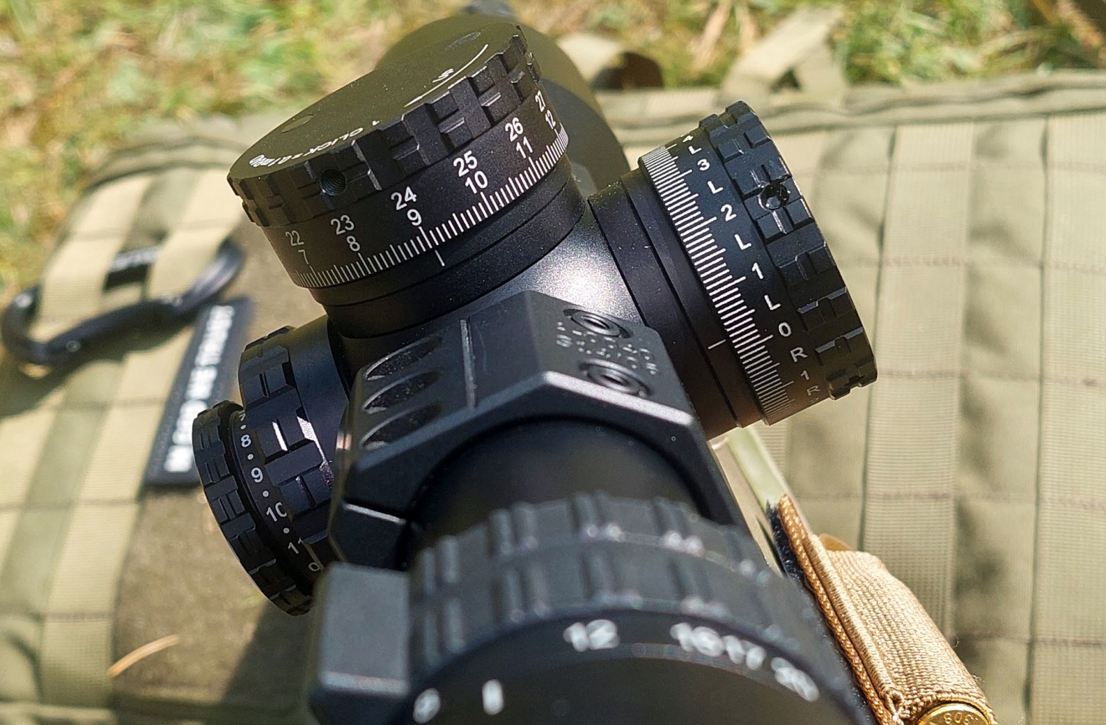
Die mittige Kerbe auf der SPUHR-Montage dient als Hilfsmittel, das ZF unverkantet auszurichten
