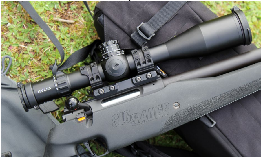
Die Einzelkomponenten dieser Konfiguration sind von Gewehr über die ZF-Montage bis hin zum ZF sehr hochwertig. Allerdings baut diese Blockmontage das ZF zu hoch. Zwischen Objektiv und Lauf würde die flache Hand passen. Diese Montage sollte zwingend ausgetauscht werden
