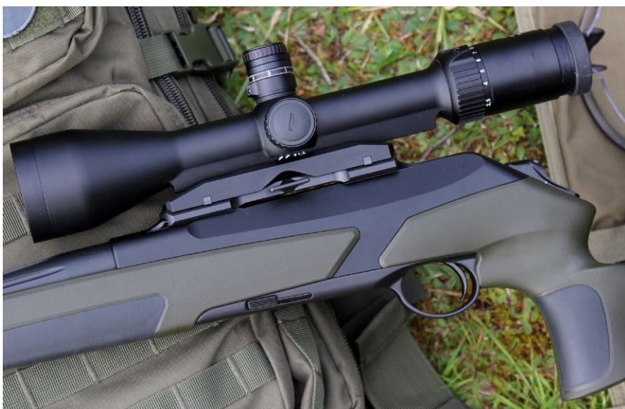
Rubrik: „Mein Büchsenmacher hat gesagt...“ Dieses ZF ist zu weit nach hinten montiert. Der Schütze wird niemals eine stabile Kopfposition aufbauen können. Ein grober Fehler, der jedem Gewehrschützen sofort auffallen muss
