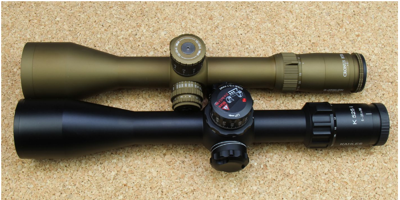
Zwei 56er-Objektive: Das Cronus BTR hat eine wesentlich kürzere Brennweite, als das Kahles K525
