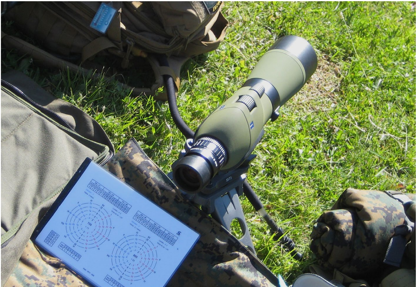
Die sog. ABAQUE der Schweizer Scharfschützen enthält alle Informationen, die für einen Langdistanztreffer notwendig sind. Durch die Laminierung bleibt man auch bei Regenwetter arbeitsfähig
