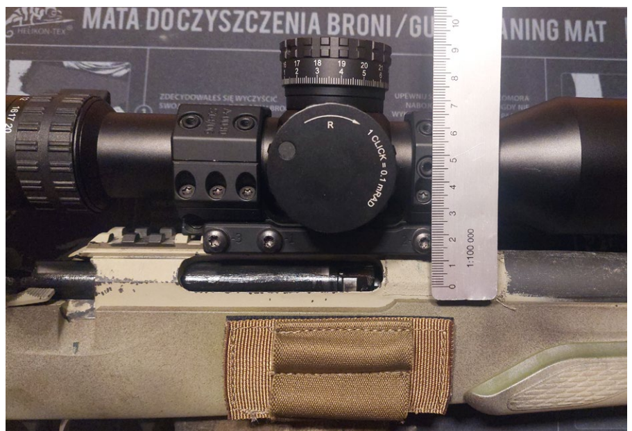
Das Offset bezeichnet den Abstand zwischen Laufseele und Objektiv (Hier: 46 Millimeter). Die Messung sollte mit Sorgfalt erfolgen. ZF-Aufbauten mit mehr als sechzig Millimeter Offset sind für das Scharfschützenwesen ungeeignet
