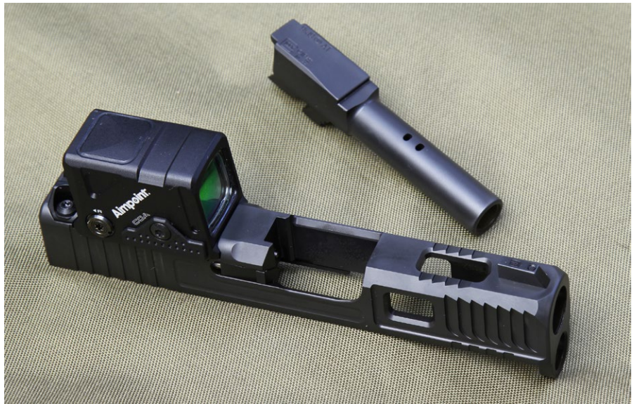
Der Glock 43 Verschluss ist skelettisiert
