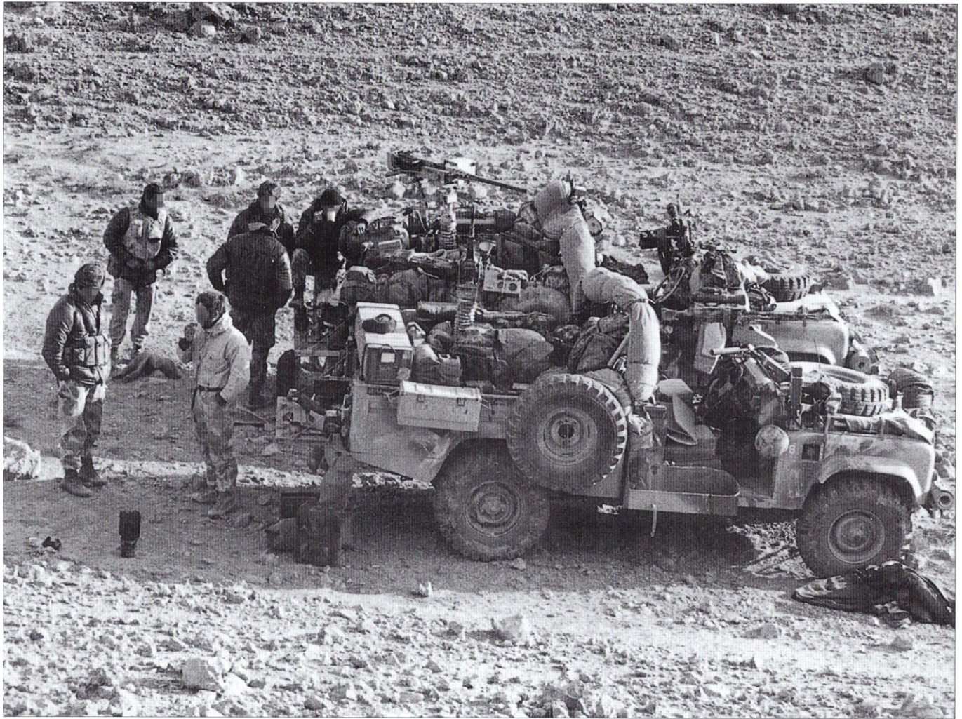
Im Bild zwei Land Rover 110 ausgerüstet mit Browning .50 BMG und leichten Maschinengewehren, Granatwerfern und Milan Panzerabwehrraketen
