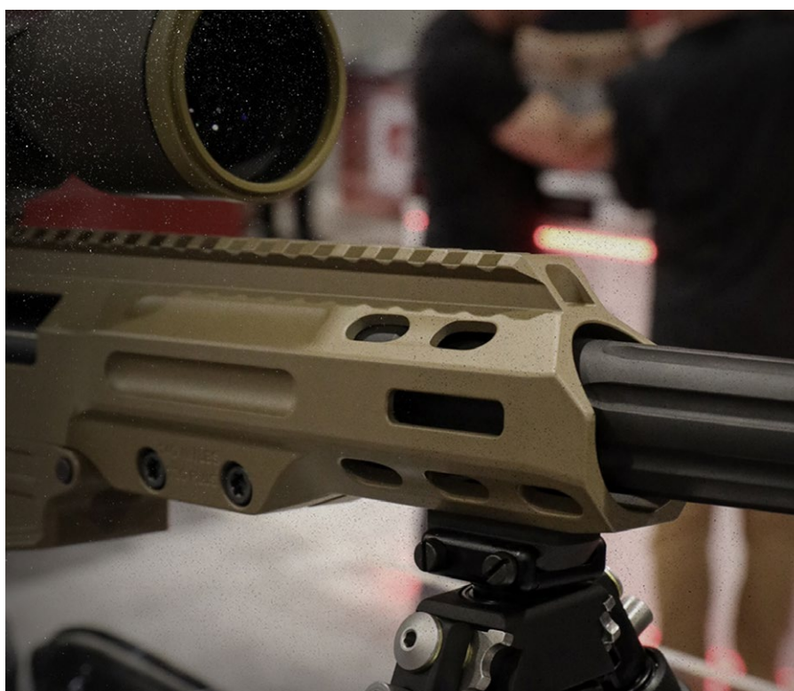
Die beiden Torx-Schrauben am Handschutz sichern den Lauf (Foto: Hersteller)
