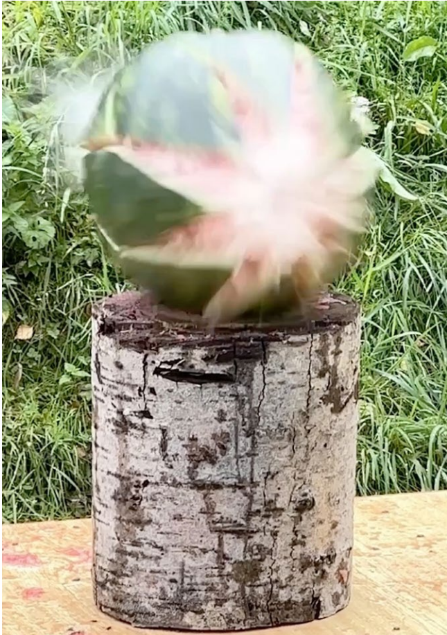
Eine völlig andere Wirkung zeigt die 10mm Auto. Schon beim Eindringen verrichtet das expansionsfreudige XTP-Projektile brachiale Arbeit. Der Melonenkörper wird anfangs sogar relativ gleichmäßig in neun, fast identische Stücke geteilt
