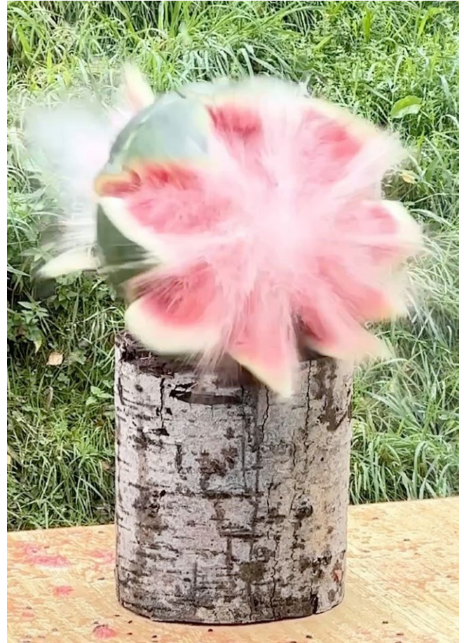
Eine völlig andere Wirkung zeigt die 10mm Auto. Schon beim Eindringen verrichtet das expansionsfreudige XTP-Projektile brachiale Arbeit. Der Melonenkörper wird anfangs sogar relativ gleichmäßig in neun, fast identische Stücke geteilt
