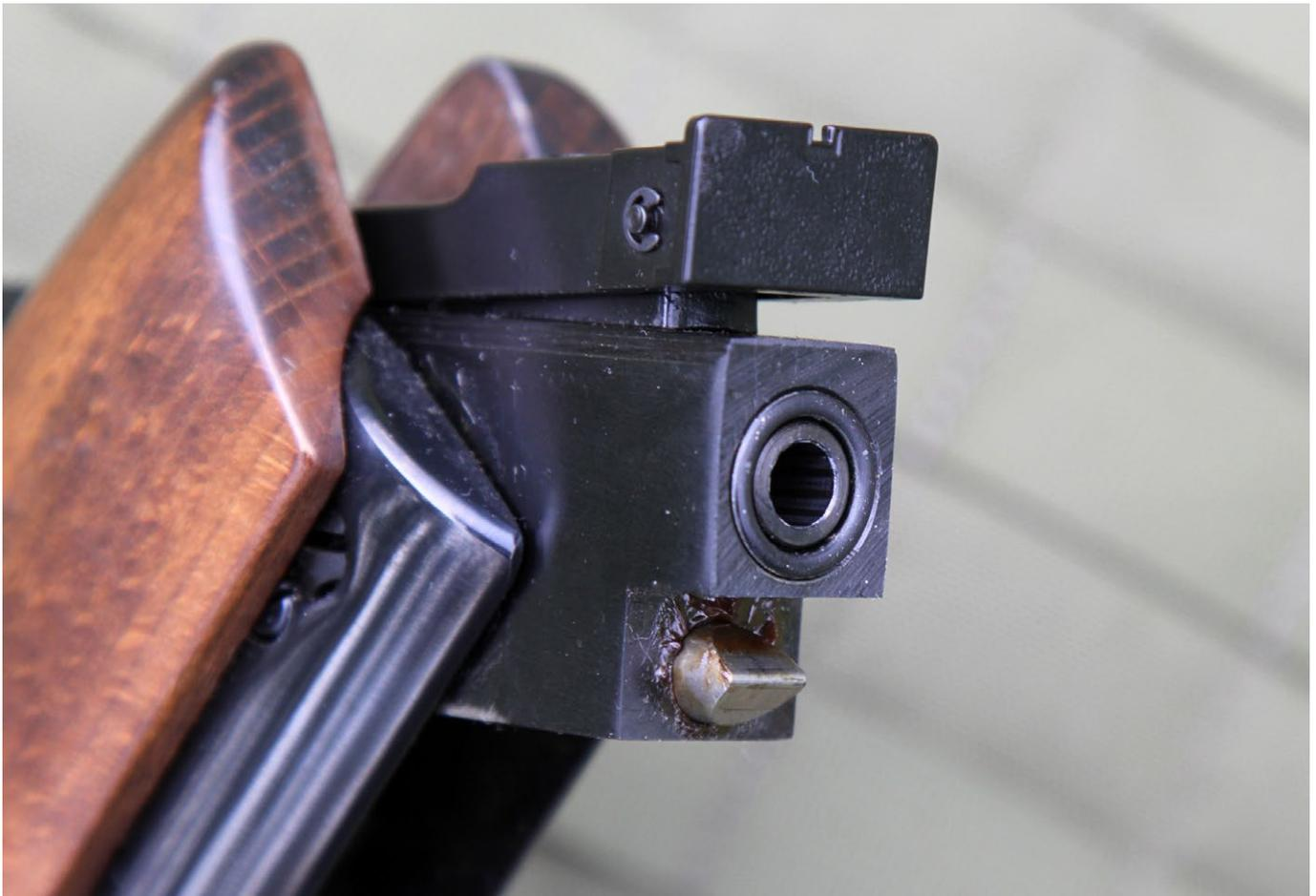
Der Lauf verriegelt über einen federbelasteten Keilverschluss. Auffällig ist die extrem hohe Verarbeitungsqualität
