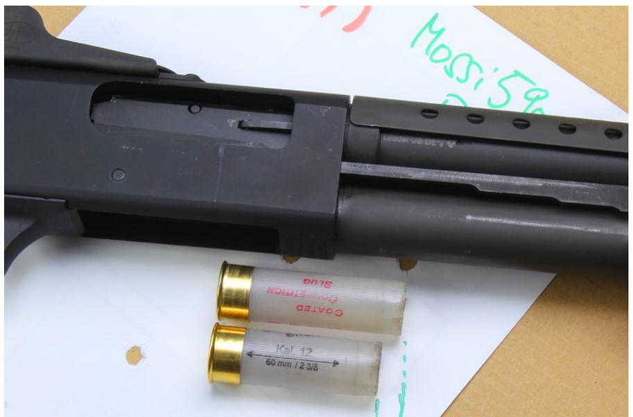
Werden permanent kurze Laborierungen von 12/60 oder 12/65 verschossen, kann es bei längeren Kartuschen zu verklemmten Hülsen kommen
