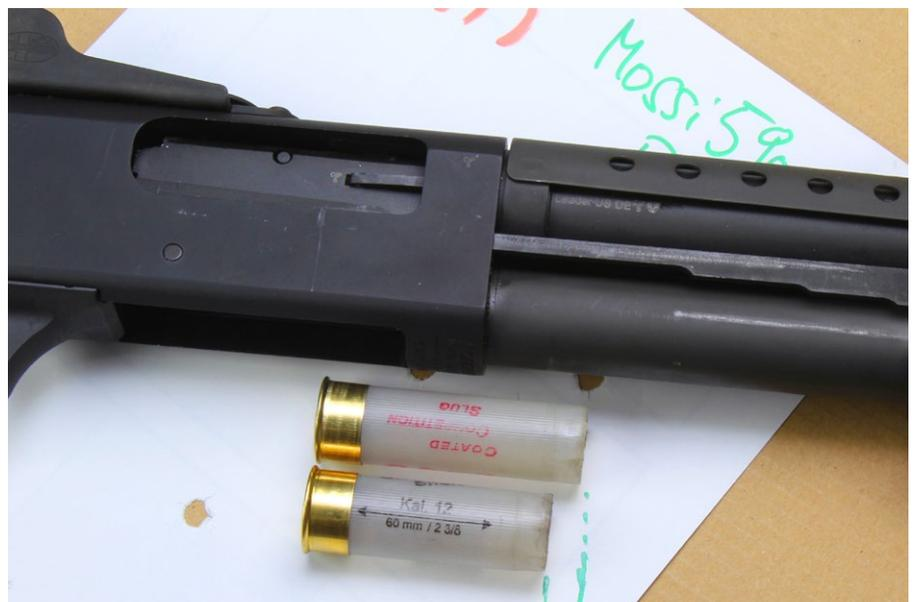
Werden permanent kurze Laborierungen von 12/60 oder 12/65 verschossen, kann es bei längeren Kartuschen zu verklemten Hülsen kommen
