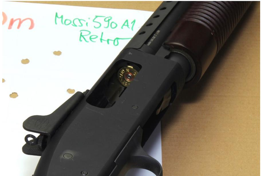
Hat sich die Hülse verklemmt, sollte ein Reinigungsstock zum Ausstoßen zur Hand sein und das Patronenlager im Nachgang gereinigt werden
