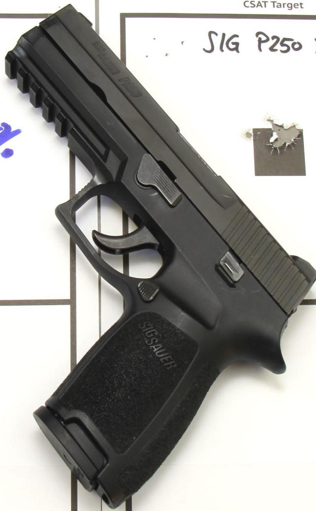
Die SIG Sauer P250 ist eine typische Double Action Only Pistole mit einer hervorragenden Abzugscharakteristik
