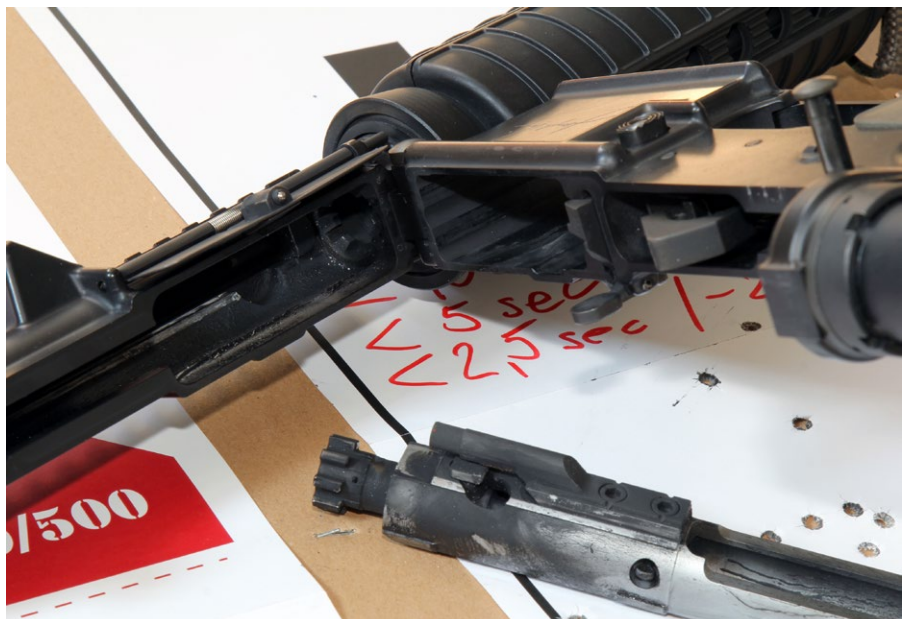
Das Obergehäuse ist innen sichtbar verschmutzt. Die Schussbelastung dürfte hier deutlich über 500 Schuss liegen
