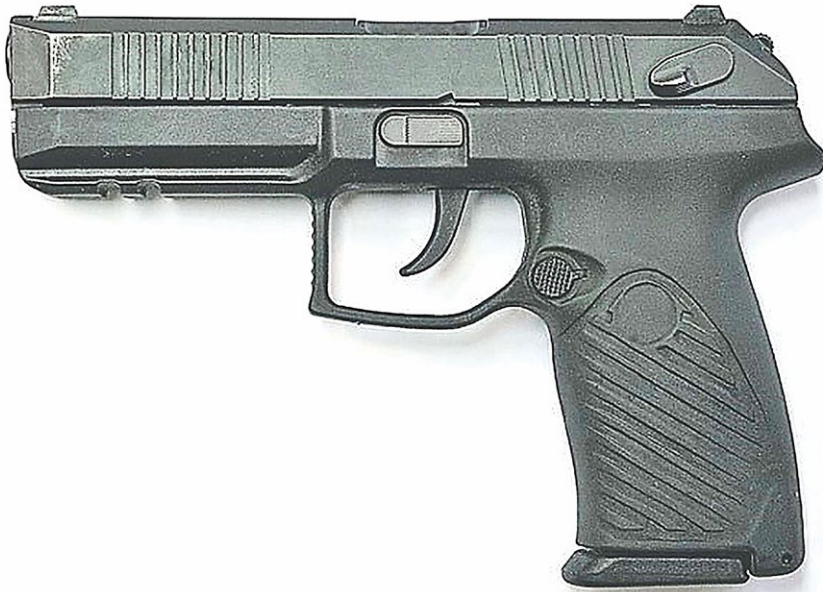
Die Pistole UdaW im Kaliber 9 x 21 Millimeter besitzt ein Polymer-Griffstück
