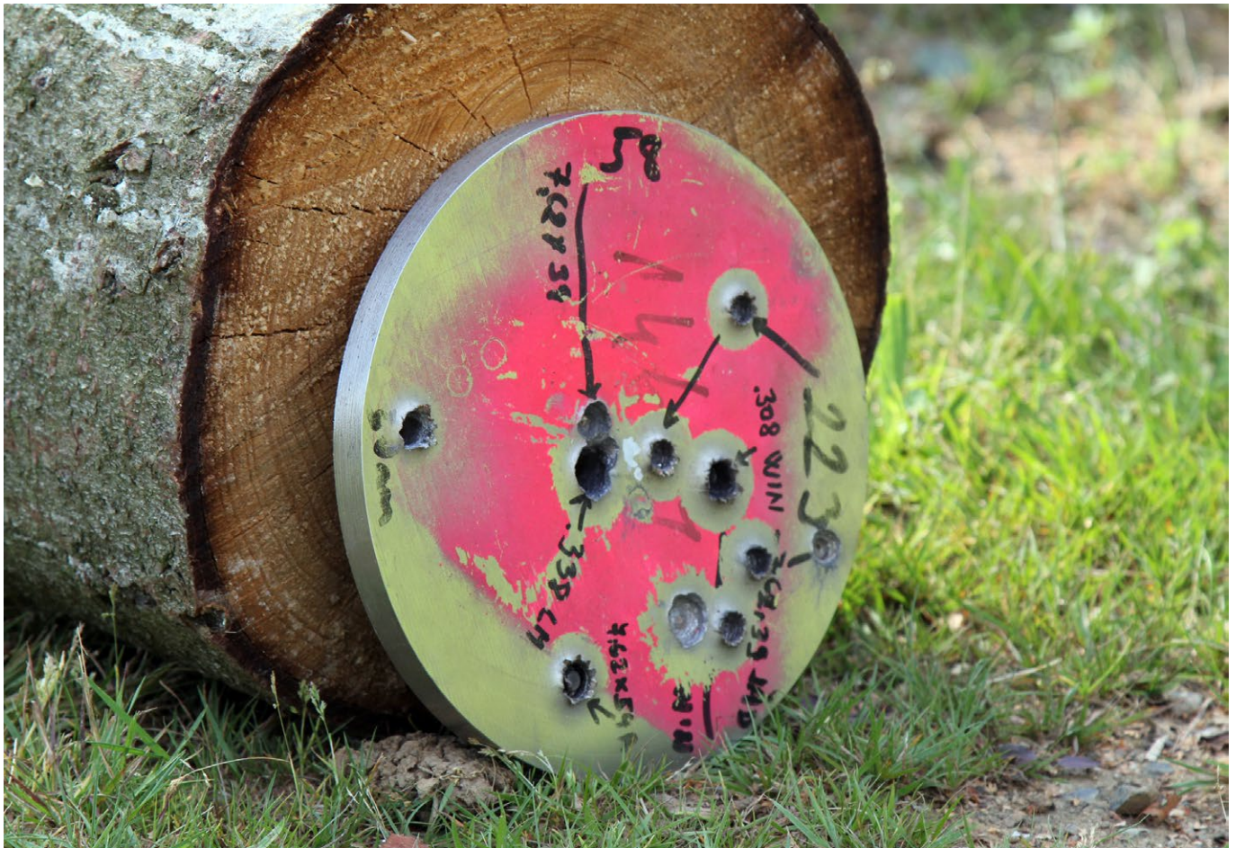
Baustahl der Güte S235 stellt für die 300PRC kein Hindernis dar. Einige andere und wesentlich weniger leistungsstarke Kaliber allerdings auch nicht, wie aus der Geschichte des Stahlgongs hervorgeht
