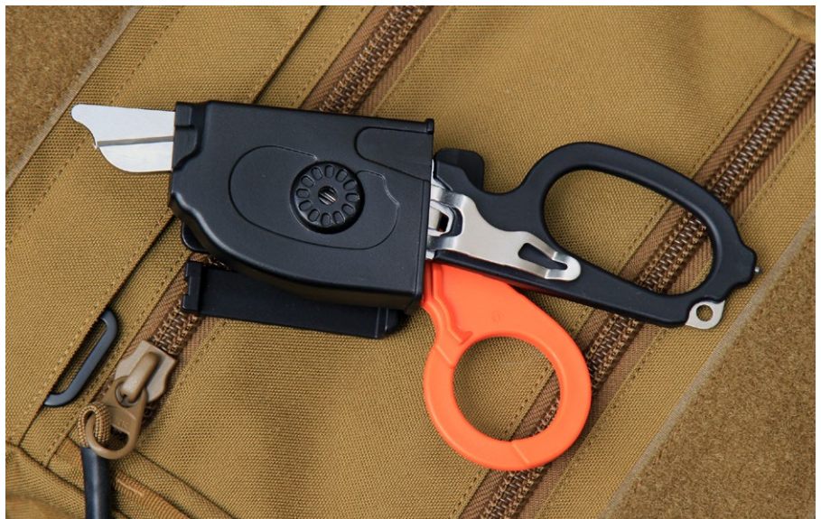
Die Faltschere kann auch ungefalted und somit einsatzbereit im Kydex-Holster getragen werden. Am unteren Ende des schwarzen Griffs ist der Glasbrecher zu sehen
