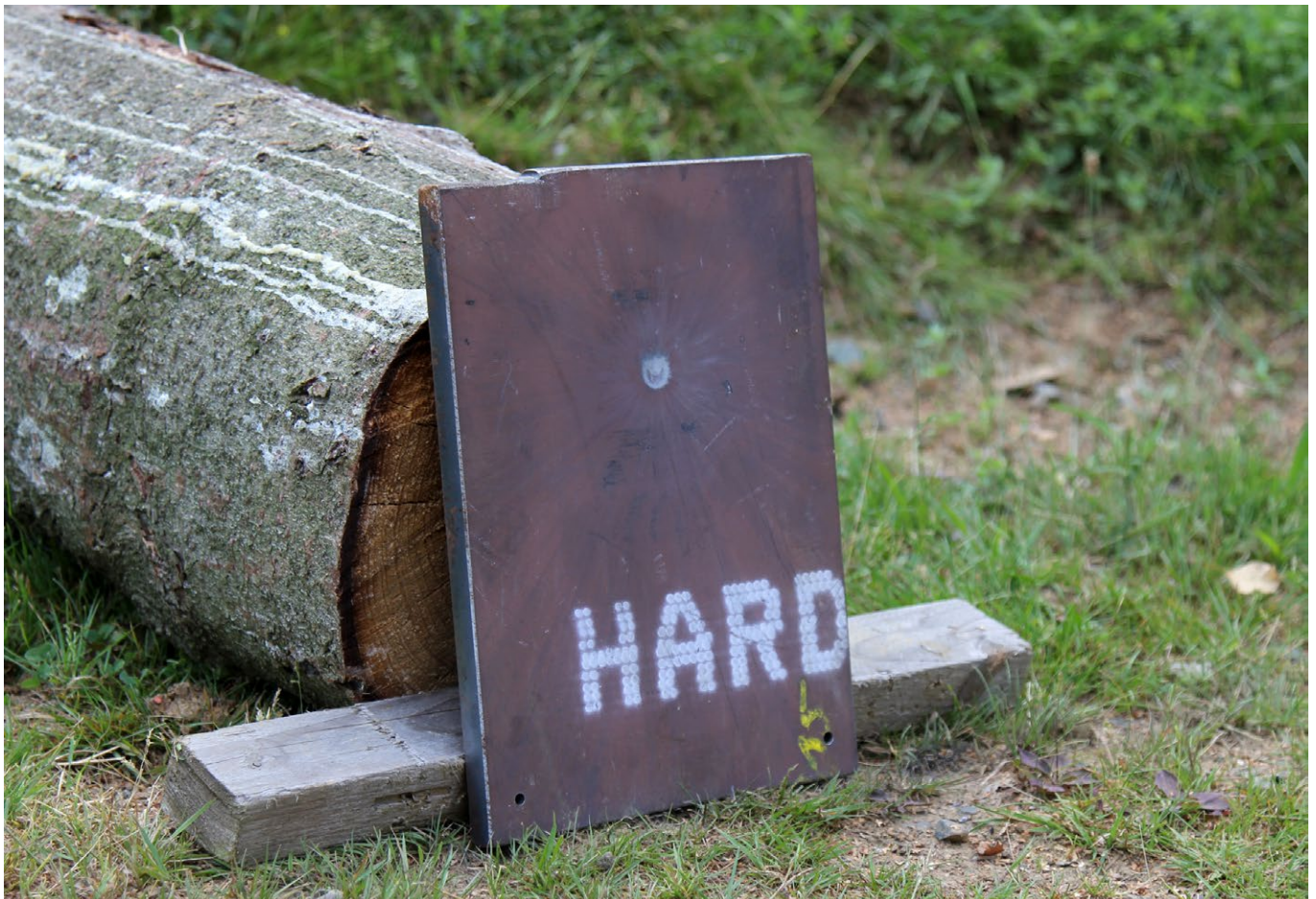
Die Hardox-400-Platte nach dem Treffer ist unbeschädigt. Der Bleiabdruck, den das Projektil auf der Platte hinterlassen hat, lässt sich mit dem Daumen wegwischen
