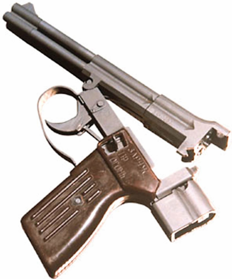
Die Unterwasser-Pistole SPP-1M verschießt Spezialpatronen 4,5x39 mm R SPS mit pfeilartigen Geschossen (Bild: warfare.be)
