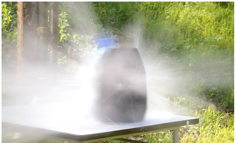
Die VPAM9 hält das Geschoss auf. Der Wasserkanister zerplatzt aufgrund der Traumattiefe (back face signature) von annähernd Faustgröße
