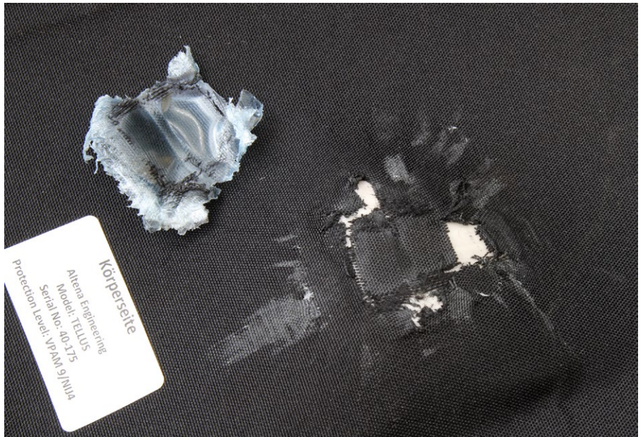
Dieses Stück Kunststoff von vier mal fünf Zentimetern wurde durch das stumpfe Trauma der Back-Face-Signatur aus dem Kanister gestanzt
