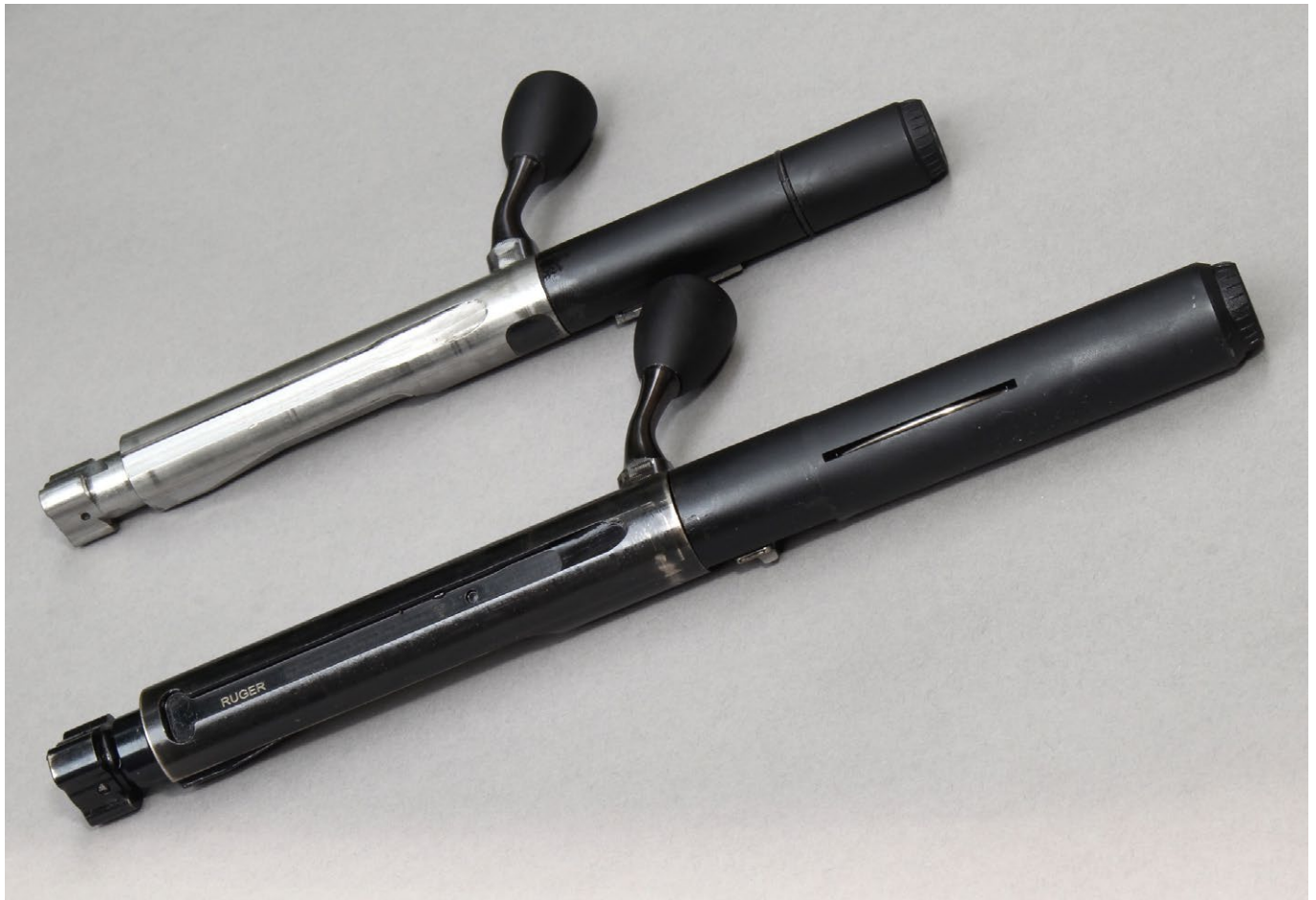
Kaliberbedingt ist der Verschluss größer dimensioniert. Der 300PRC Verschluss wiegt 550 Gramm
