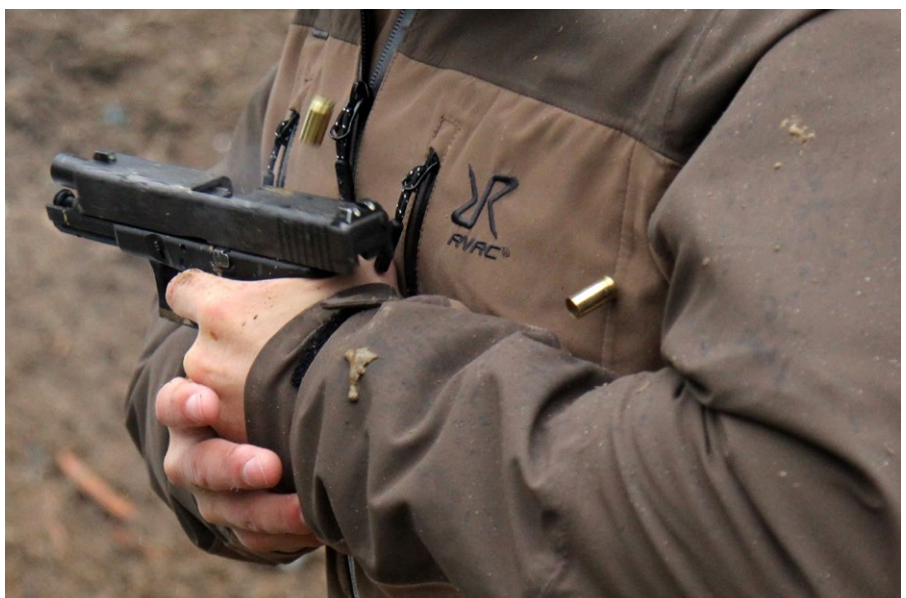
Schlamm am und im Verschluss führte teils zu Waffenstörungen
