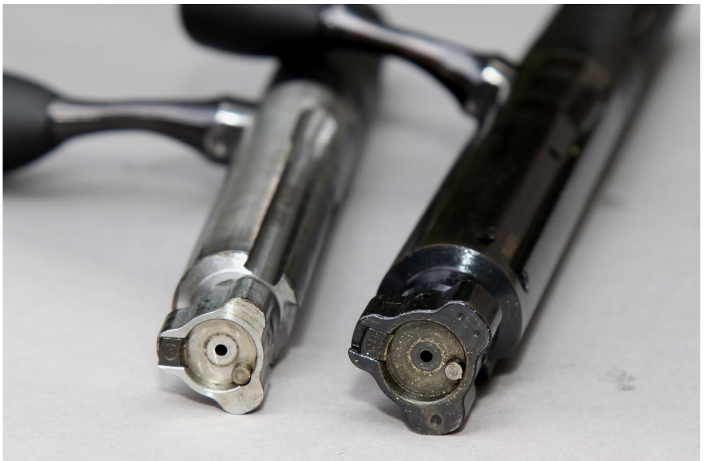
Auch der Verschlusskopf ist größer. Er hat wesentlich mehr Verriegelungsarbeit zu leisten, als im Kaliber .308 Win
