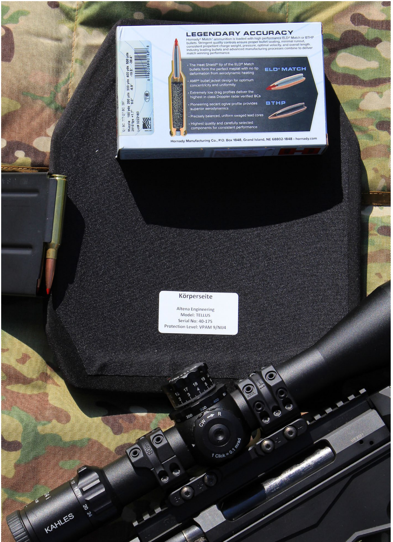
Objekt, Wirkmittel und Werkzeug: Tellus Schutzplatte des Herstellers Altena Engineering mit Protection Level VPAM9, eine 300PRC mit 225 gr. und etwa 6.000 Joule sowie die Ruger Precision Rifle
