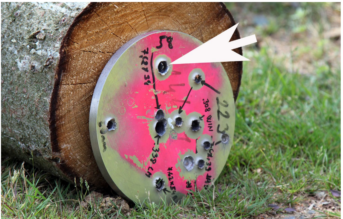
Baustahl der Güte S235 stellt für die 300PRC kein Hindernis dar. Einige andere und wesentlich weniger leistungsstarke Kaliber allerdings auch nicht, wie aus der Geschichte des Stahlgongs hervorgeht
