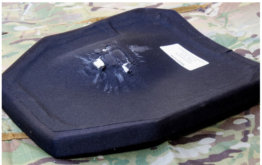
Die Back-Face-Signatur nach dem Treffer. Etwa 35 Millimeter tief und etwa zwölf Zentimeter im Durchmesser. Vermutlich wäre der Treffer letal gewesen
