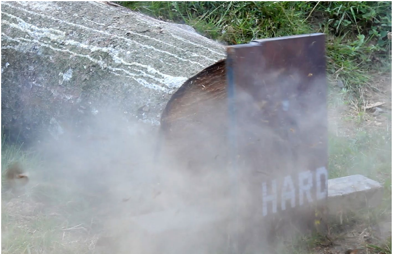
Die Hardox-400-Platte zum Zeitpunkt des Treffers. Am linken Bildrand fliegt ein Stück des Geschossmantels
