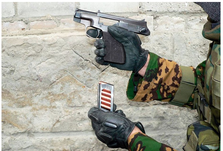
Das Magazin fasst sechs Patronen des ungewöhnlichen Kalibers 7,62x42 mm SP.4 (Bild: topwar.ru)
