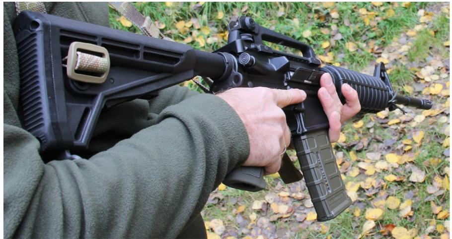
Mit den Fingern der linken Hand wird die Staubschutzklappe geschlossen.
