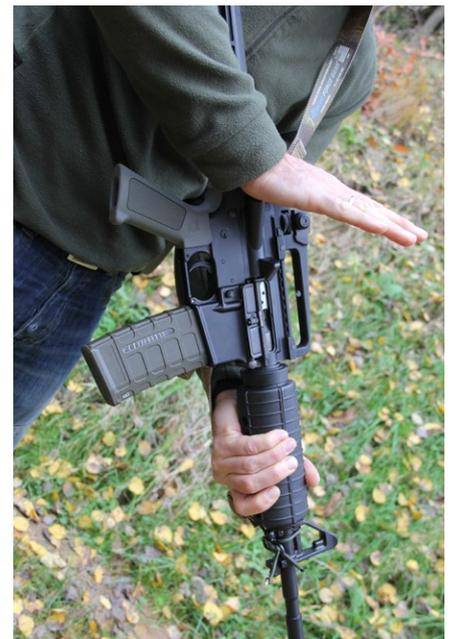
Spanschieber und Verschluss werden mittels Federkraft wieder nach vorn gebracht. Zusätzlich betätigt der Schütze die Schließhilfe (forward assist) mit dem Hand- bzw. Daumenballen der rechten Hand, um die korrekte Verriegelung des Verschlusses sicherzustellen.
