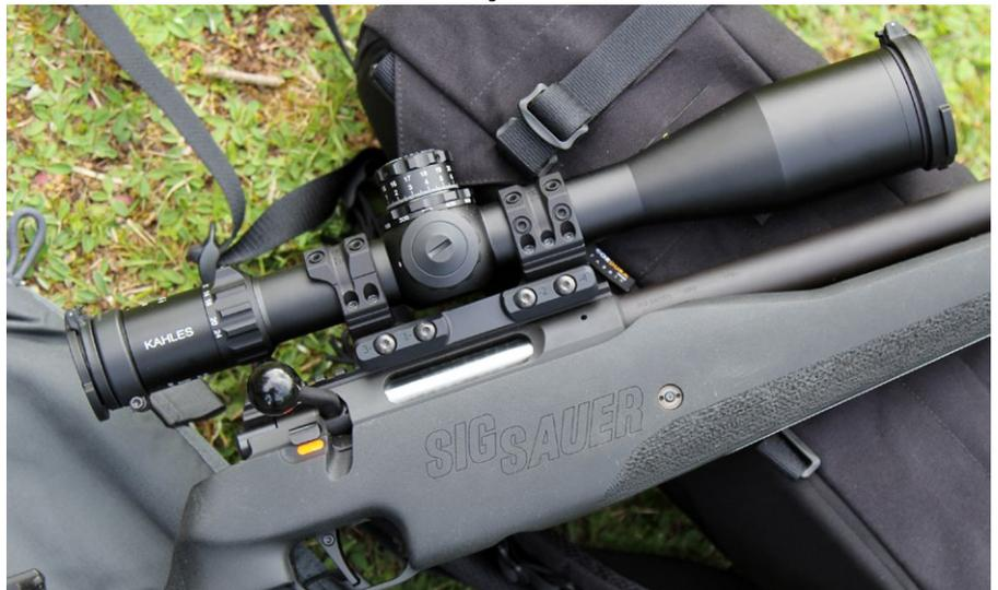
Die Einzelkomponenten dieser Konfiguration sind von Gewehr über die ZF-Montage bis hin zum ZF sehr hochwertig. Allerdings baut diese Blockmontage das ZF zu hoch. Zwischen Objektiv und Lauf würde die flache Hand passen. Diese Montage sollte zwingend ausgetauscht werden
