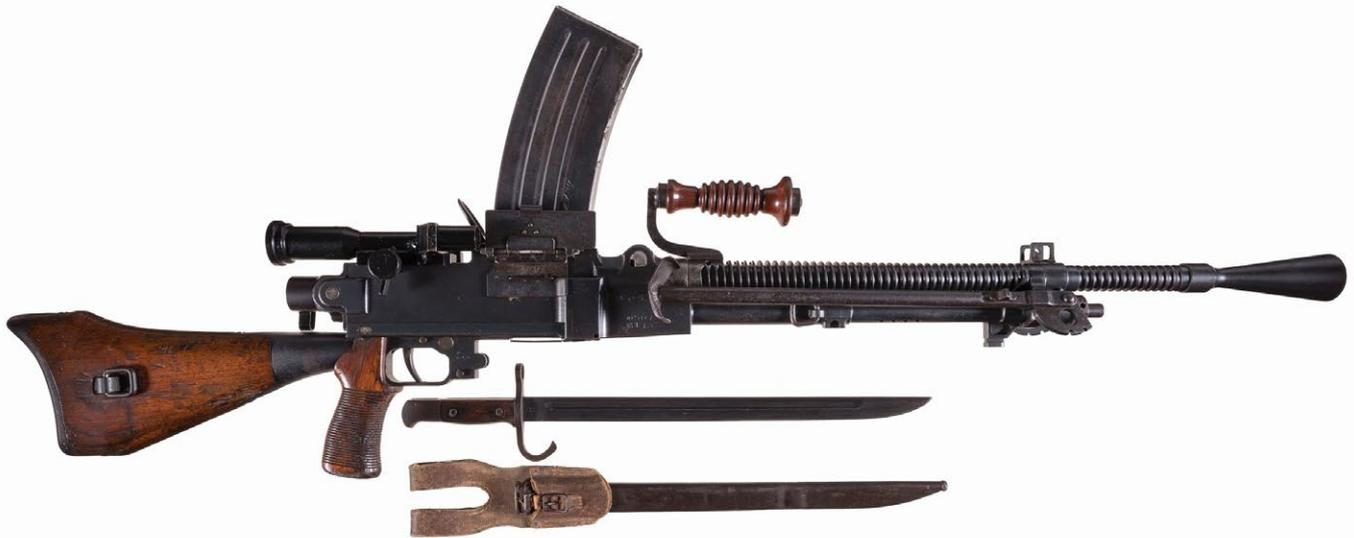
Auch wenn das Typ 99 äußerlich dem BREN ähnelt, handelt es sich um eine komplett eigenständige Entwicklung. Die Kühlrippen vergrößerten die Lauberfläche und verzögerten damit das Heißschießen des Rohres. Unterhalb des Magazins ist die automatische Staubschutzklappe erkennbar. Auch der Magazinschacht verfügt über eine entsprechend federgelagerte Schutzklappe. (Foto: Rock Island Auctions)
