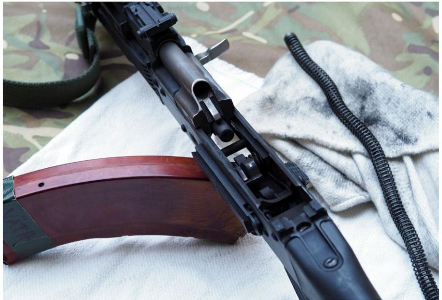
Eine dicke Schmauchschicht liegt über der Abzugseinheit und dem hinteren Teil der Schließfeder. Gerade die Übungsmunition hat hier für einen Großteil der Verschmutzung gesorgt und fast das gesamte Schmiermittel aus dem System geblasen
