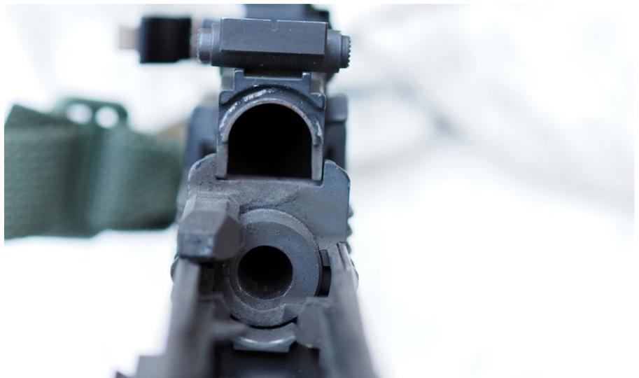
Dicke Ablagerungen um das Patronenlager und das Gasrohr. Am oberen Rand des Gasrohreintritts ist leichter Rost erkennbar
