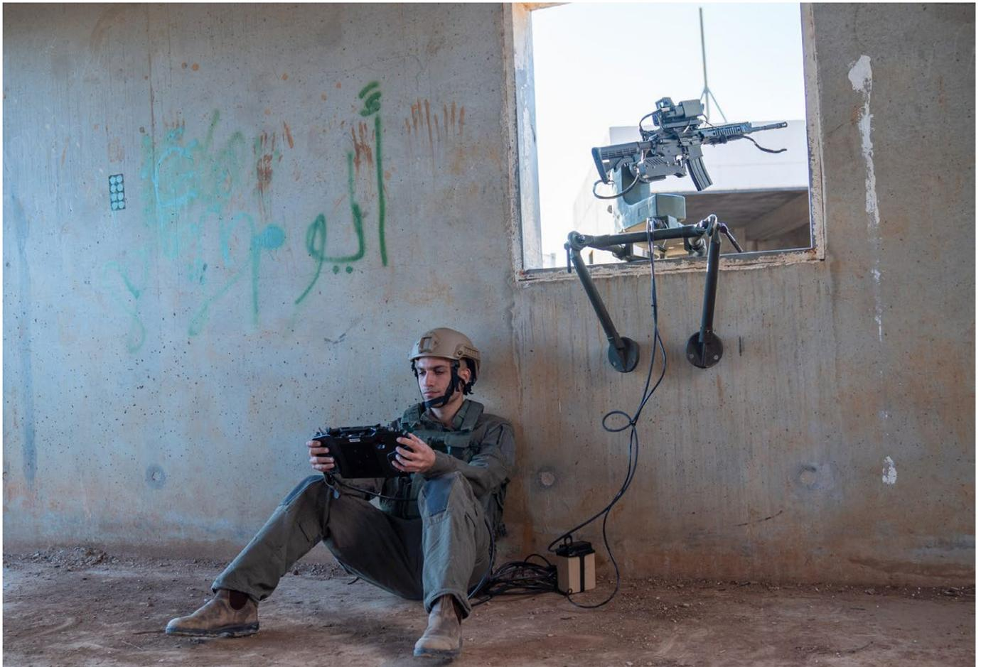
Das Lafettensystem SMASH HOPPER bei der Erprobung durch die israelischen Streitkräfte. Es kann jede Schützenwaffe, egal ob Sturmgewehr, Maschinengewehr oder Panzerfaust mit wenigen Handgriffen verbaut werden. Das System befindet sich gerade in Gaza im Kampfeinsatz (Foto: Smartshooter)
