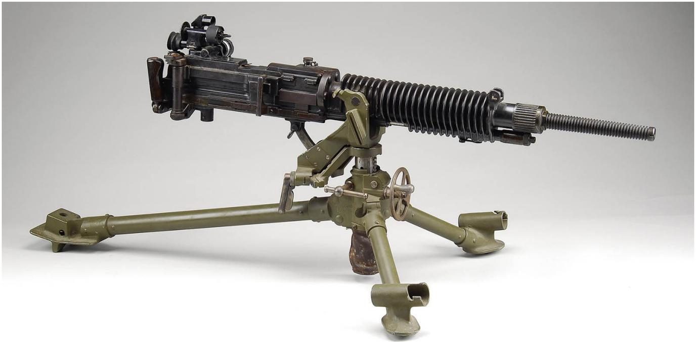
Japanisches Type 92 Maschinengewehr im Kaliber 7,7 x 58 Millimeter. Die Kühlrippen dieser Waffe verraten den ursprünglichen Hotchkiss-Entwurf, den die japanischen Streitkräfte bereits Anfang des Jahrhunderts einführt. Auf der gegenüberliegenden Seite ist die Periskop Optik erkennbar. Eine massive, sehr zuverlässige Waffe (Foto: Rock Island Auctions)
