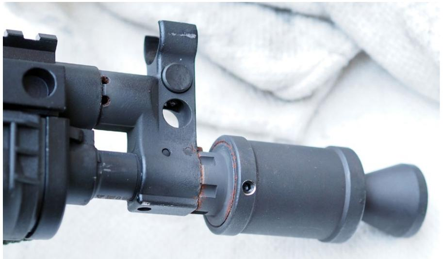
Die Bohrungen der Gasabnahme sowie das Mündungsgewinde waren von Flugrost betroffen. Die Oberflächenbearbeitung des Mündungsfeuerdämpfers zeigte hier leichte Schwächen, was für die Funktion allerdings völlig unbedenklich ist
