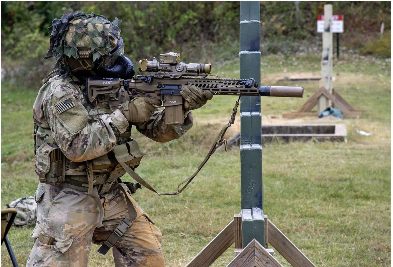
Das neue Sturmgewehr XM7 ist eine Weiterentwicklung des MCX Spear. Der Kurzhub-Gasdrucklader wiegt mit Signaturverzerrer ungeladen 4,46 Kilogramm. Bei den Magazinen handelt es sich um bereits eingeführte Varianten (für das SR-25) mit 20 oder 25 Patronen. Der „Block“ auf dem Vortex XM-157 ist der abnehmbare Laserentfernungsmesser und Umweltdatenrechner (Foto: United States Army)
