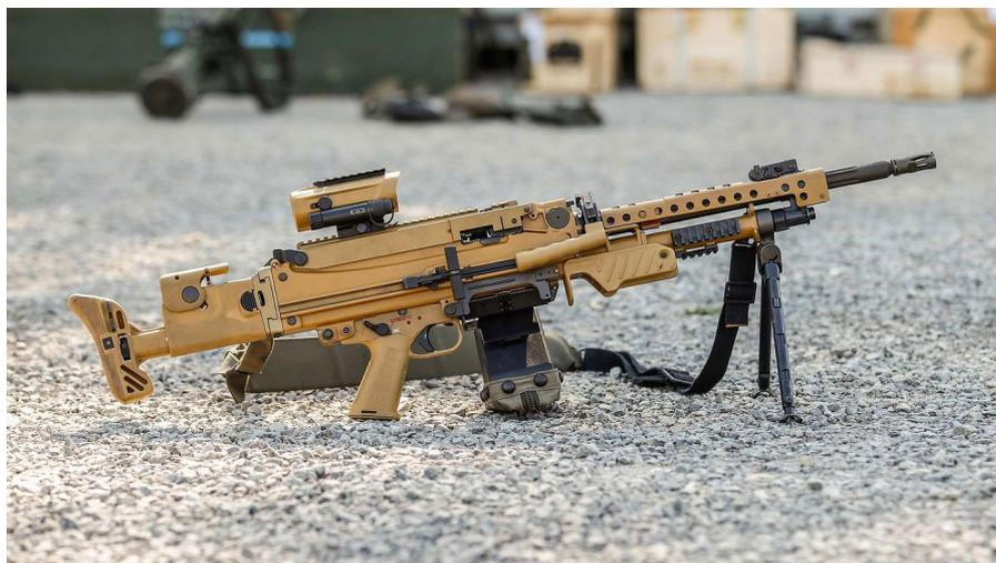
Das Maschinengewehr MG5 hat das MG3 bei den abgesessenen Kampftruppen der Bundeswehr ersetzt. Es ist leichter, ergonomischer und einfacher zu schießen, verfügt allerdings nicht über die legendäre Unzerstörbarkeit des MG3. Als Einheitsoptik wird das ZO 4x30 von Hensoldt mit verhältnismäßig breitem Sehfeld verwendet. Diese Waffe ist ein gutes Beispiel für die vermutlich letzte Generation traditioneller Maschinengewehre (Foto: Bundeswehr)
