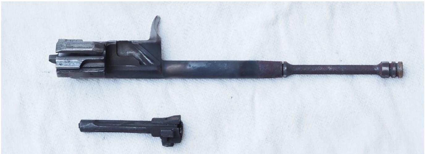
Der Verschlussträger mit fest verbautem Gaskolben war besonders betroffen: Während sich die Verschmutzung in Grenzen hielt, ist der Rost in der vorderen Hälfte deutlich zu sehen. Die Entfernung verlief erstaunlich schnell und ohne sichtbare Beschädigungen
