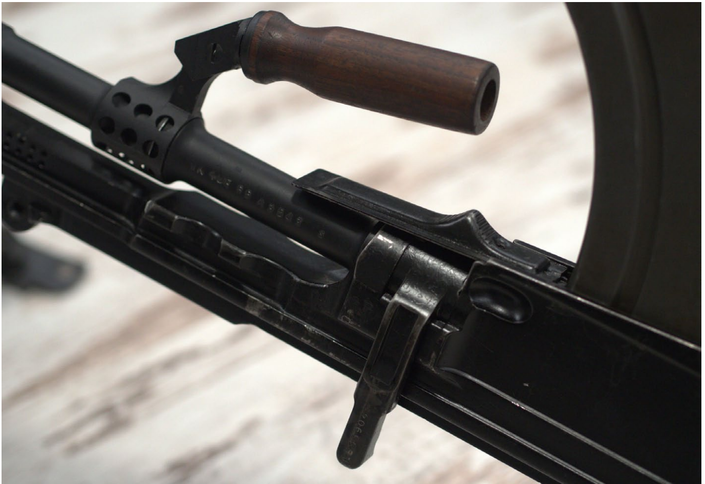
Der Tragegriff am Lauf ließ sich in drei Stellungen arretieren. Auf dieser Aufnahme befindet er sich oben in der Trage- beziehungsweise Laufwechselposition. Während dem Schießen wurde er nach links abgeklappt. Für Fliegerabwehrfeuer oder zum Schießen aus der Hüfte, konnte der Holzgriff dann separat nach vorne rotiert werden und fand sein Gegenlager in einer Rille am Gehäuse. Hier ist vor dem eingesetzten Magazin auch die schiebbare Staubschutzklappe gut zu sehen (Foto: Autor)
