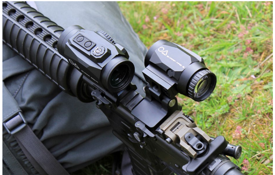
Vergrößerungsmodul weggeklappt. Durch die Schnellspannmontage ist der Abbau nach dem Einschießprozess ohne Werkzeug machbar. Die Helligkeit des Rotpunkts kann über die zwei Pfeiltasten korrigiert werden
