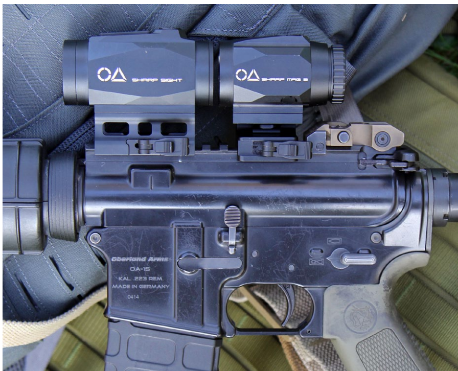
In der letzten Ausbaustufe wird das Black Label M4 mit dem neuen Rotpunktvisier von Oberland Arms OA Sharp und einem 3-fach Vergrößerungsmodul eingesetzt. Naturgemäß trägt die Waffe inzwischen deutliche Gebrauchsspuren
