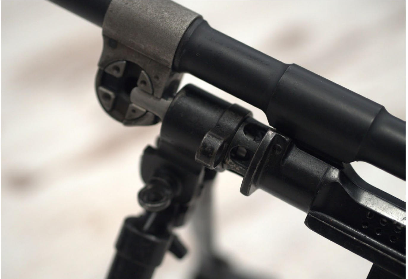
In der Variante Mk. III wurde nur noch die verstellbare Gasabnahme in Edelstahl ausgeführt. Klar erkennbar sind die vier Positionen. Zur Verstellung musste der rechts liegende zweite Maschinengewehrschütze den Lauf entnehmen, den Regler in Position drehen und den Lauf wieder einsetzen. (Foto: Autor)
