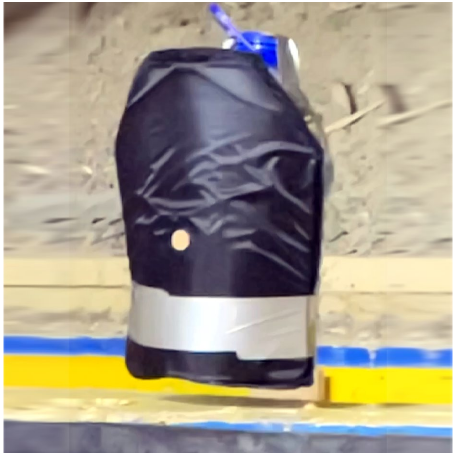
Beim Auftreffen des Projektils sprang der 5-Liter-Wasserkarner etwa handbreit nach oben
