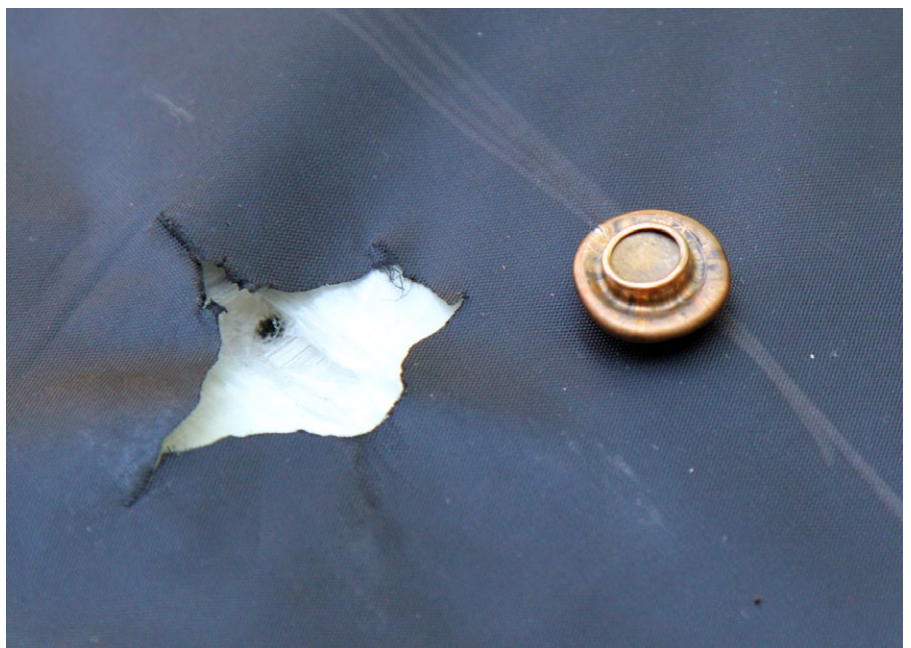
Bei einhundert Prozent Energieabgabe in der Einlage deformierte das Vollmantelgeschoss lehrbuchmäßig
