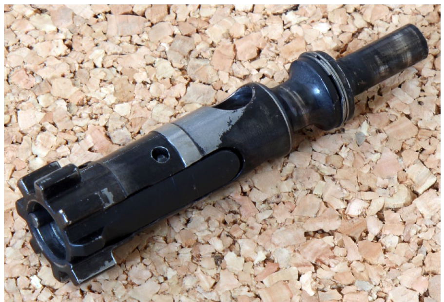
Nach etwa 3.000 Schuss wurden die Gasringe getauscht. Ein Gasring war gebrochen
