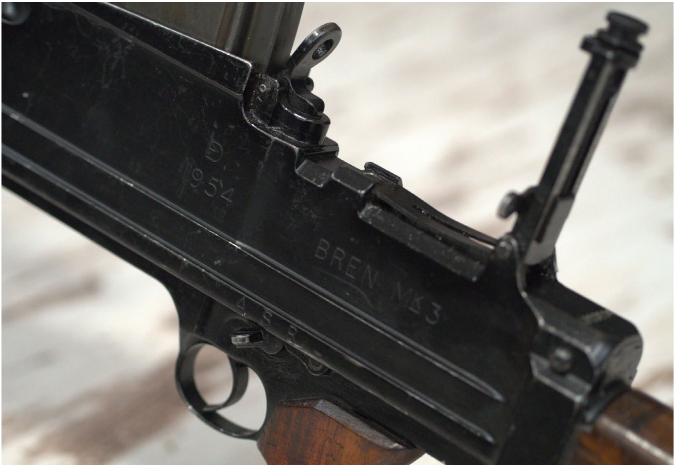
Auf dieser Nahaufnahme eines Bren Mk. III ist gut der Feuerwahlhebel mit seinen drei Positionen zu erkennen: A für „Automatic“, S für „Safe“ und R für „Repetition“, sprich halbautomatisches Feuer. Die Waffe im Bild ist entschert und bereit für vollautomatisches Feuer. Der oben sichtbare Magazinlösehebel lässt sich intuitiv bedienen, indem man das Magazin inklusive Hebel mit der Hand greift. (Foto: Autor)
