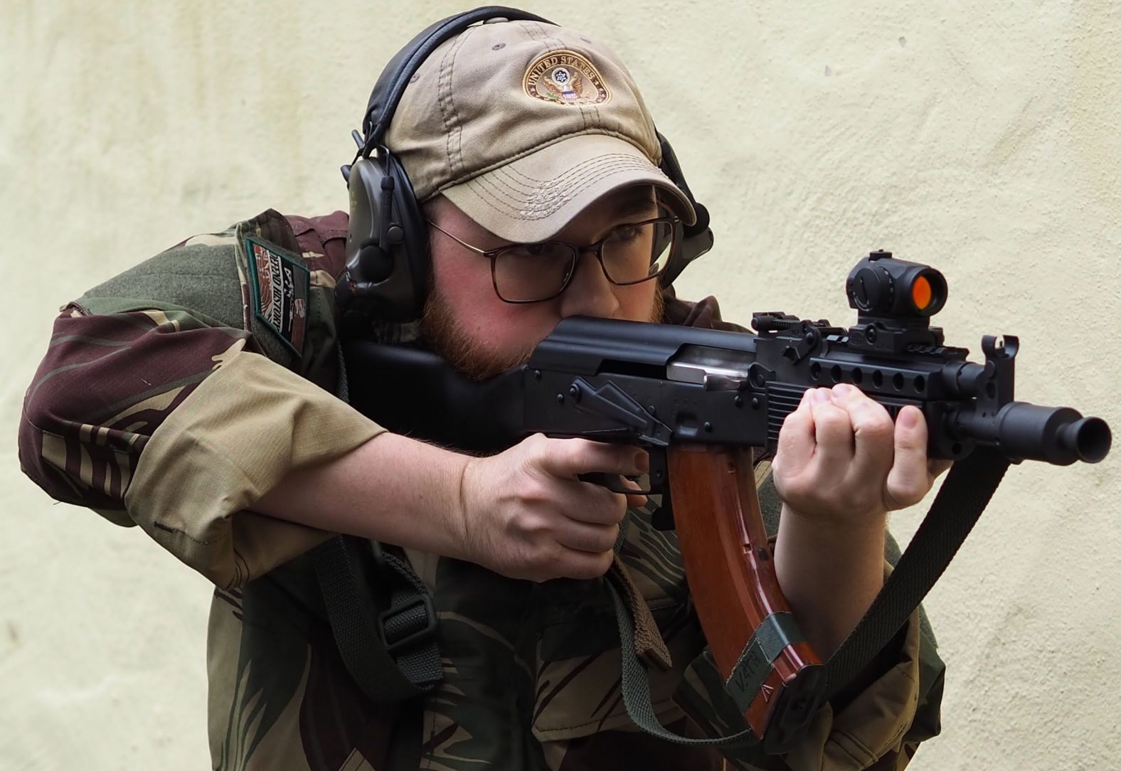
Der Autor im Stehendanschlag mit der Testwaffe: Der Handschutz mit Schienen wurde durch die Standardausführung aus Kunststoff getauscht und auf dem Gasrohr sitzt nun ein Aimpoint Micro T-1 mittels Spuhr-Montage (Foto: Autor)
