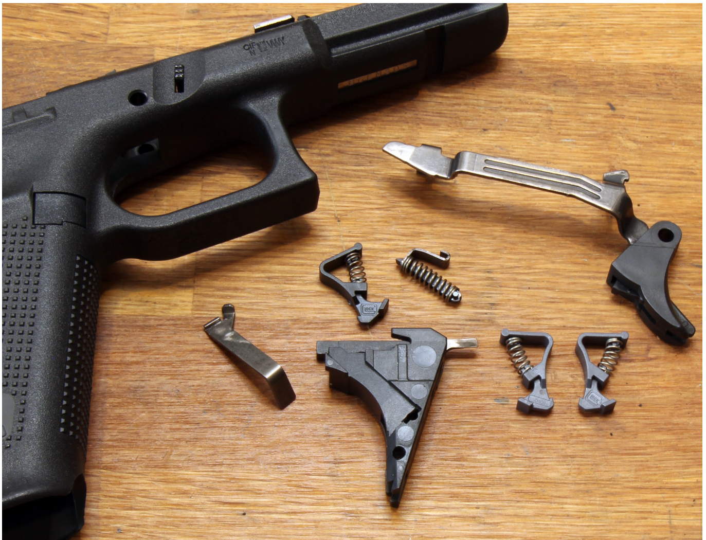
Glock-Schützen können zumindest zeitweise einen New-York Trigger mit höherem Abzugsgewicht in ihre Glock Pistole einbauen, um einen höheren Trainingseffekt zu erreichen
