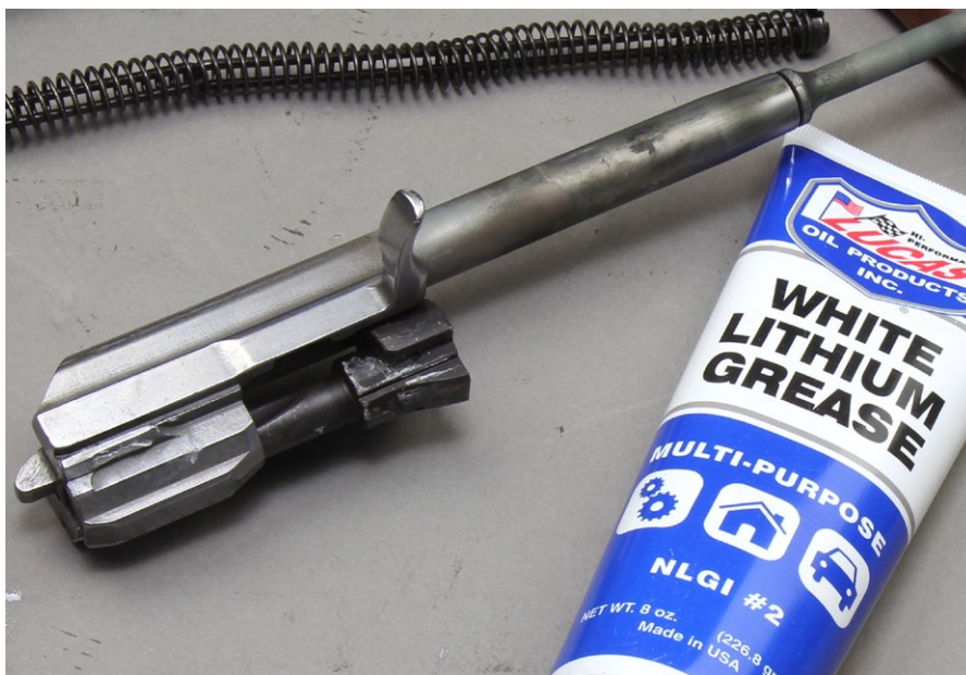
Die Schmierpunkte der AK werden mit einem weisen Mehrzweckfett versorgt, das sich außerordentlich gut bewährt hat
