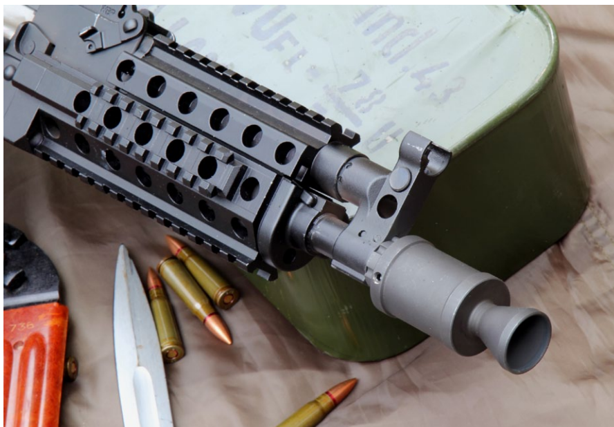
Der Handschutz mit Schienen, wie er im Auslieferungszustand verbaut war. Die Picatinny-Schienen auf drei, sechs und neun Uhr schränken den Handhabungskomfort eher ein, als einen Zusatznutzen zu erzeugen
