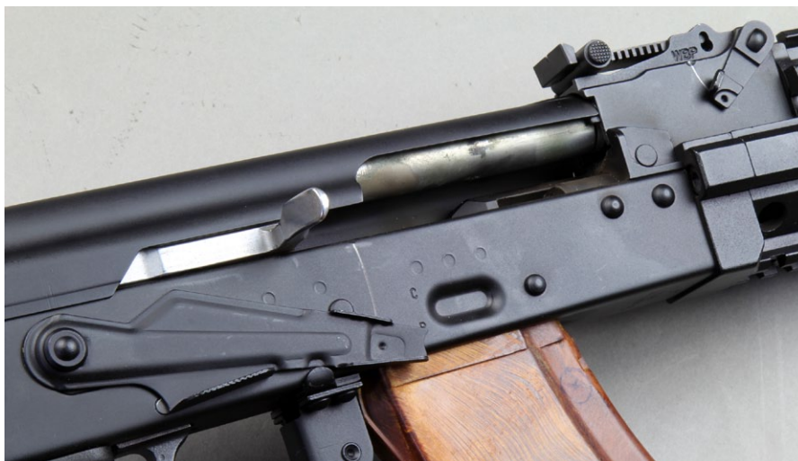
Die WBP Mini-Jack verfügt über einen Verschlussfang
