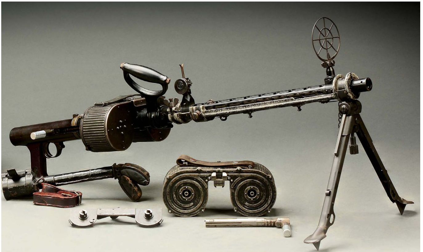
Das MG 15 wurde für den Einbau in Kampfflugzeugen entwickelt. Im Kriegsverlauf wurde es allerdings bei der Luftwaffe durch das MG 81 ersetzt. Durch einen einfachen Umrüstsatz kamen die Waffen dann vor allem bei den Bodentruppen der Luftwaffe zum Fronteinsatz: Die montierbare Schulterstütze liegt links unten und die improvisierte Natur des Außengestänges um den Lauf zur Aufnahme des Zweibeins machen diesen Umstand erkennbar (Foto: Rock Island Armory)
