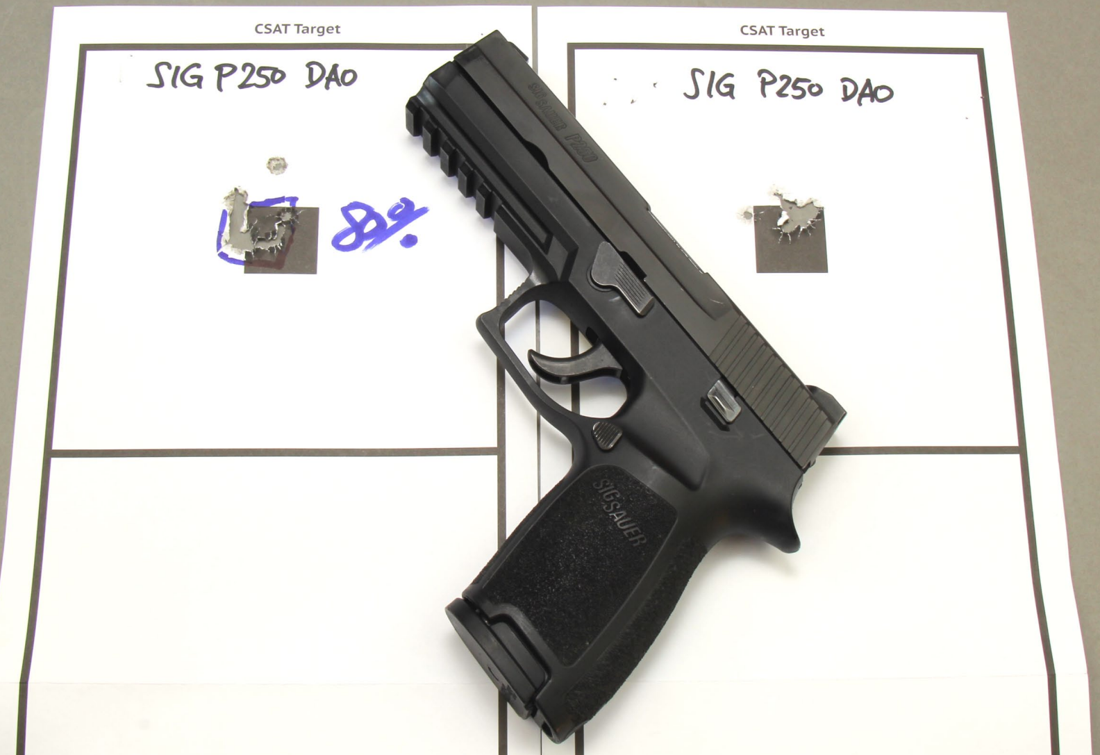
Die SIG Sauer P250 ist eine typische Double Action Only Pistole mit einer hervorragenden Abzugscharakteristik
