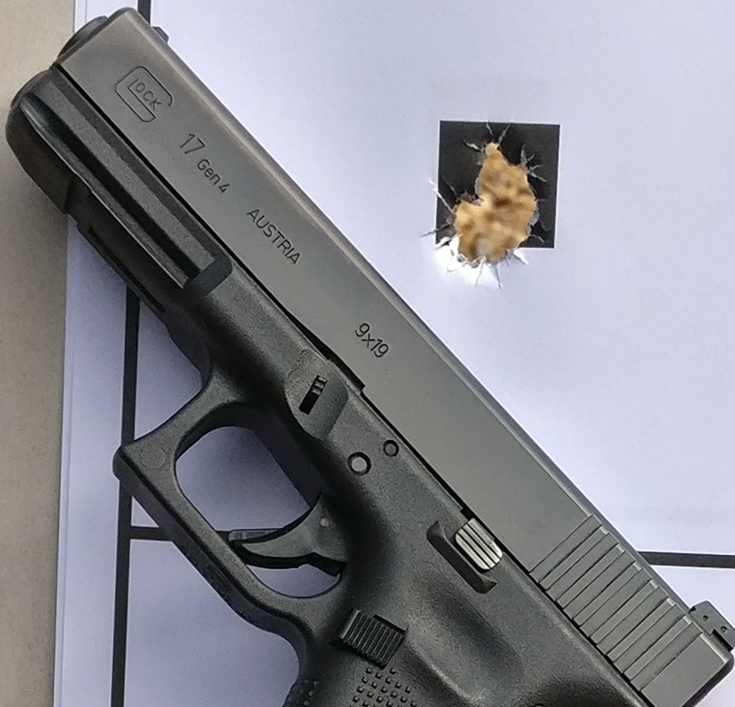
Aus fünf Metern Entfernung ist diese 10-Schuss-Gruppe deutlich kleiner als Kornbreite
