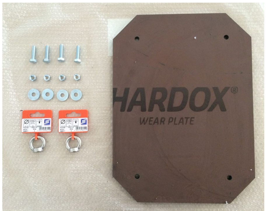
Eine Stahlplatte der Größe 25 mal 30 Zentimeter als 50-m-Ziel lässt sich selbst anfertigen. Das Material muss nicht unbedingt Hardox sein
