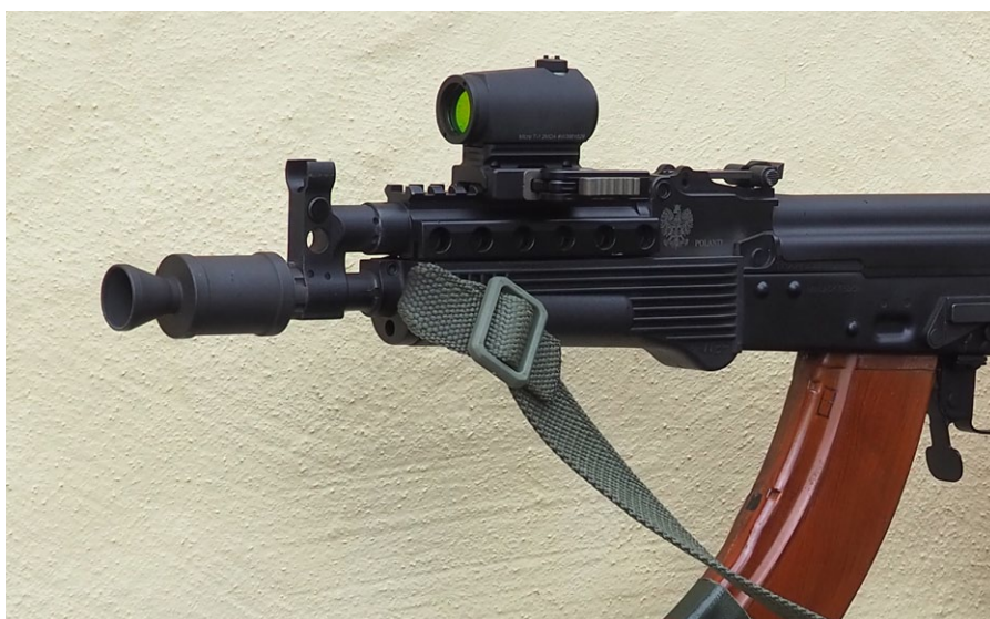
Zum schnellen Lösen des Leuchtpunktvisiers wird der hellgraue Riegel auf dem Schnellspannhebel nach hinten gezogen und der Hebel nach vorne gedrückt. Die gesamte Einheit verschwindet in einer Tasche und wird wieder montiert, sobald die Rahmenbedingungen die Nutzung zulassen. Die Position wird durch weiße Farbmarkierungen festgelegt (Foto: Autor)
