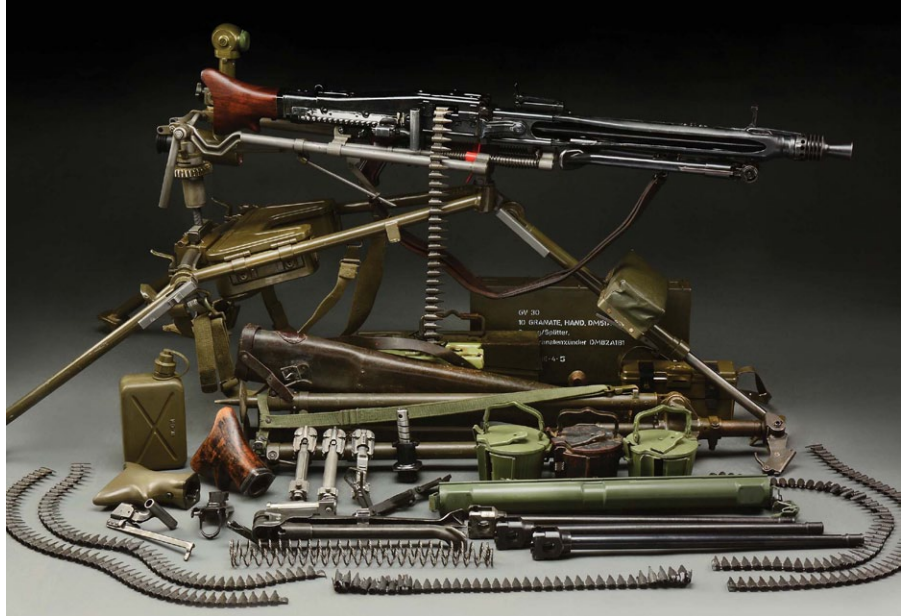
Das MG 3 ist eine direkte Weiterentwicklung des MG 42 mit geringfügigen Änderungen. Selbst die Masse des Zubehörs wie die Lafette und das Fliegerdreibein blieben nahezu unverändert. In manchen Ländern findet immer noch eine Lizenzproduktion statt, die Bundeswehr ersetzt die Waffe gerade querschnittlich durch das MG 5. (Foto: Rock Island Armory)
