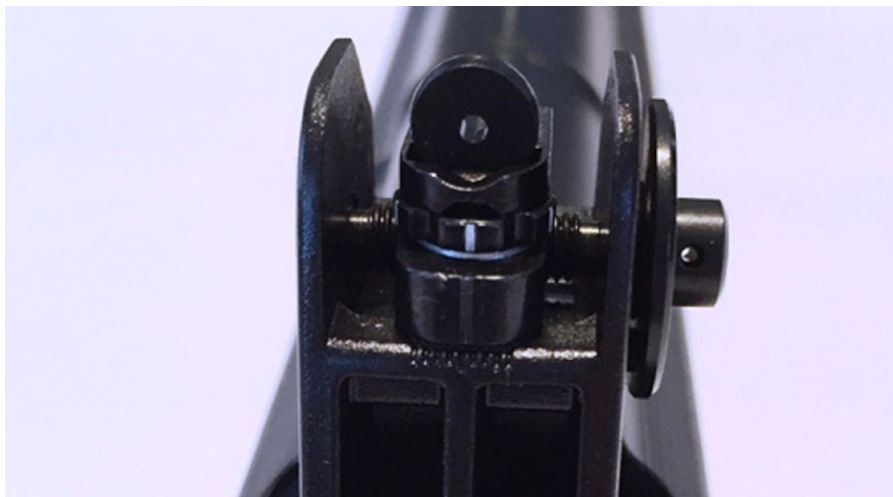
Eine AK mit AR-15-Eisenvisier: Der Hersteller Tech-Sights macht es möglich. Die verstellbare Lochkimme ist von dem modifizierten Deckel getrennt und verspricht dadurch gute Präzision ohne Einbußen in der Zerlegbarkeit. Die Visierlinienlänge einer AK-74M entspricht ziemlich genau der eines M4-Sturmgewehres und ließe sich durch diese Konfiguration drastisch erhöhen (Foto: Tech-Sights)
