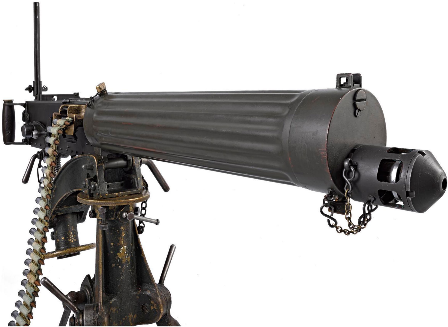
Das Vickers Mark I war vermutlich das beste schwere Maschinengewehr des ersten Weltkrieges. Etwas leichter und zuverlässiger als andere Waffen, war es auch besser für die Serienfertigung geeignet. Im Gegensatz zum deutschen MG 08 verfügte es über den verbesserten Maxim-Verschluss und komplett austauschbare Baugruppen. Die Fertigungsqualität gilt bei allen englischen Lizenzherstellern als herausragend (Foto: Royal Armouries)
