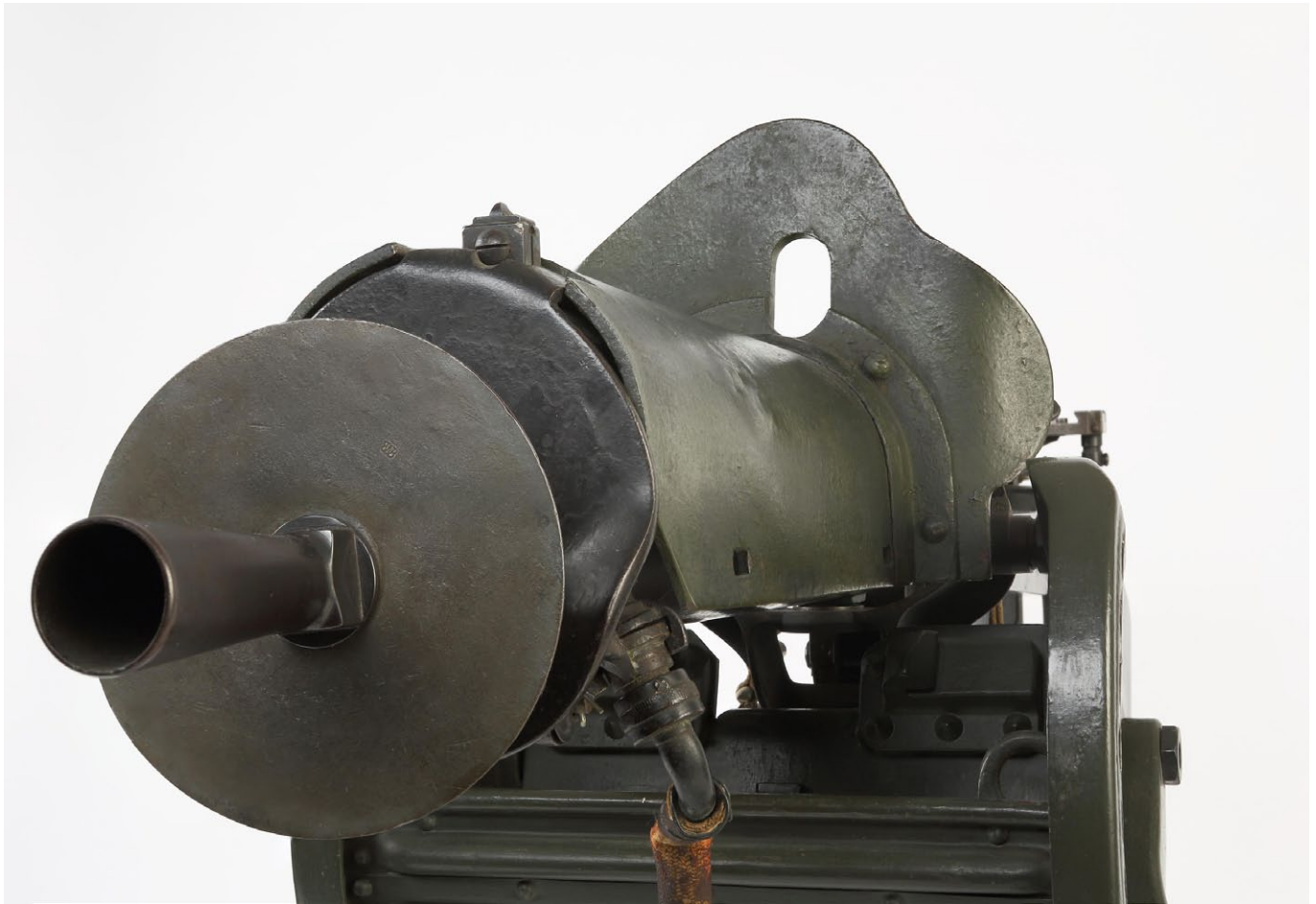
Das MG 08 lässt sich vor allem an seinem markanten Rückstoßverstärker leicht erkennen. Ab 1915 wurde der hier abgebildete Mantelpanzer für den Kühlwassermantel sowie ein Schild mit Visierausparung nachgerüstet, ebenfalls ein deutsches Erkennungsmerkmal. Die Waffe war extrem robust, aber auch sehr schwer und konnte bei Schäden nicht durch die Bediener instandgesetzt werden. (Foto: Royal Armouries)
