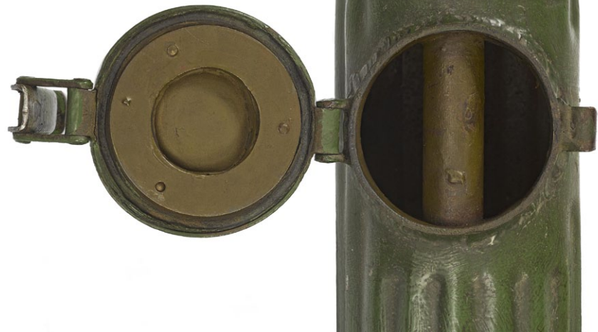
Die russischen Maxim-Maschinengewehre, PM 1910 (russ.: Pulemjot Maxima), waren auf schweren, aber effektiven Sokolow-Radlafetten montiert. Anders als bei der Wasserkühlung anderer Maxim-Waffen, verfügte das russische PM 1910 in späteren Varianten nicht über die Anschlüsse für einen Dampfschlauch, sondern einfach eine breite Öffnung. So konnte jede verfügbare Flüssigkeit, zur Not auch Urin, genutzt werden. Auch Schnee ließ sich so hineinstopfen. (Foto: Royal Armouries)
