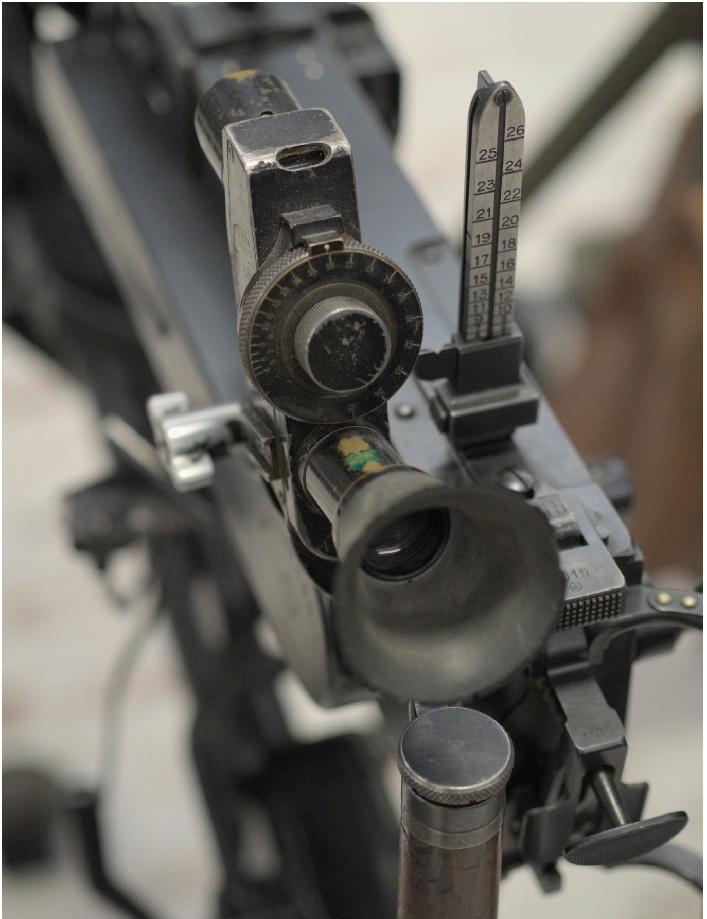
Die Nutzung von Zielfernrohren auf Maschinengewehren ist eine deutsche Erfindung. Das Zielfernrohr 12 des MG 08, hier aus der Fertigung von Carl Zeiss in Jena, verfügte über eine zweieinhalbfache Vergrößerung und einen sehr simplen Zielstachel. Die mechanische Visierung bleibt weiterhin nutzbar wie zu sehen ist. Die Optik auf diesem Foto ist auf einem MG 11 der Schweizer Armee montiert, in technischer Hinsicht ein enger Verwandter des MG 08 (Foto: Autor)
