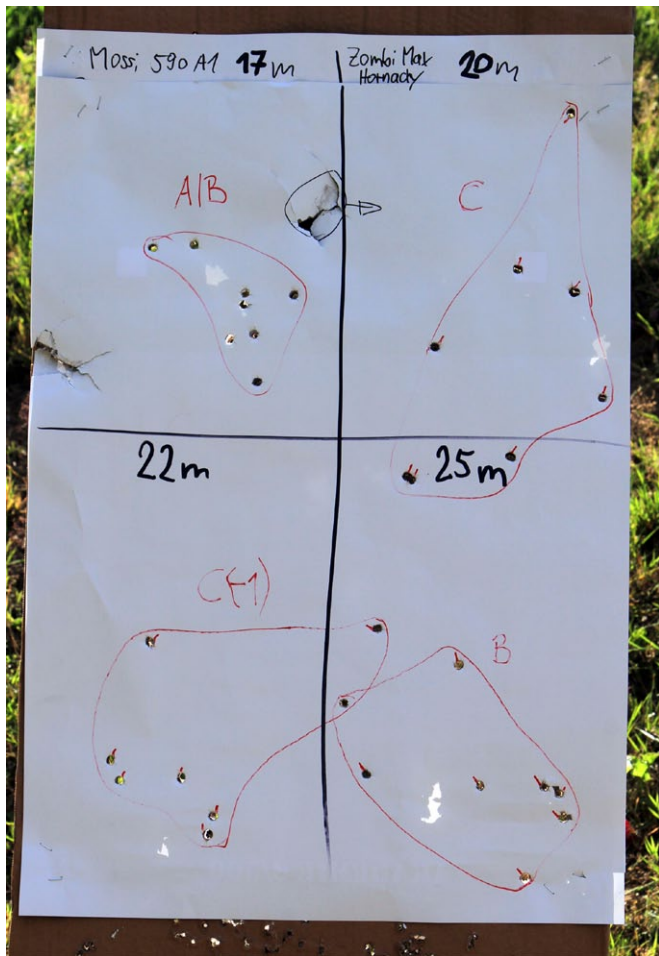
Bemerkenswert: Bei 25 Meter reduziert sich die Streuung der 590A1 wieder auf A4-Blatt Größe
