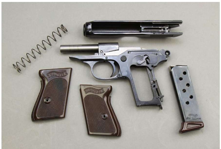
Pistolen mit unverriegeltem Feder/Masse-Verschluss gelten als robust
