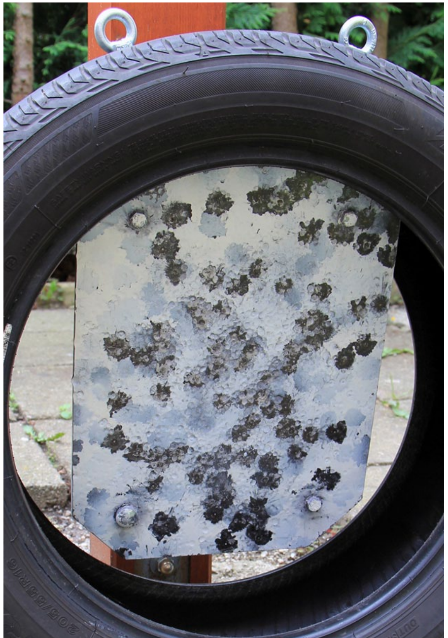
Wird das Stahlziel in einen Reifen gehängt, reduziert sich die Splitterwirkung um 95 Prozent
