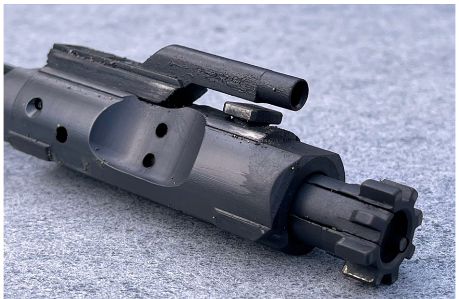
Der Verschlussträger der Gen. 1 Waffe aus dem Jahr 2019 mit immerhin 2.700 Schuss
