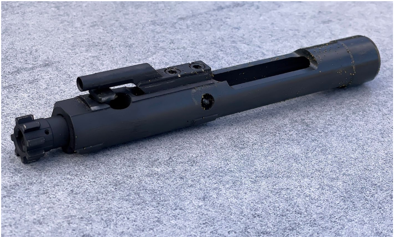
Linke Seite: Verschlusssträger der Gen. 1 Waffe nach 2.700 Schuss
