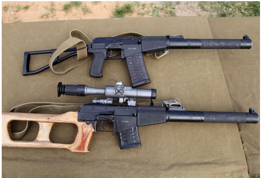
Schallgedämpfte Waffen sind in Spetsnaz-Einheiten bereits seit den 1980er Jahren weit verbreitet: Neben dem Zubehör für reguläre Sturmgewehre und Pistolen werden auch die integralgedämpften Maschinenwaffen AS VAL (oben) und VSS Vintorez (hier mit PSO-1M2-1-Optik) im Kaliber 9 x 39 Millimeter verwendet (Foto: Vitaly Kuzmin)
