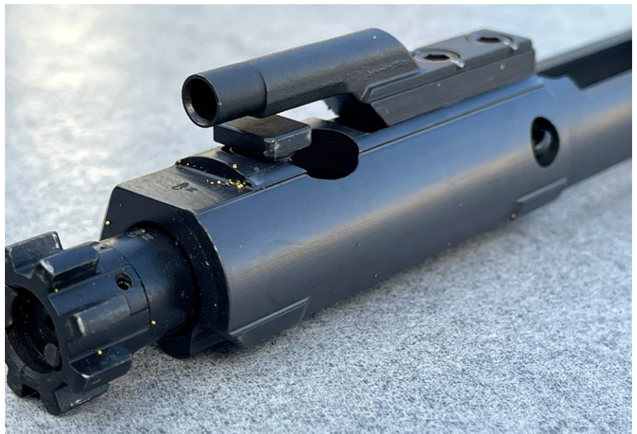
Linke Seite: Verschlussträger einer Gen. 2 Waffe nach 1.200 Schuss
