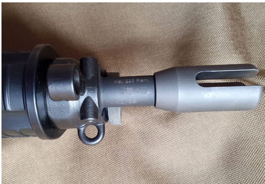
Kaliberangabe, Beschusszeichen, Kennzeichnung des Drittstaates und Verbringungsjahr
