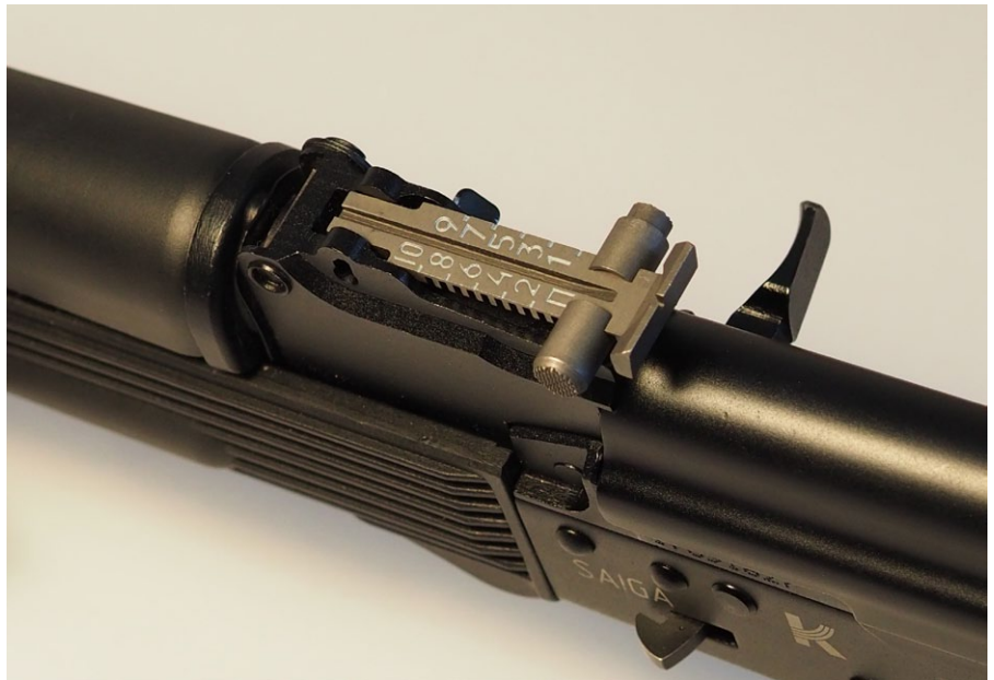
Im Gegensatz zur AKM wurden die Entfernungsmarken für 900 und 1000 Meter ergänzt, warum auch immer. Gut erkennbar: Die „Nullstellung“ mit kyrillischen P als Kampfvisier (Foto: Autor)
