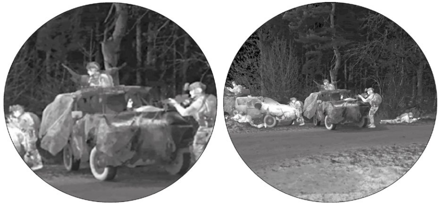
Vergleich: Herkömmliches Vorsatzgerät links und PumIR-6M mit gleicher Reichweite aber deutlich größerem Blickwinkel und verbesserter Schärfe (Foto: Hersteller)
