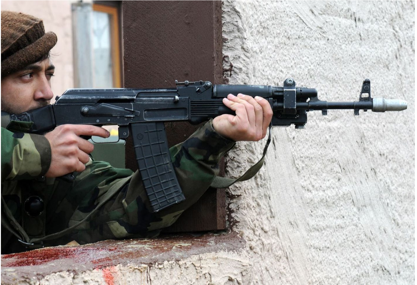
Bulgarische Arsenal AR-M1 im NATO-Kaliber 5,56 x 45 Millimeter mit Manöverpatronengerät und Duellsimulator. Polymer-Magazine von Arsenal lassen sich anhand der „10 im Kreis“ in Kombination mit der Waffelstruktur identifizieren. (Foto: Arsenal AD)
