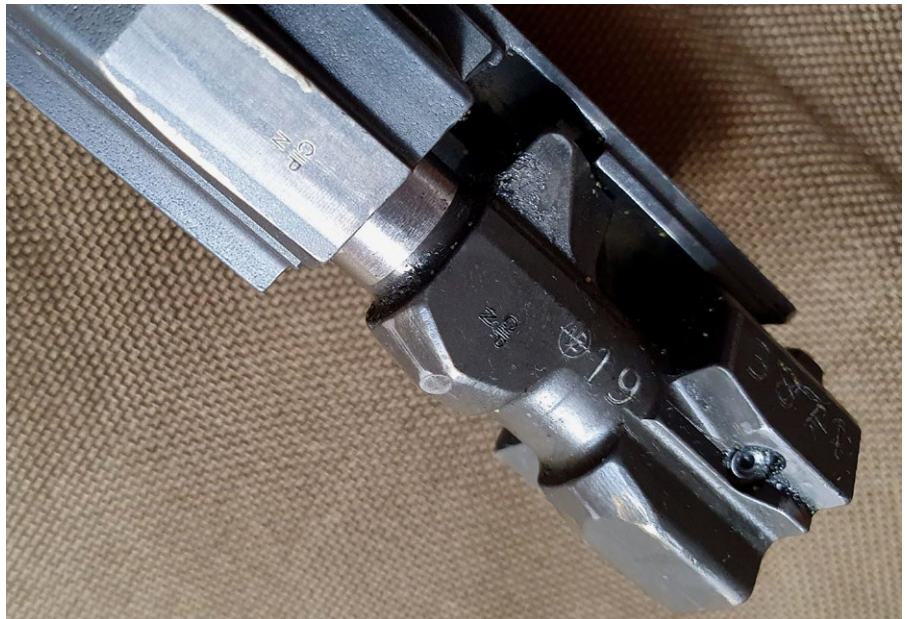
Am Verschlusssträger und Verschlusskopf wurden ebenfalls die Kürzel CIP N angebracht
