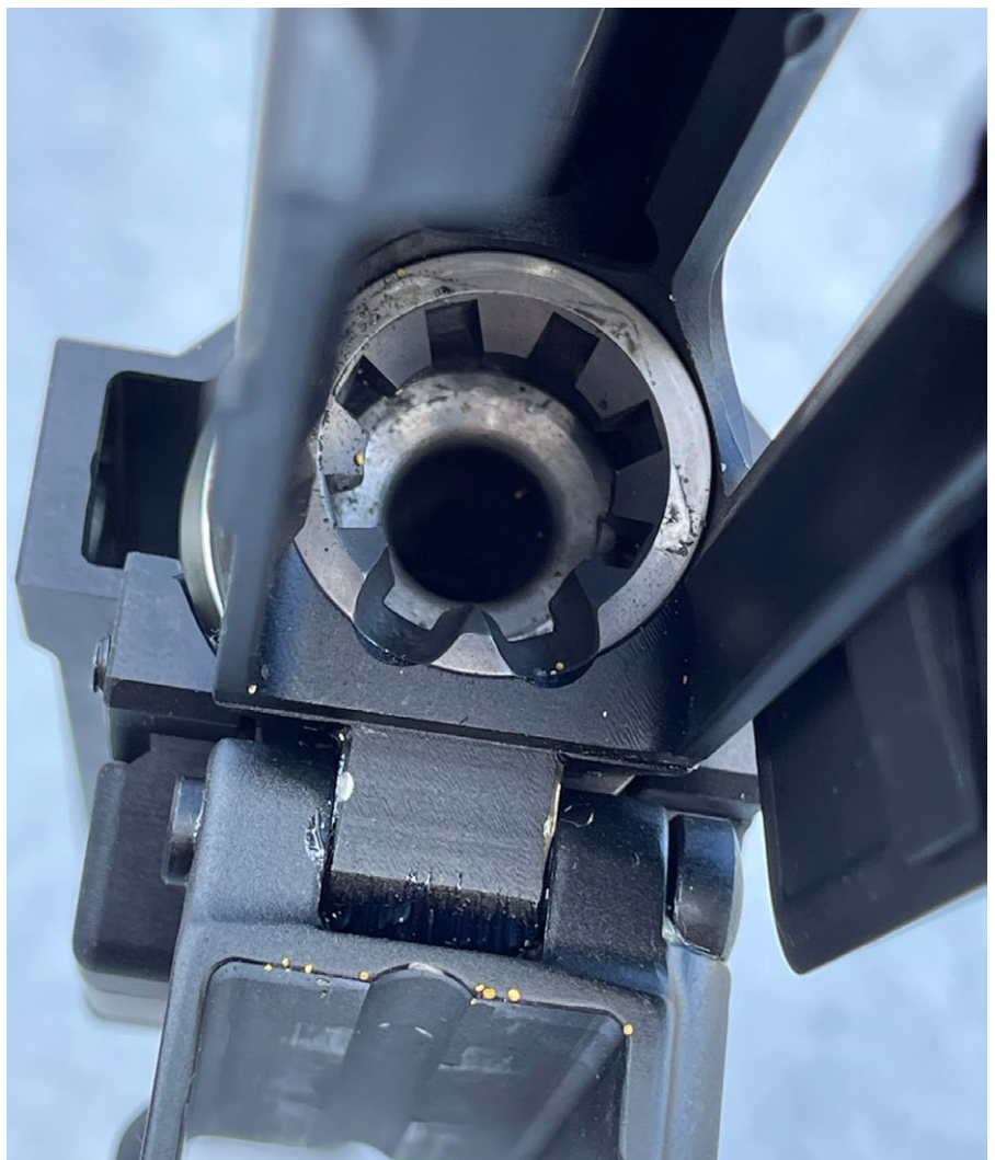
Das Patronenlager der Gen. 2 wurde optimiert und verdaut jetzt alle 300BLK-Laborierungen. Im Bild der Verschmutzungsgrad nach 1.200 Schuss
