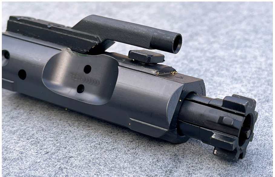
Der Verschlussträger einer Gen. 2 Waffe nach 1.200 Schuss
