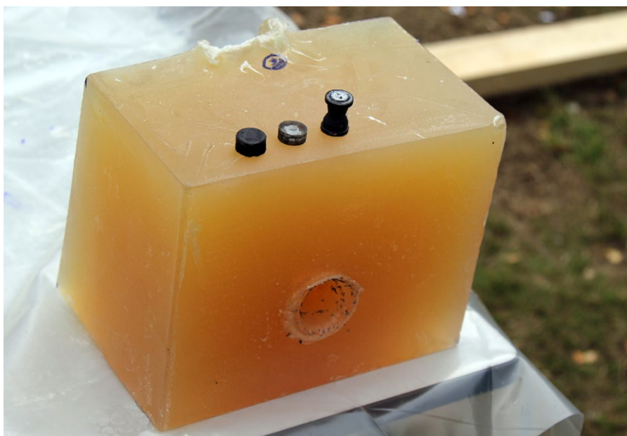
Mit seinen fünf Gramm Geschossgewicht entwickelt die Gummigeschoss-Patrone eine Mündungsenergie von etwa 200 Joule, was wiederum vergleichbar wäre mit der Pistolenpatrone 7,65 mm Browning
