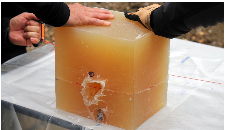
Zum Zerlegen nutzt man am besten eine dünne Schnur. Die Kaverne sollte exakt halbiert werden
