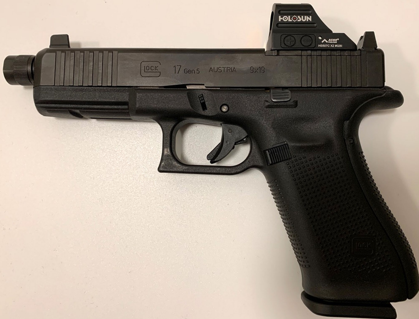
Das Holosun mit einer MOS-Adapterplatte für die RMR-Montageschnittstelle auf einer Glock 17. Zu sehen sind die beiden gummierten Bedientasten des Visiers
