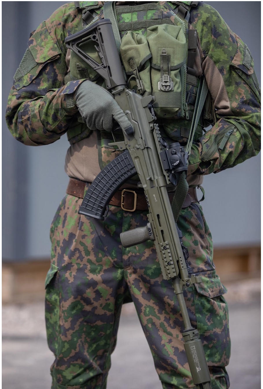
RK 62 M3 montiertem Schalldämpfer von Ase Utra. Aus dieser Perspektive ist das Schutzblech zwischen Magazinlösehebel und Abzugsbügel gut sichtbar. (Foto: Puolustusvoimat)
