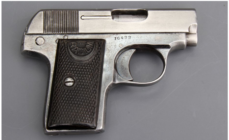
Der unverriegelte Masseverschluss ist typisch für die Epoche und für Pistolen im Kaliber 6,35
