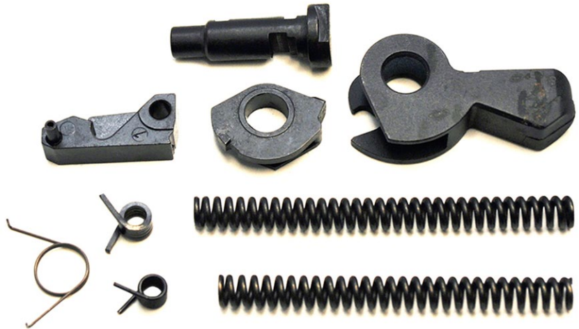
Der Teilesatz für den Umbau. Der versierte Laie benötigt etwa 30 Minuten
