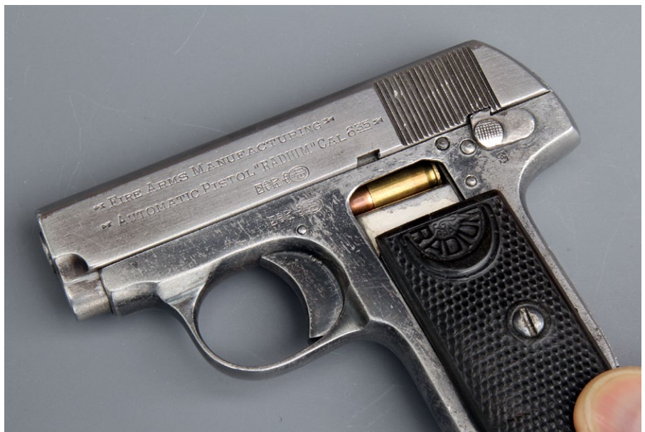
Ladestandskontrolle bei einer Radium: Die Griffschale wird nach unten geschoben
