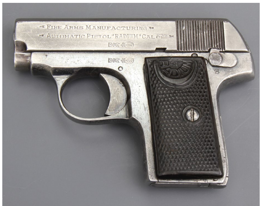
Die Automatic Pistol Radium besitzt nur eine Daumensicherung
