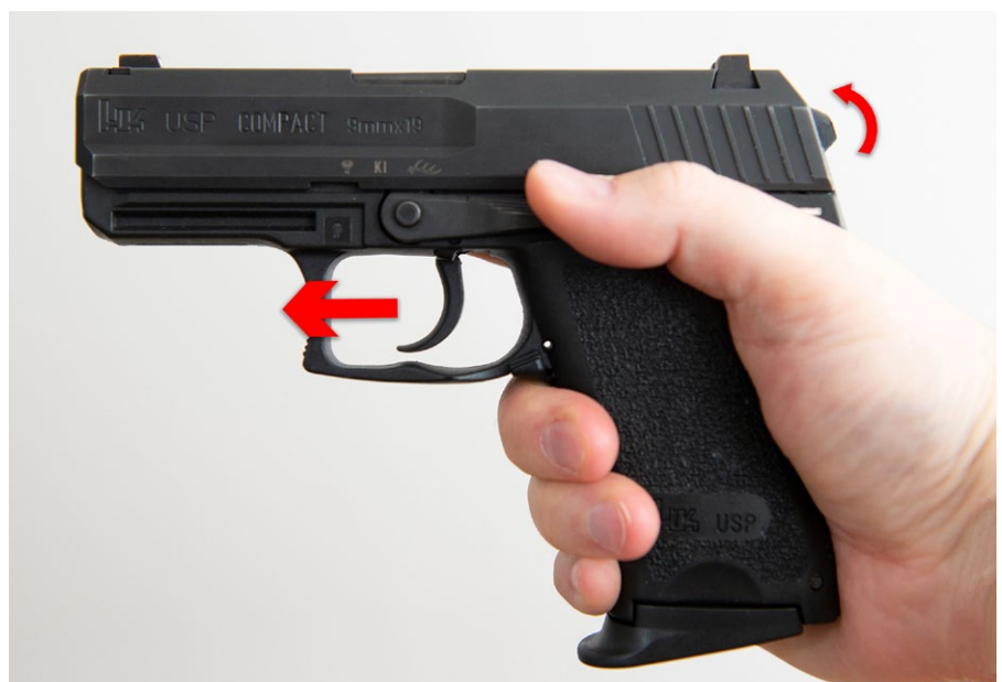
Sobald der Abzug losgelassen wird, gleitet der Hammer in die sichere vordere Rastposition zurück
