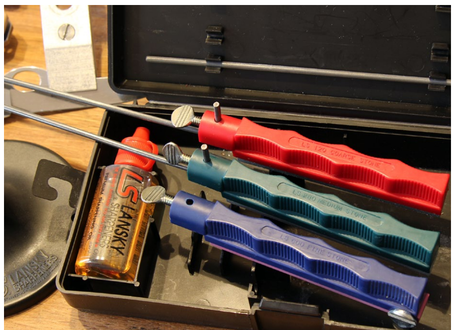
Das Standard-Set enthält die Schleifsteine Rot (120 Coarse), Grün (280 Medium) und Blau (600 Fine). Für den Privatgebrauch sind diese Größen ausreichend
