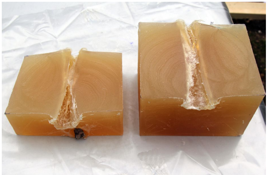
Der 20 Zentimeter tiefe Block wird vom Buck Shot mühelos durchschlagen. Die Kaverne ist kleiner als beim Slug
