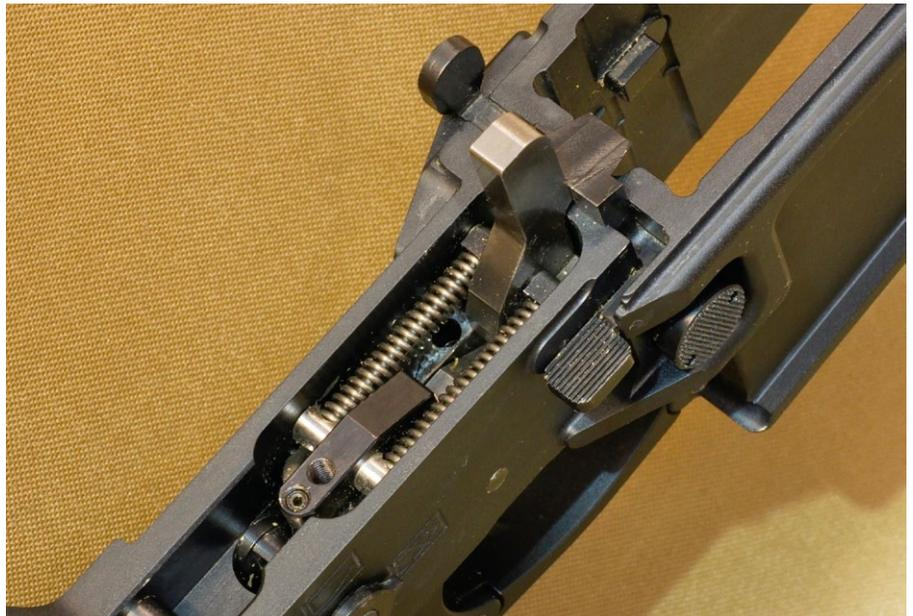
Anstatt der üblichen Federgabel sorgen zwei unter Kompressionsdruck stehende Spiralfedern für einen kraftvollen Hammerschlag
