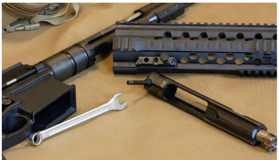
Soll der Handschutz abgenommen werden, ersetzt der Verschlussträger einen elf Millimeter Maulschlüssel
