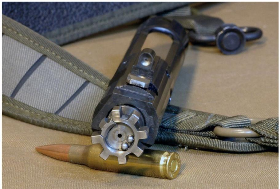
Der massive Drehkopfverschluss weist gleich zwei Ausstoßstifte auf
