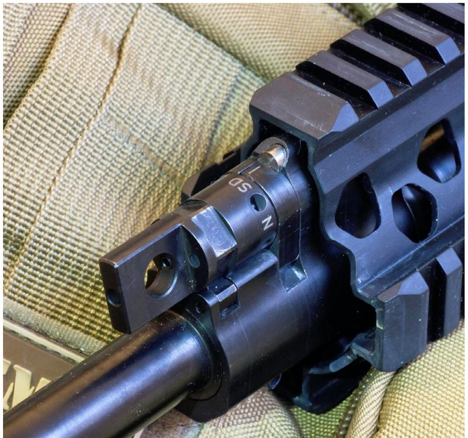
Die standardmäßig verbaute Gasabnahme ist in fünf Stufen verstellbar
