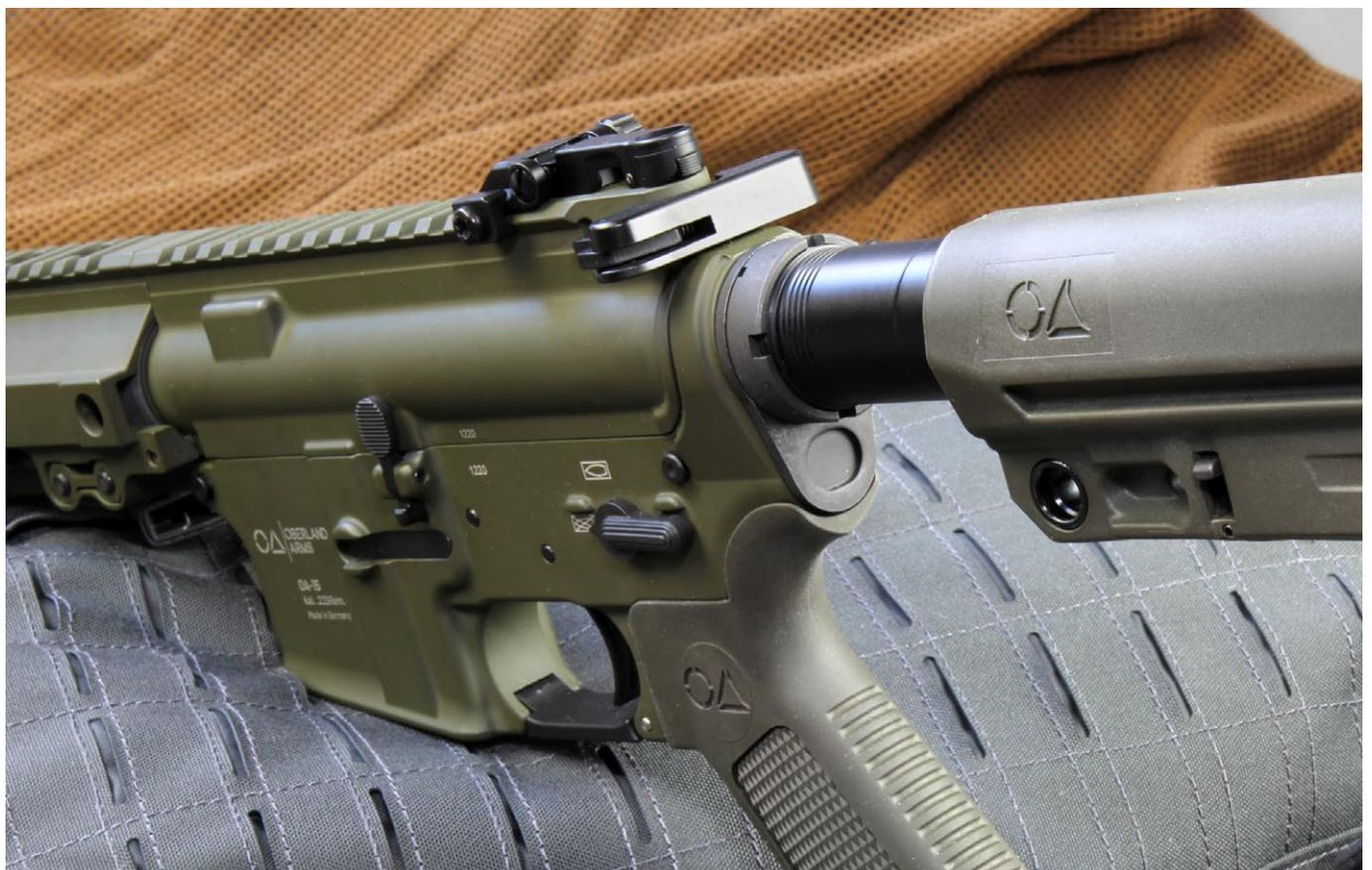
Die Lock-Plate wurde getauscht. Ab Werk stattet Oberland Arms die OA-15 mit einer Lock Plate aus, die einen 1-Punkt-Riemen aufnehmen kann
