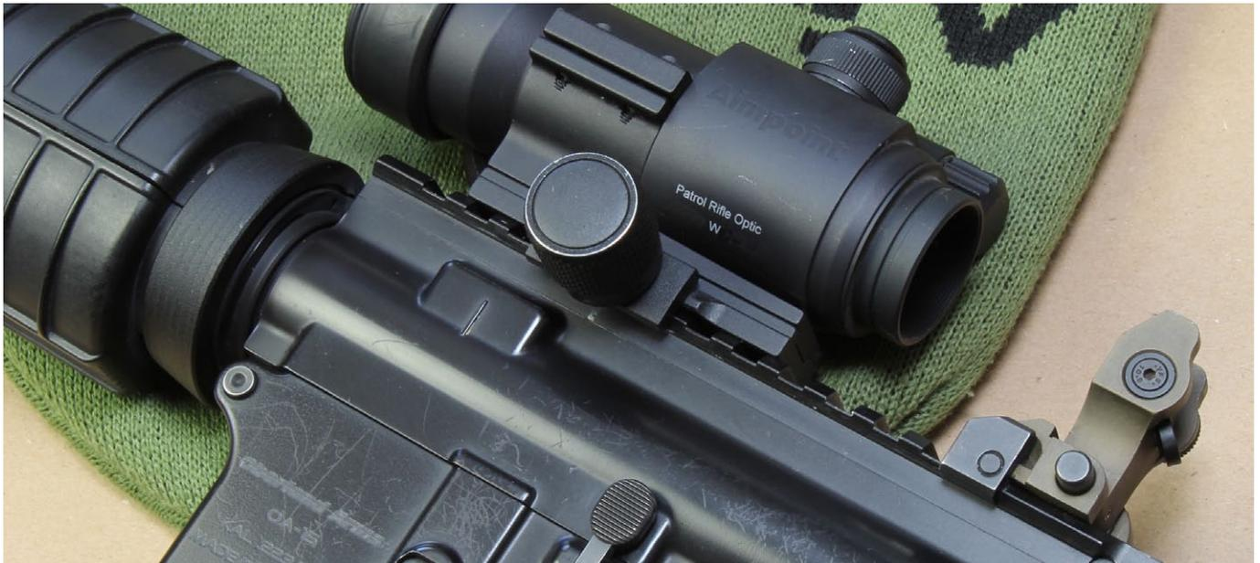
Tipp 3) Drehmoment: Die Drehmomentschraube am Aimpoint PRO sorgt für ein gleichbleibendes Kraftmoment beim Wiederaufsetzen
