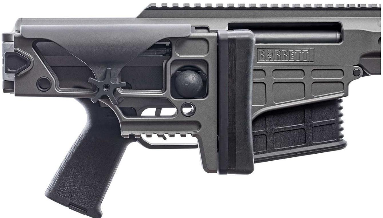
Wird der Schaft an die rechte Waffenseite angeklappt, sichert er gleichzeitig den Repetierhebel gegen unbeabsichtigtes Öffnen
