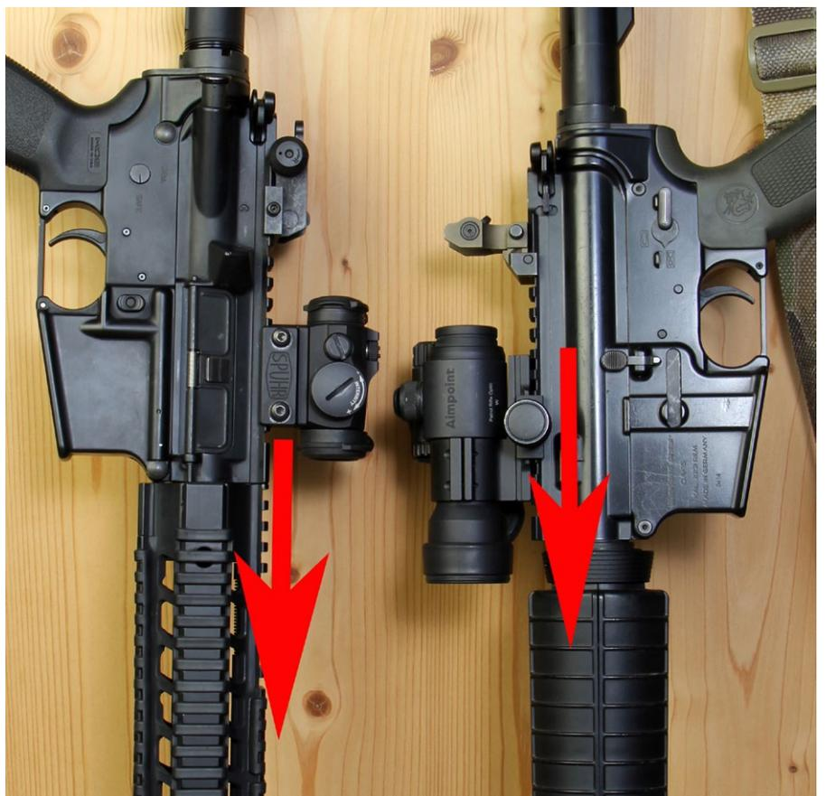
Typ 2) Anschlagsrichtung: Der Einfachheit halber können alle Optiken mit Anschlagsrichtung „im Slot vorn“ montiert werden
