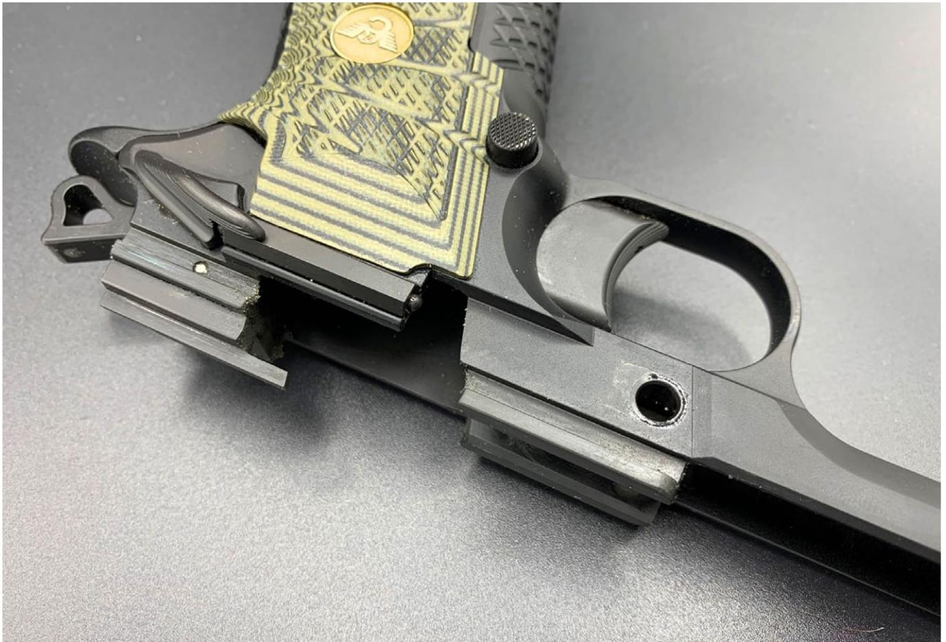
Kurze Schienen zur Führung des Verschlusses. Sie sollen die Zuverlässigkeit erhöhen, ohne die Präzision zu verringern
