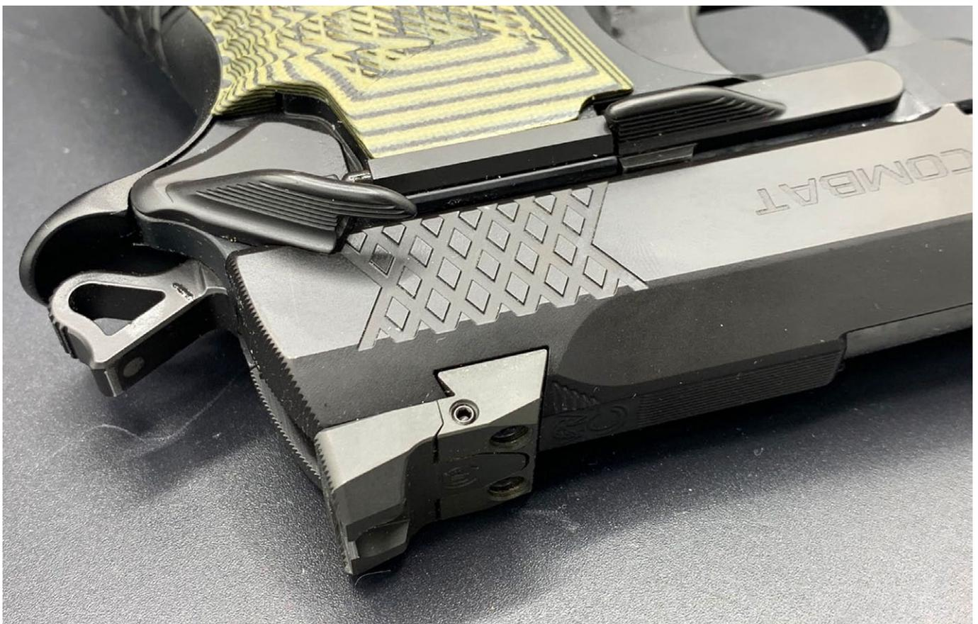
Ausreichend groß und trotzdem nicht im Weg: Verschlussfanghebel und manuelle Sicherung. Gut zu erkennen sind auch die Linienfräsungen an Ober- und Rückseite des Verschlusses
