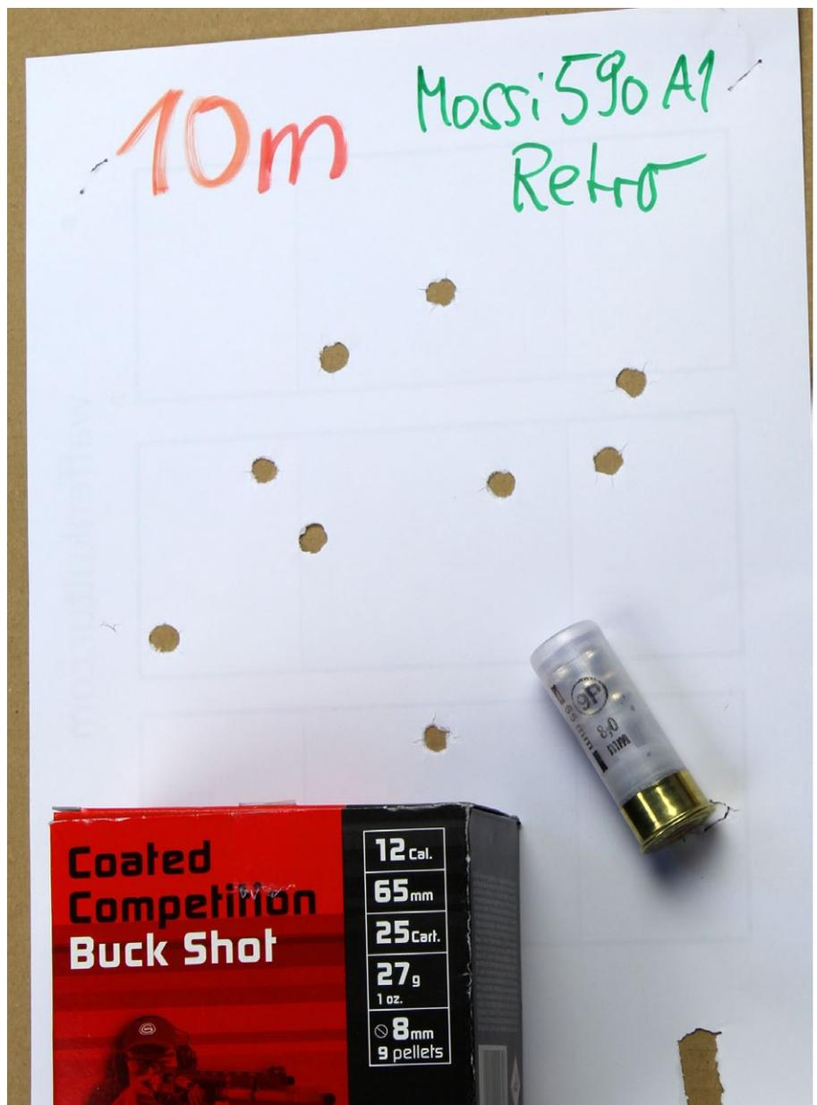
Die GECO Buck Shot ist ebenfalls rückstoßreduziert. Verschossen aus einer Mossberg 590A1 bleiben auf zehn Meter Entfernung alle Posten innerhalb des DIN A4 Blattes (Zone B)
