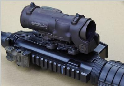
Das wiederholgenaue Aufsetzen einer Optik auf einer Picatinny-Schiene ist keine schwarze Magie. Der Beitrag erklärt den Arbeitsablauf und die drei wesentlichen Faktoren, die nach dem Abnehmen und Wiederaufsetzen zu einer nur minimalen Treffpunktverlagerung führen
