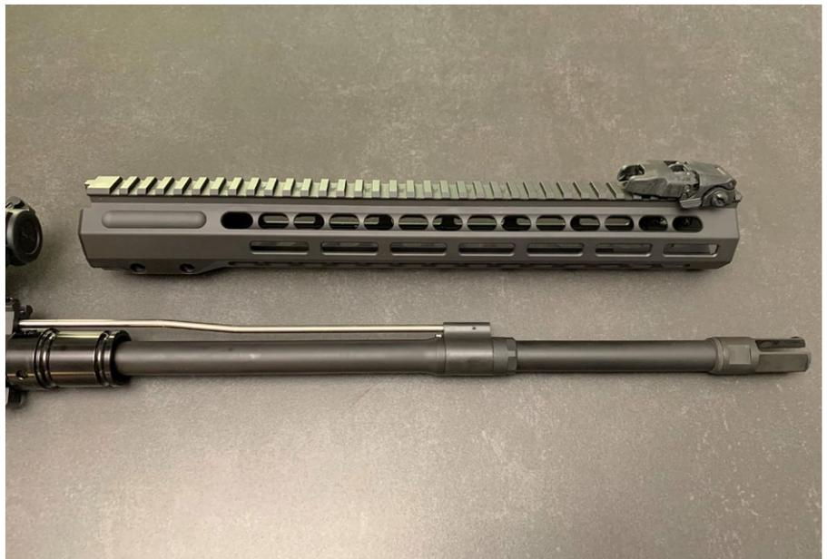
Handschutz sowie Gasblock und Gasrohr. Der Gasblock lässt sich mit einem handelsüblichen Maulschlüssel demontieren
