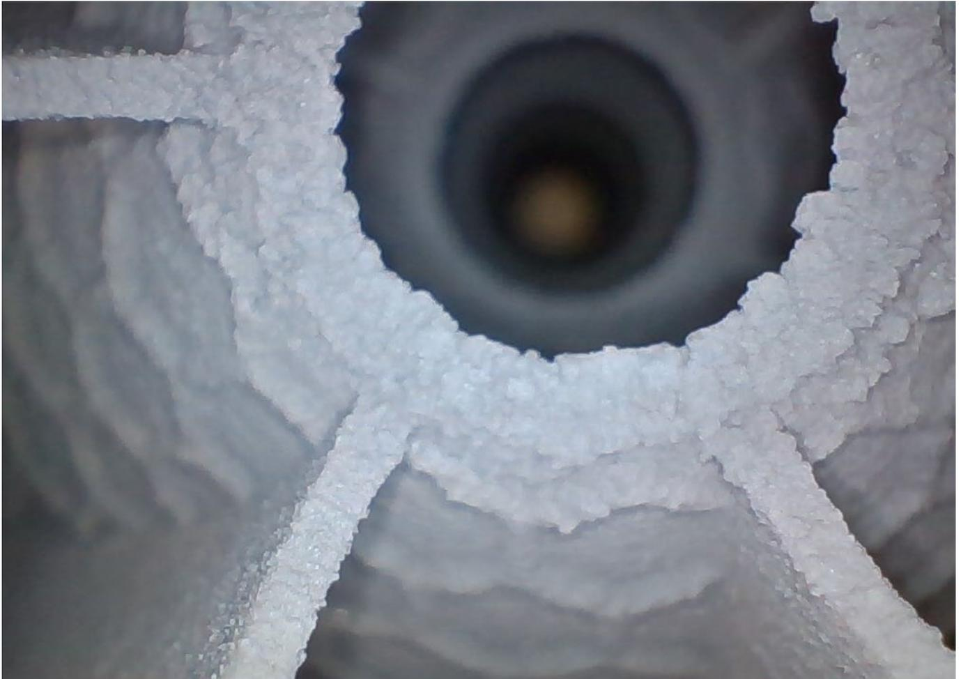
Endoskopisches Bild in die Kammern, alle strukturgebenden Elemente sind frei von Beschädigungen
