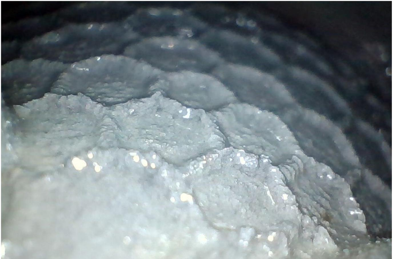
Endoskopisches Detailbild einer Dämpferkammer nach 2.000 Schuss
