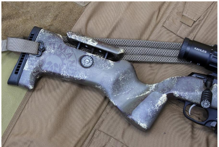
Wird der Riemen am Vorderschaft links und am Hinterschaft rechts montiert, unterstützt er den Anwender sehr brauchbar als provisorischer Schießriemen. Ein Tikka-Repetierer kann somit ähnlich wie ein Selbstlader / Sturmgewehr geführt werden
