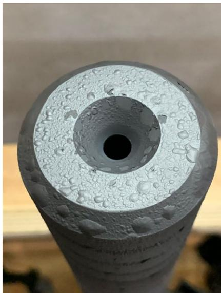
Reaktion der Cerakote Beschichtung unter extremer Temperatur
