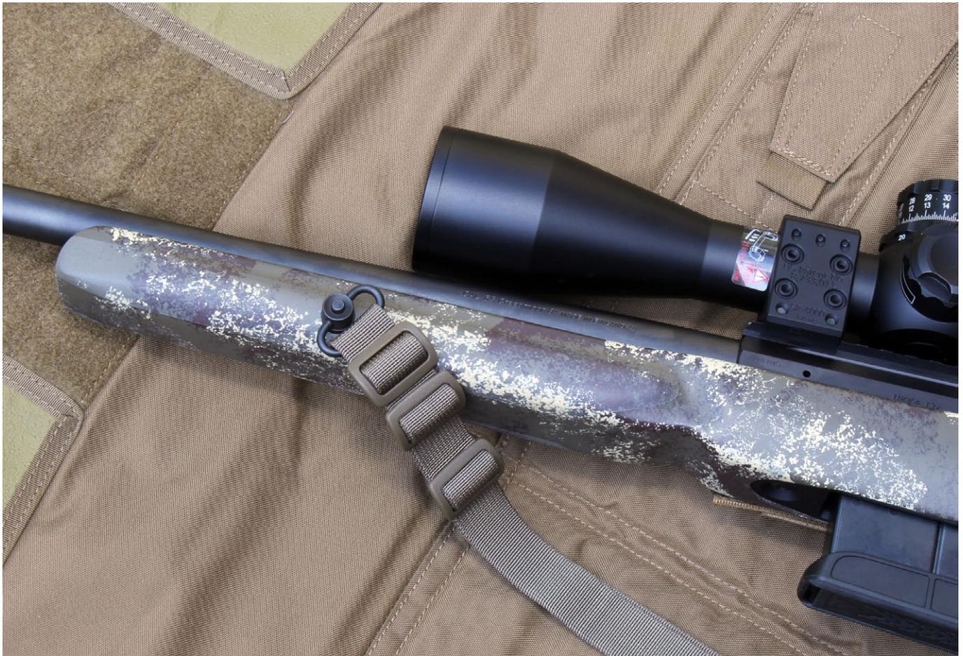
Der Helikon 2-Punkt-Riemen ist mittels Kugeldrucköse am Vorderschaft links und am Hinterschaft rechts befestigt
