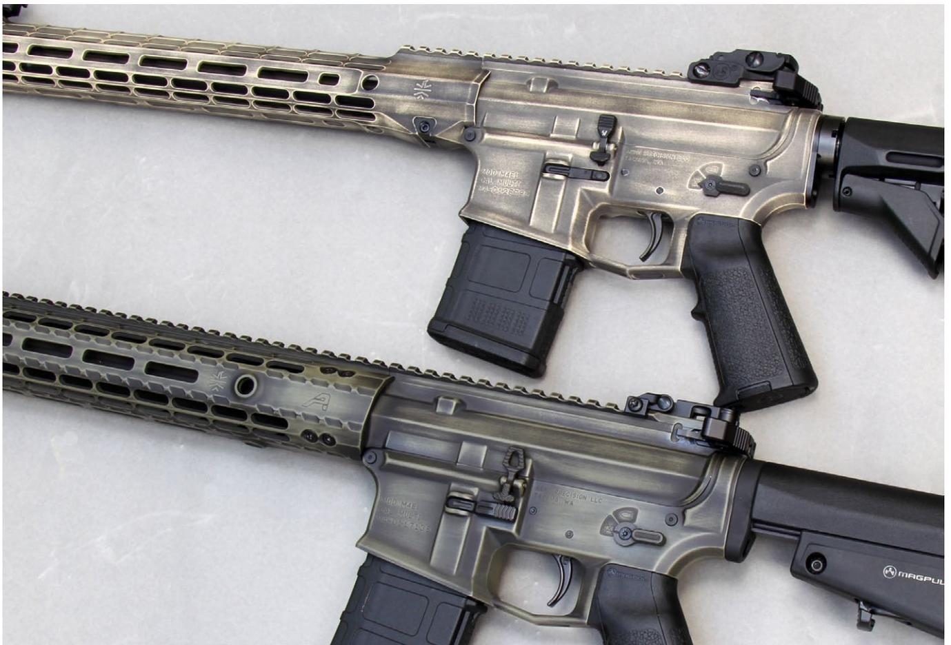
Im Bild unten ist der Vorderschaft angeflanscht, wodurch der Lauf frei schwingen kann
