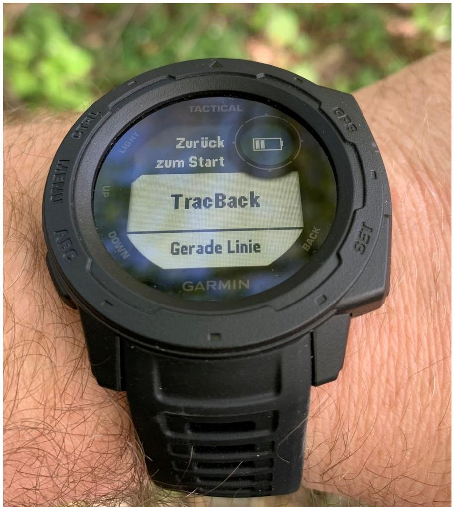
Navigation zum Ausgangspunkt über die TracBack Funktion, oder auf dem schnellsten Weg wird dem Nutzer freigestellt
