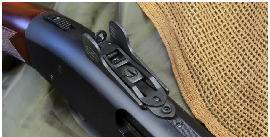
Das Ghost Ring Visier ist höhenverstellbar und durch einen Kornsockel geschützt
