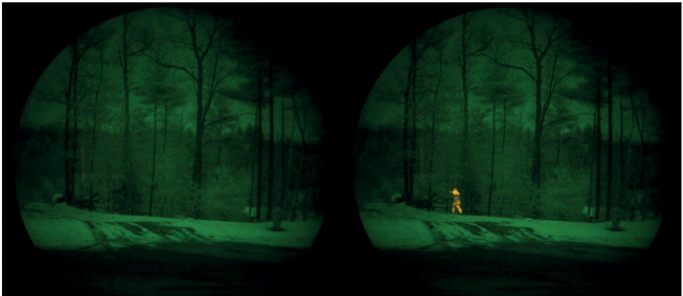
Bei dem intern überlagerten Fusion-Bild (rechts im Bild) einer AN/PSQ-36 Fusion Goggle Enhanced (FGE) hebt sich die Person deutlich vom Hintergrund ab (Foto: IEA MIL OPTIKS GmbH)
