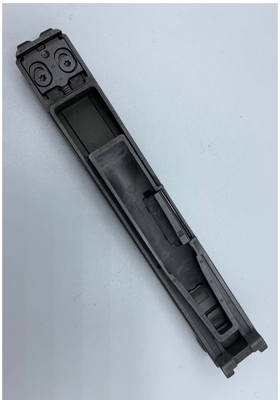
Andere Seitenplatte mit Aufnahmeplatz für die leere Hülse
