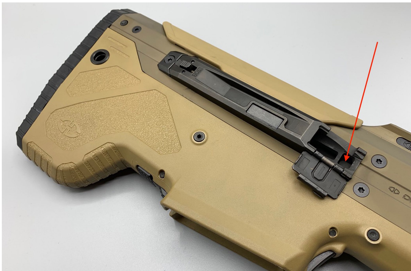
Seitenplatte der Auswurfseite mit geöffnetem Staubschutzdeckel. Der Pfeil kennzeichnet die Öffnung für die Prüfung des Ladezustands
