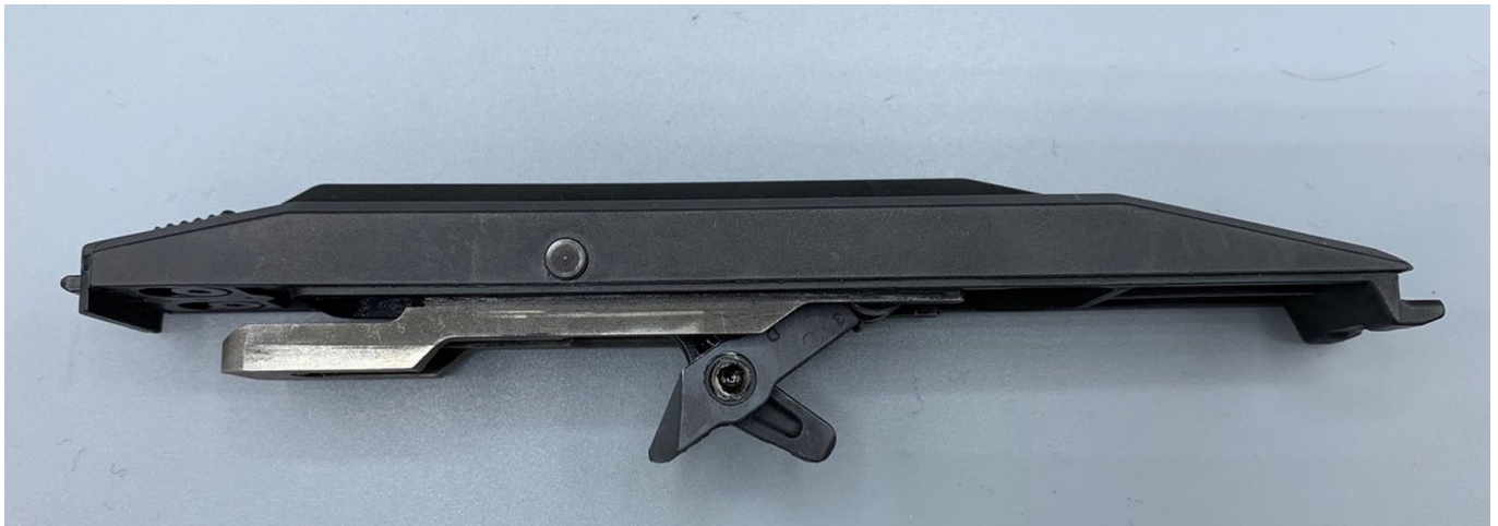
Seitenansicht der Seitenplatte mit ausgefahrener Scherenmechanik. Die beiden „Scherenspitzen“ drücken die leere Hülse aus der Umklammerung des Ausziehers in die gegenüberliegende Seitenplatte
