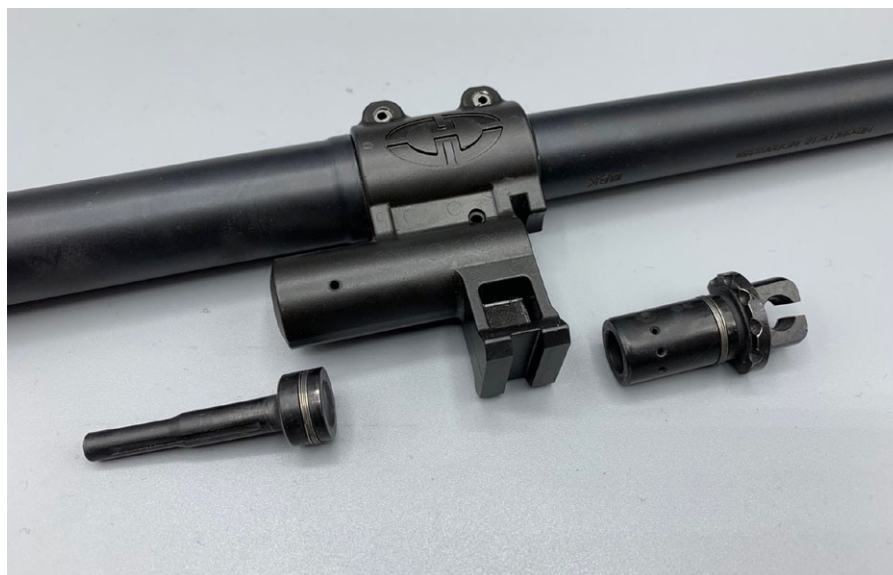
Zur Reinigung zerlegter Gasblock mit Gaskolben und Gasventil
