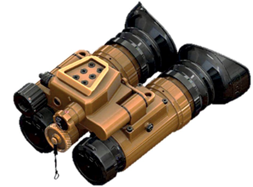
Die binokulare XACT-nv33 von Telefunken RACOMS wiegt trotz integrierter IR-Leuchte, einer Dioptrien- und Fokus-Verstellung weniger als 500 g (Foto: Telefunken RACOMS)
