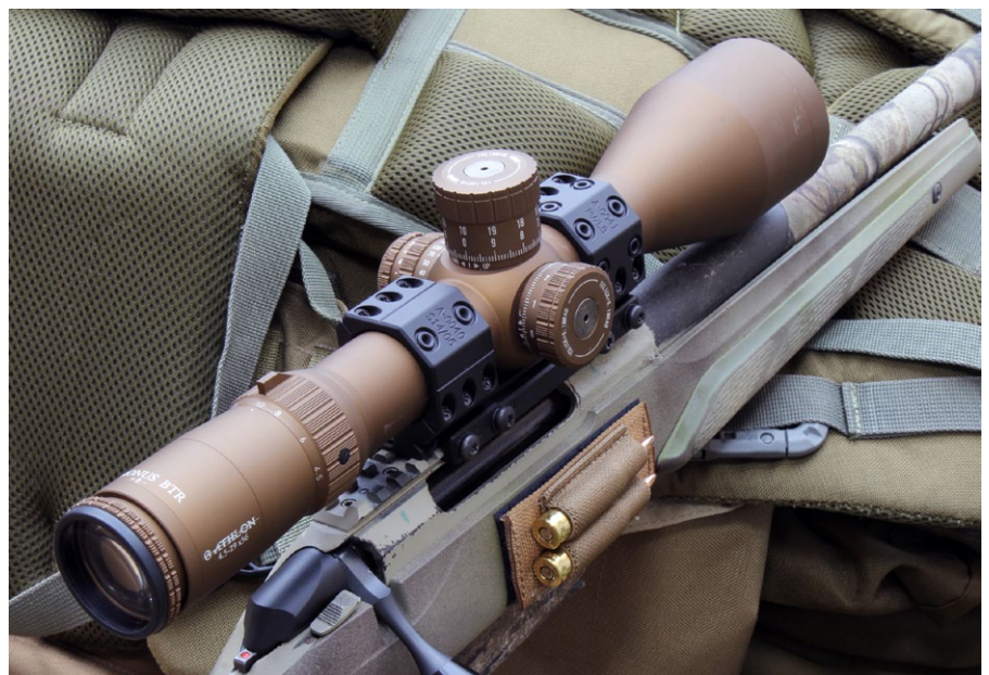
Höhen- und Seitenturm haben cm-Klicks, arbeiten aber CCW (gegen den Uhrzeigersinn)
