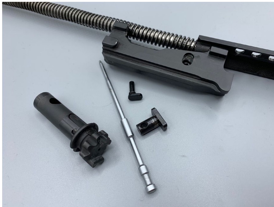
Die zerlegte Verschlussbaugruppe
