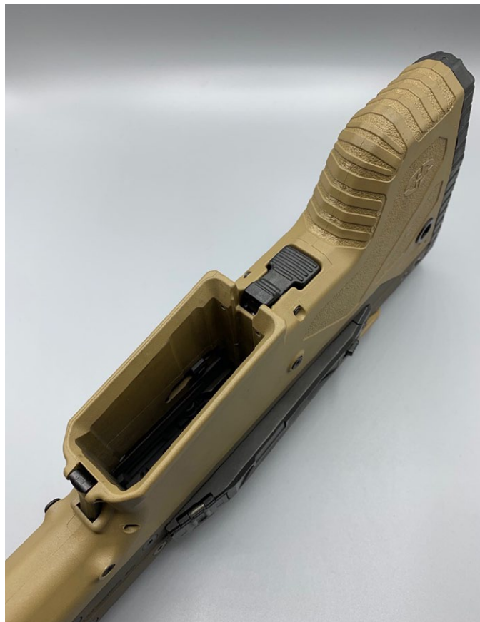
Magazinschacht. Dahinter ist die Entriegelungstaste für den automatischen Verschlussfang zu sehen
