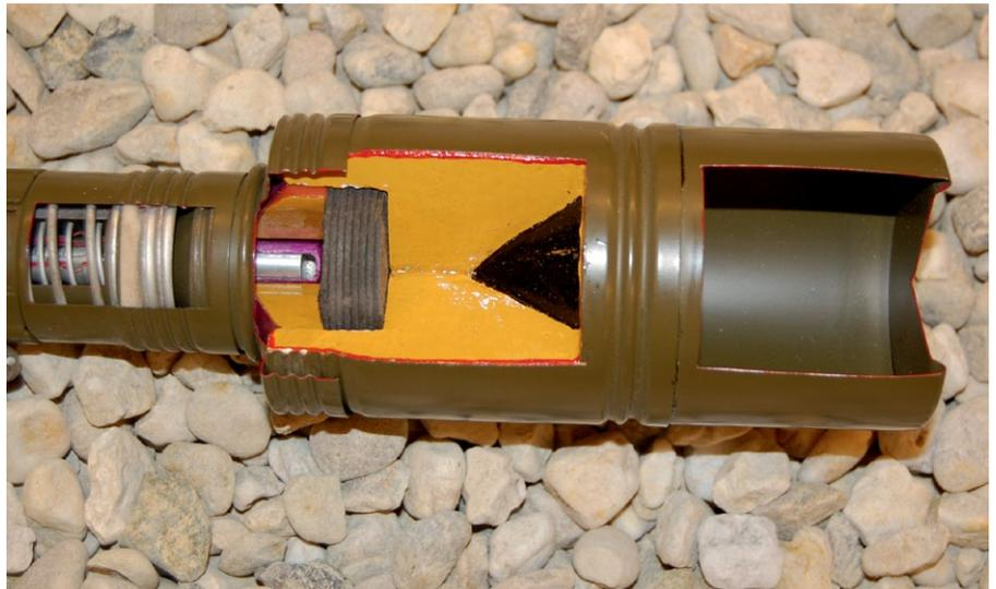
Schnittmodell der Granate RKG-3. Der Handgranatenkörper mit der kumulativen Sprengladung wurde auf der Grundlage des Gefechtskopfes der Panzerfaust RPG-2 entwickelt (Foto: Autor)
