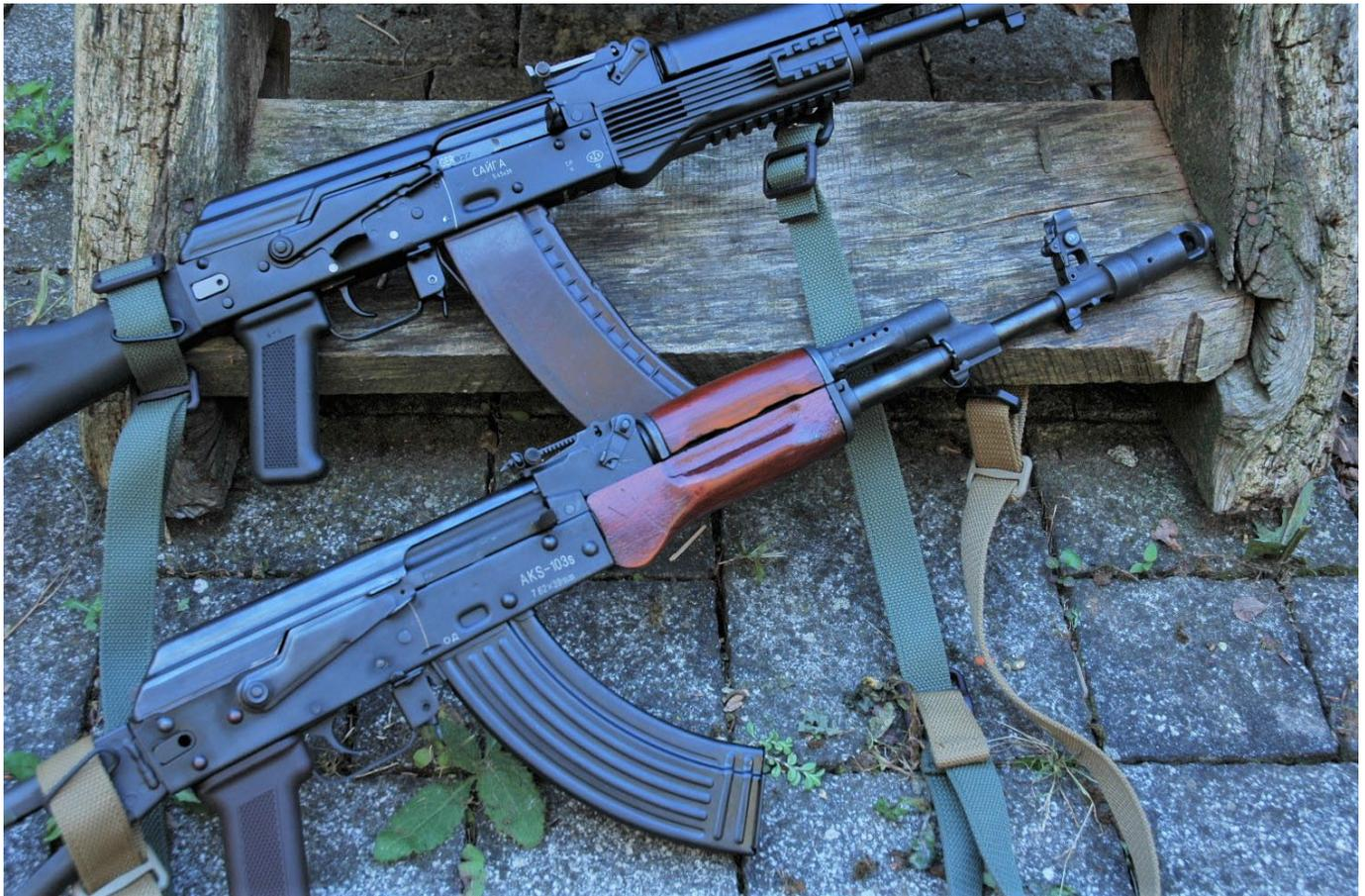
Der Urvater aus Stahlblech im Kaliber 7,62 x 39 Millimeter und ein Kunststoffmagazin („plum“) in 5,45 x 39 Millimeter. Man beachte die unterschiedlich starke Krümmung (Foto: Autor)
