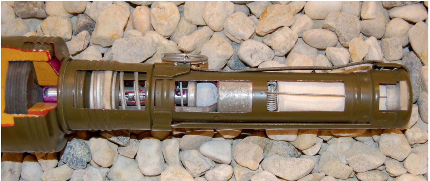
Schnittmodell der Granate RKG-3. Der Stiel mit Sicherungs-, Stabilisierungs- und Aufschlageinrichtung (Foto: Autor)
