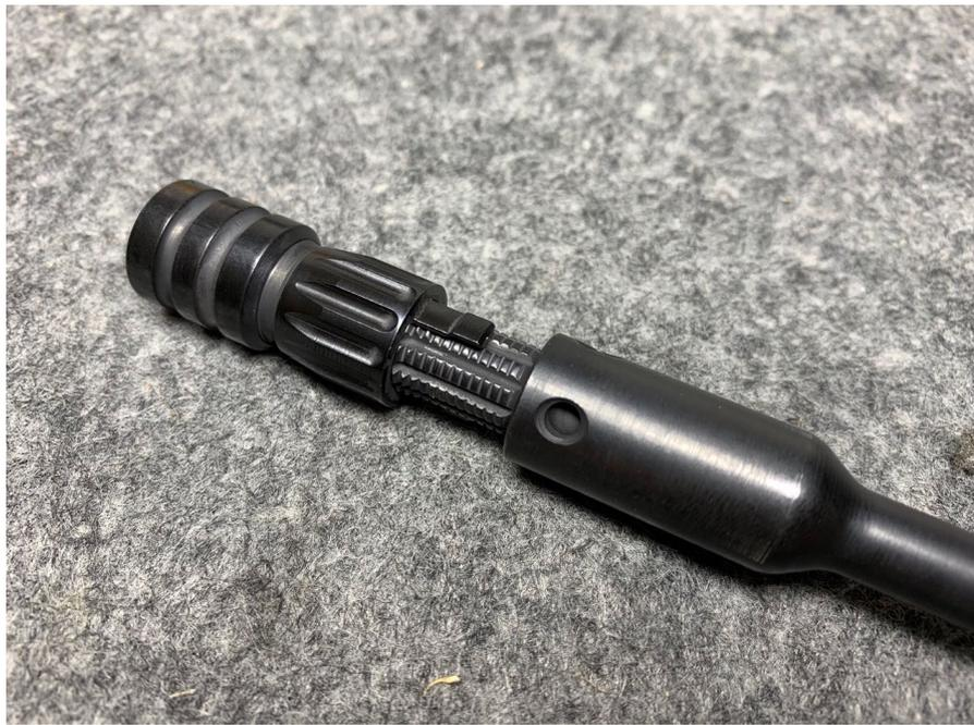
Die Klickverstellung wird ohne Schraubenfedern durch zwei Fortsätze der Einstellschraube realisiert, die jeweils in eingefrästen Vertiefungen einrasten. Im Bild ist nur einer dieser Fortsätze zu sehen
