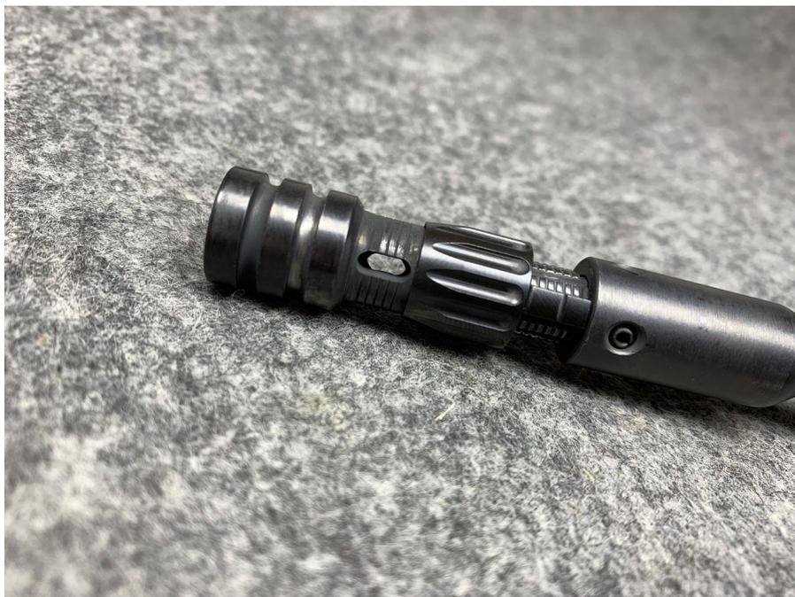
Die zentrale Gasbohrung ist mit länglichen Ausströmöffnungen verbunden. Die Einstellschraube ist im Bild voll geöffnet (+60 Klicks)
