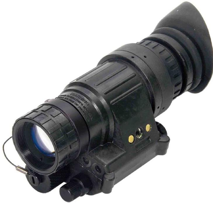
AN/PVS-14 (Generation 3) des Herstellers Harris (ITT-Industries) mit 18-Millimeter-Röhre, 318 Gramm Gesamtgewicht, einer Auflösung von 64 lp/mm und 40 Grad Sehfeld. Erkennung von Personen bis 350 Meter möglich (Foto: Harris Inc.)
