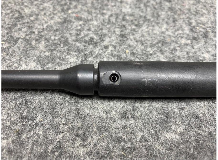
Der KNS Gaskolben wird wie der Originalkolben in den Verschlussträger eingeschraubt, dort aber nicht vernietet, sondern mit einem Spannstift gesichert
