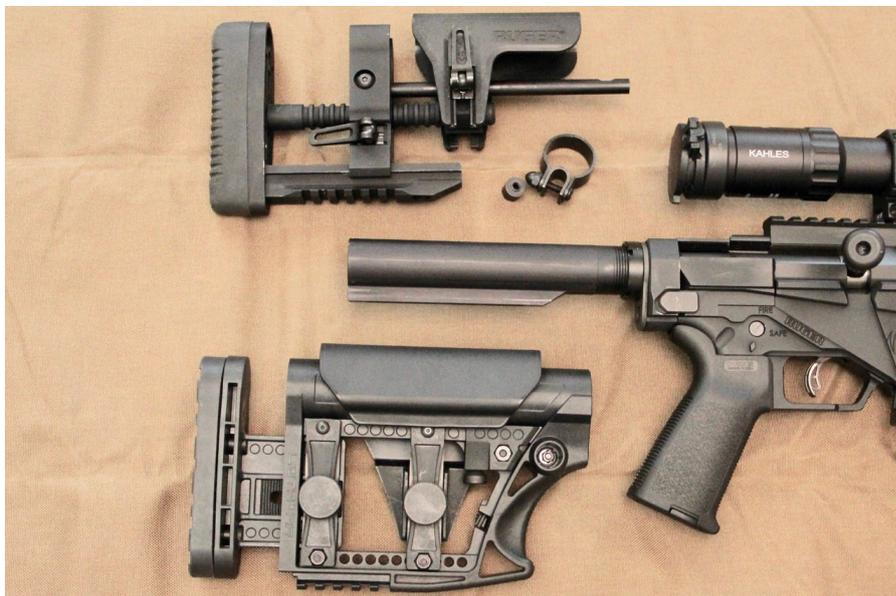
Eine Mil-Spec Röhre („Buffer Tube“) dient als Aufnahme für den Hinterschaft. Somit ist es möglich eine Vielzahl verschiedener AR15 / AR10 Hinterschäfte einzusetzen
