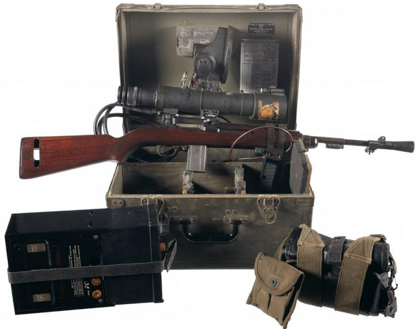
Die Kombination des Sniperscope Infrared 20,000 Volt Set No. 1 (Generation 0) mit einem M1 Carbine ergab die Modellbezeichnung M3 Carbine (Foto: United States Army Historical Center)
