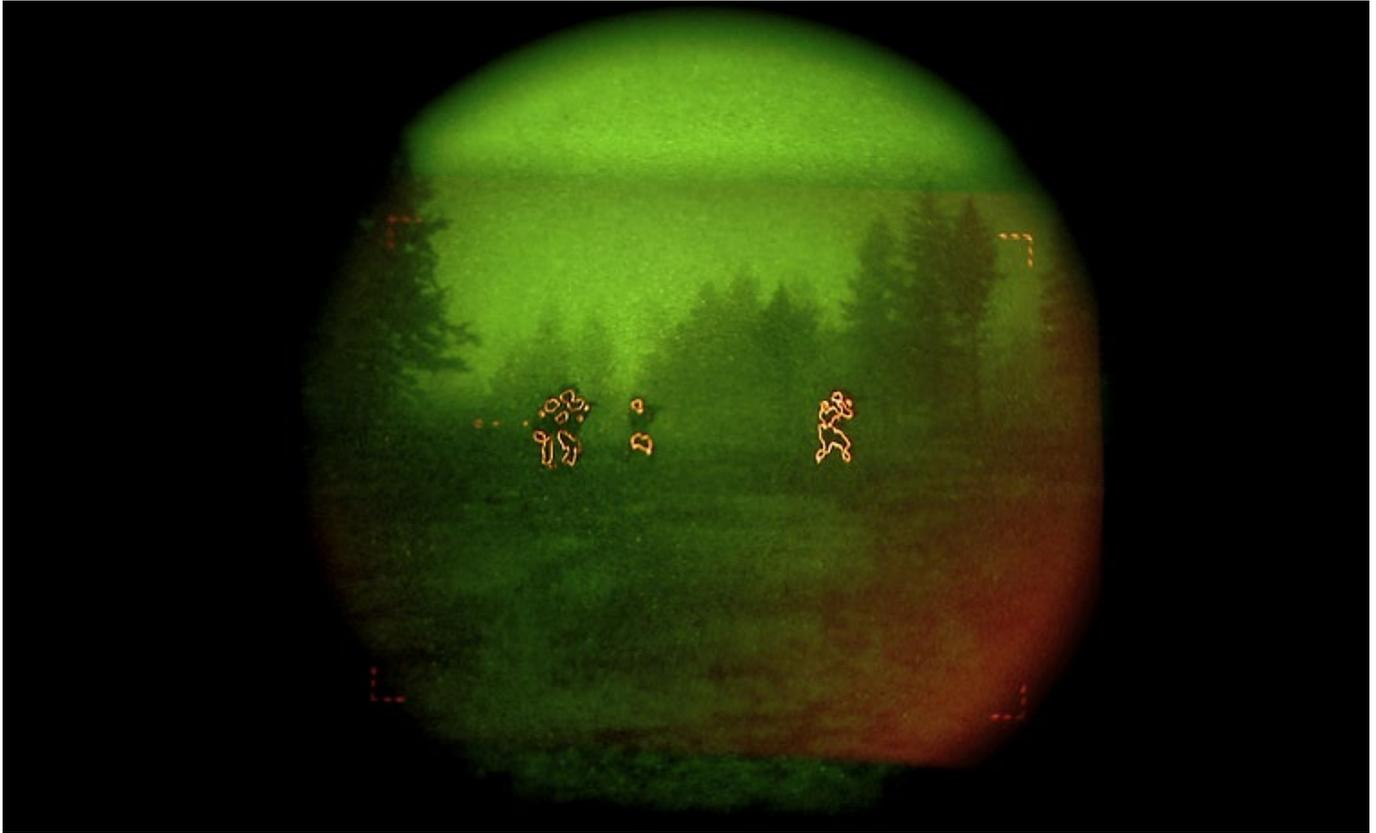
Sicht durch ein AN/PSQ-20 Fusionsgerät – kombiniert mit verstärktem Restlicht, unterstützen die thermischen Konturen den Anwender in der Erkennung und Identifizierung. Die Nachteile der beiden Technologien werden durch die Fusion zum größten Teil ausgeschaltet (Foto: Tactical Night Vision Company)
