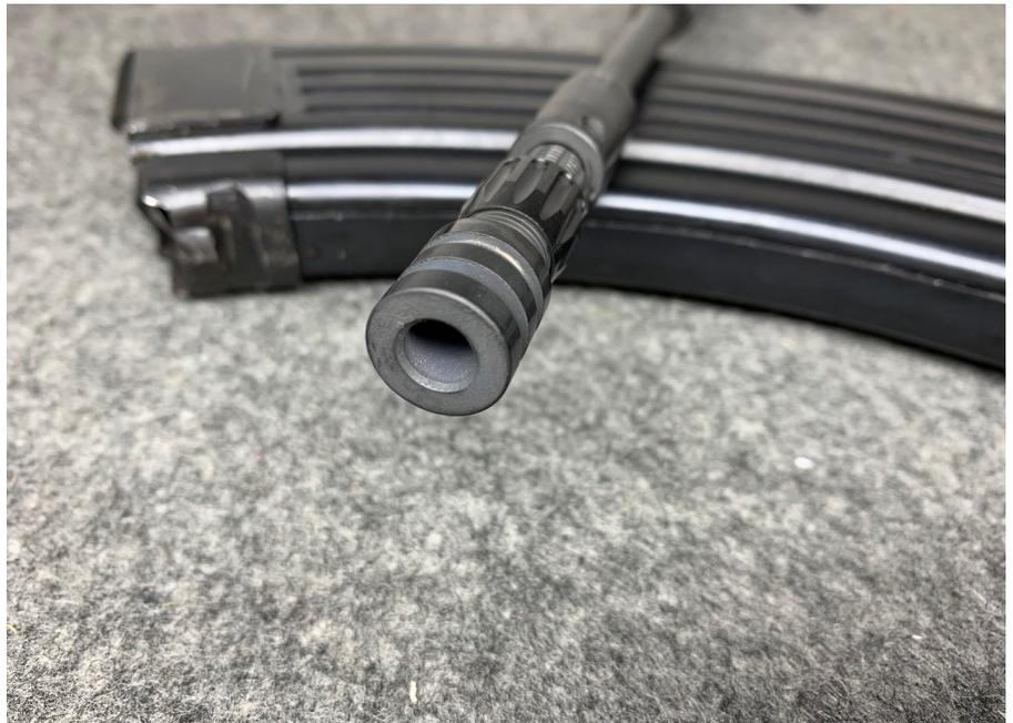
Kolbenboden mit zentraler Gasbohrung
