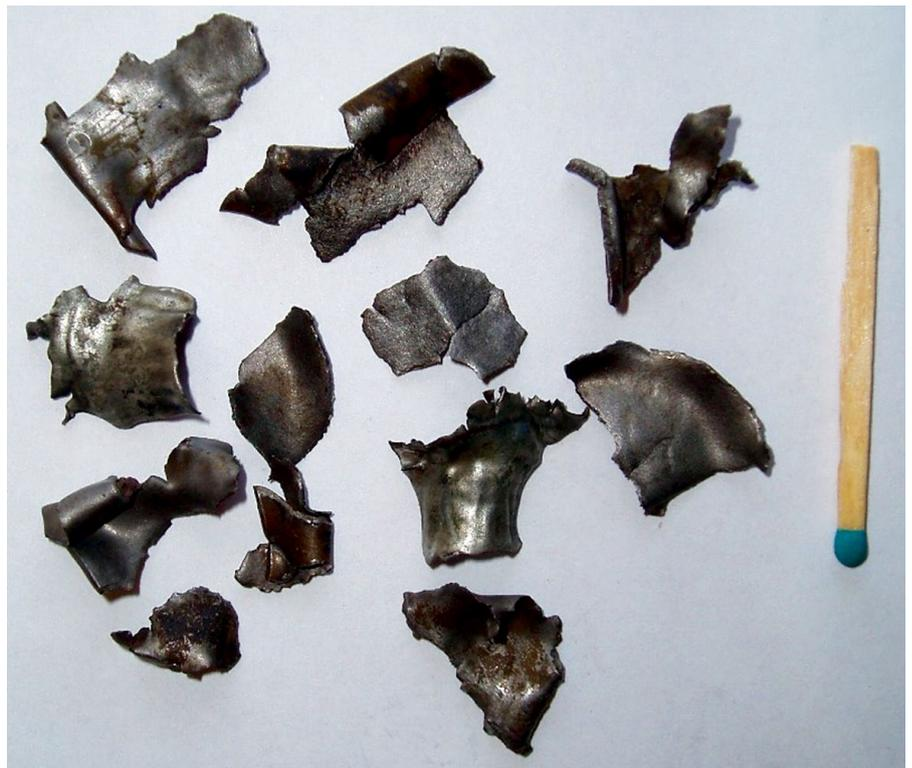
Die RGD-5 erzeugt etwa 350 Splitter (Foto: O. Baschawez)
