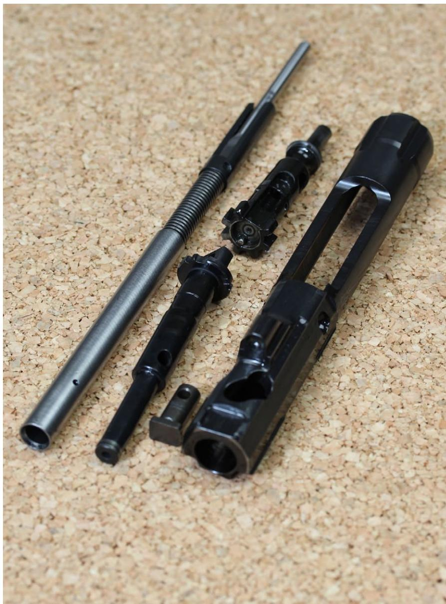
Gasstange, Gasventil und der zerlegte Verschlussträger nach einer Detailreinigung
