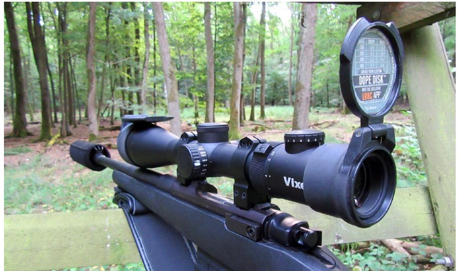
Das Vixen 2,5-15x50 mit MilDot-Absehen. Um die Parallaxeneinstellung auch in der Dämmerung erkennen zu können, wurde die durchschnittliche Schussentfernung markiert. Die Vortex-Schutzkappen können an die Optik angeklappt werden. Im Okularschutz können Korrekturtafeln ihren Platz finden
