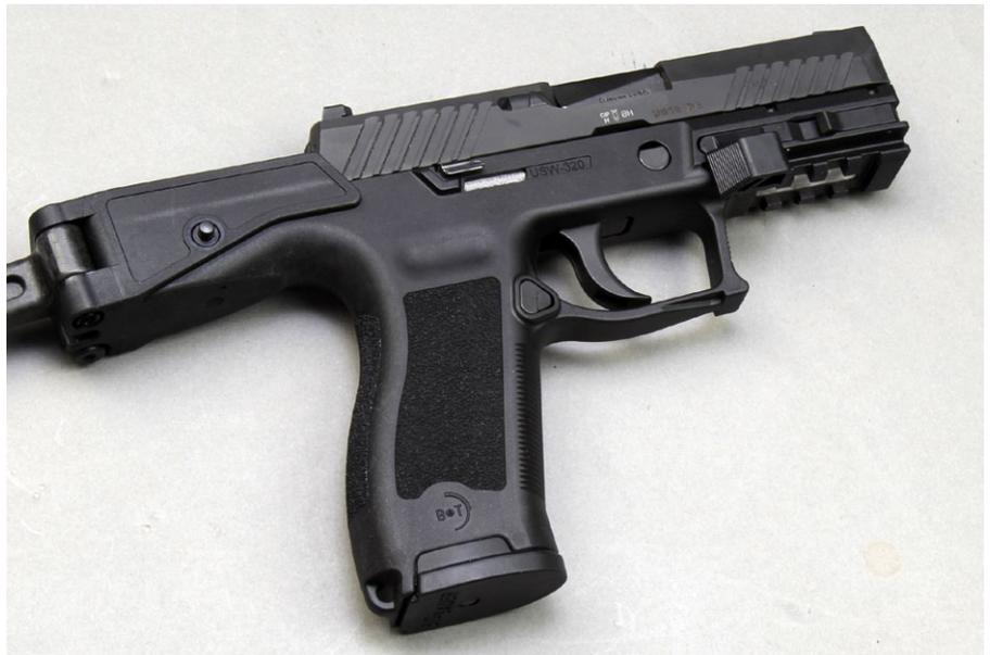
Der Druckknopf an der rechten Chassis-Seite dient als Entriegelung
