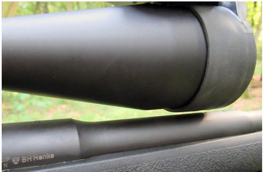
Um bei beiden Zielfernrohren die gleiche Visierlinienhöhe erreichen zu können, musste im Falle des Vixen 2,5-15x50 die Picatinny-Schiene entfernt werden. Die vier Löcher wurden mit bündigen Schraubchen verschlossen
