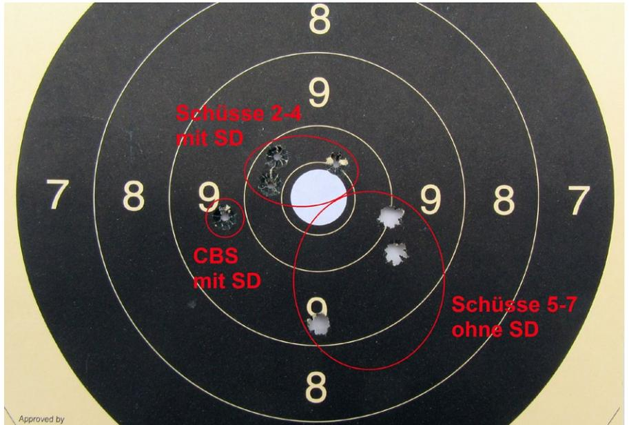
Auch bei diesem Exemplar des GSR weicht der CBS kaum von der Folgegruppe ab. Nach Abnahme des Schalldämpfers und Aufschauben der Mündungsbremse wanderte die Folgegruppe auf 100 Meter ca. um 2 cm nach rechts und 3 cm nach unten. Das Schießen erfolgte bei starkem Regen
