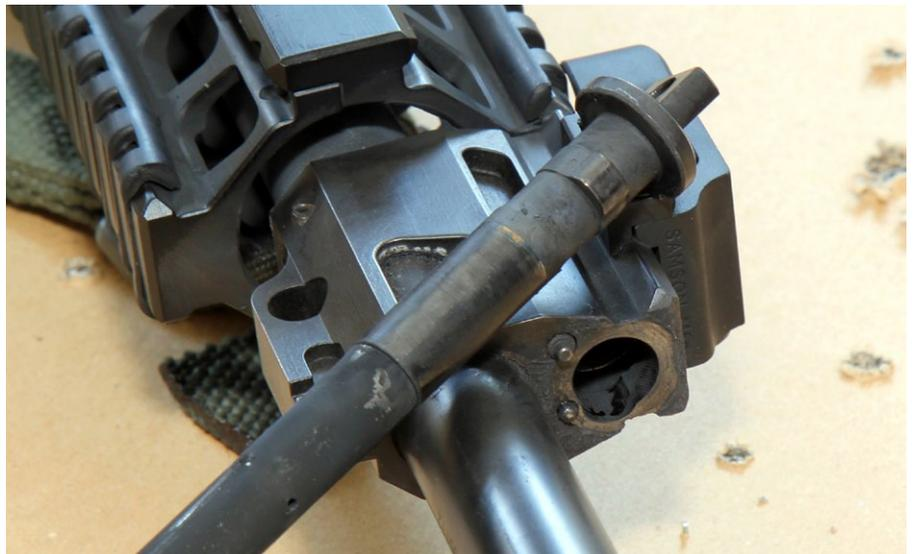
Gasventil und Gasstange nach 600 bis 800 Schuss ohne Reinigung
