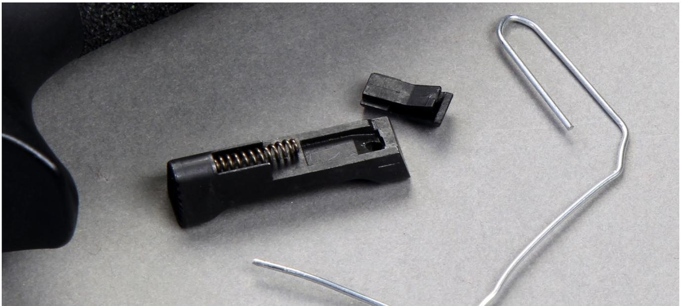
Das Konstruktionsprinzip des Magazinhalteknopfes erschließt sich erst nach dem Ausbau
