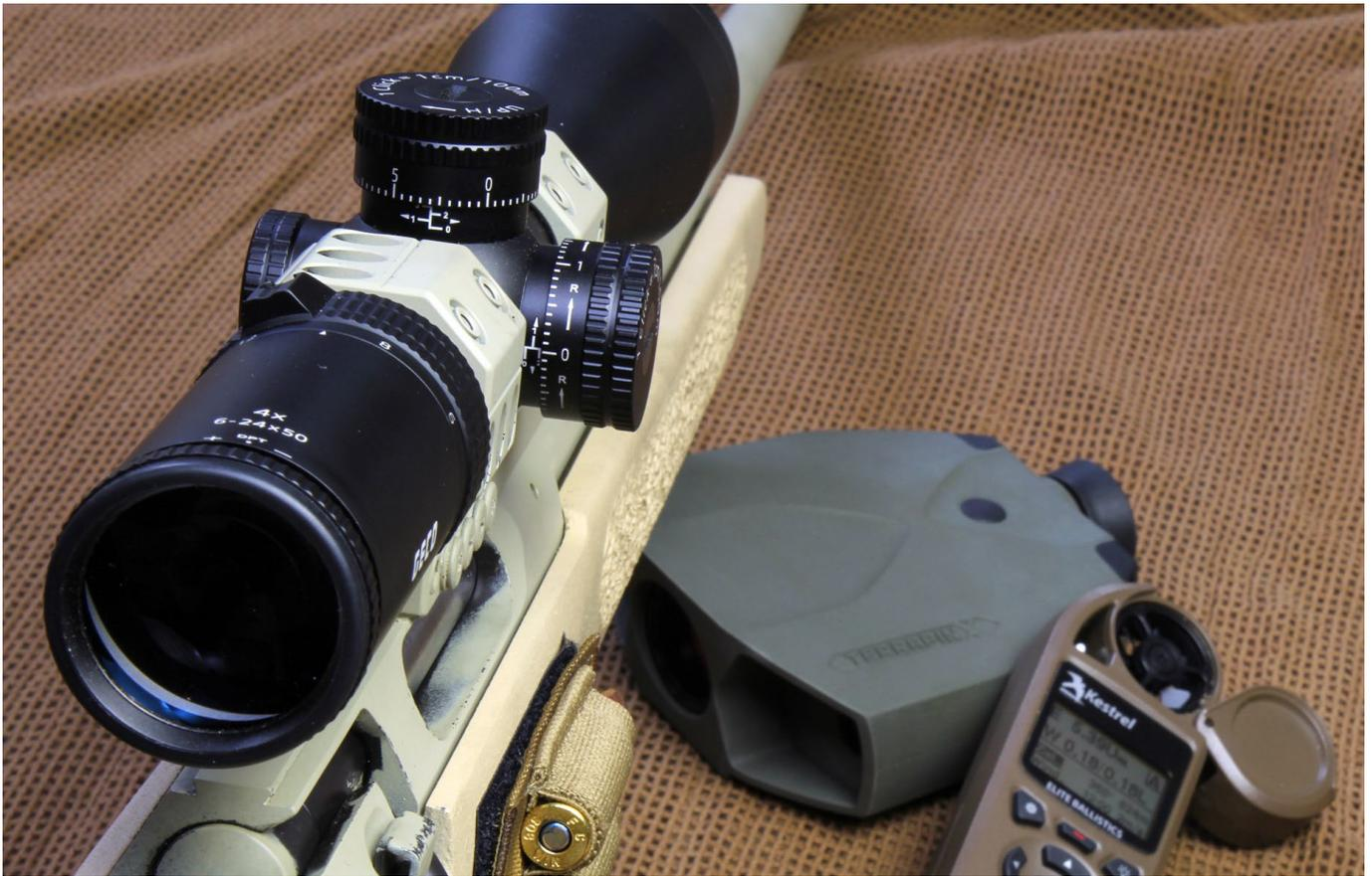
Beim 870-m-Treffer stand der Höhenturm mit +104 Klicks auf Rechtsanschlag. Bei der Seitenkorrektur kompensierten sich die -3 Klicks für die Spindrift mit den +3 Klicks für den Windausgleich
