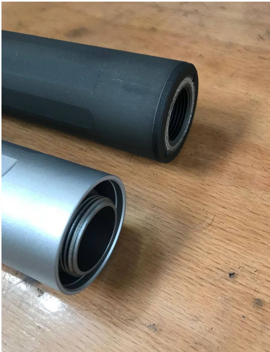
Weißfertiger Dämpfer ohne hinteren Abschluss. Gut zu sehen ist der Expansionsraum zwischen Außenrohr und Innenmodul. Im Hintergrund fertiger KDA mit Lasergeschweißtem Abschluss
