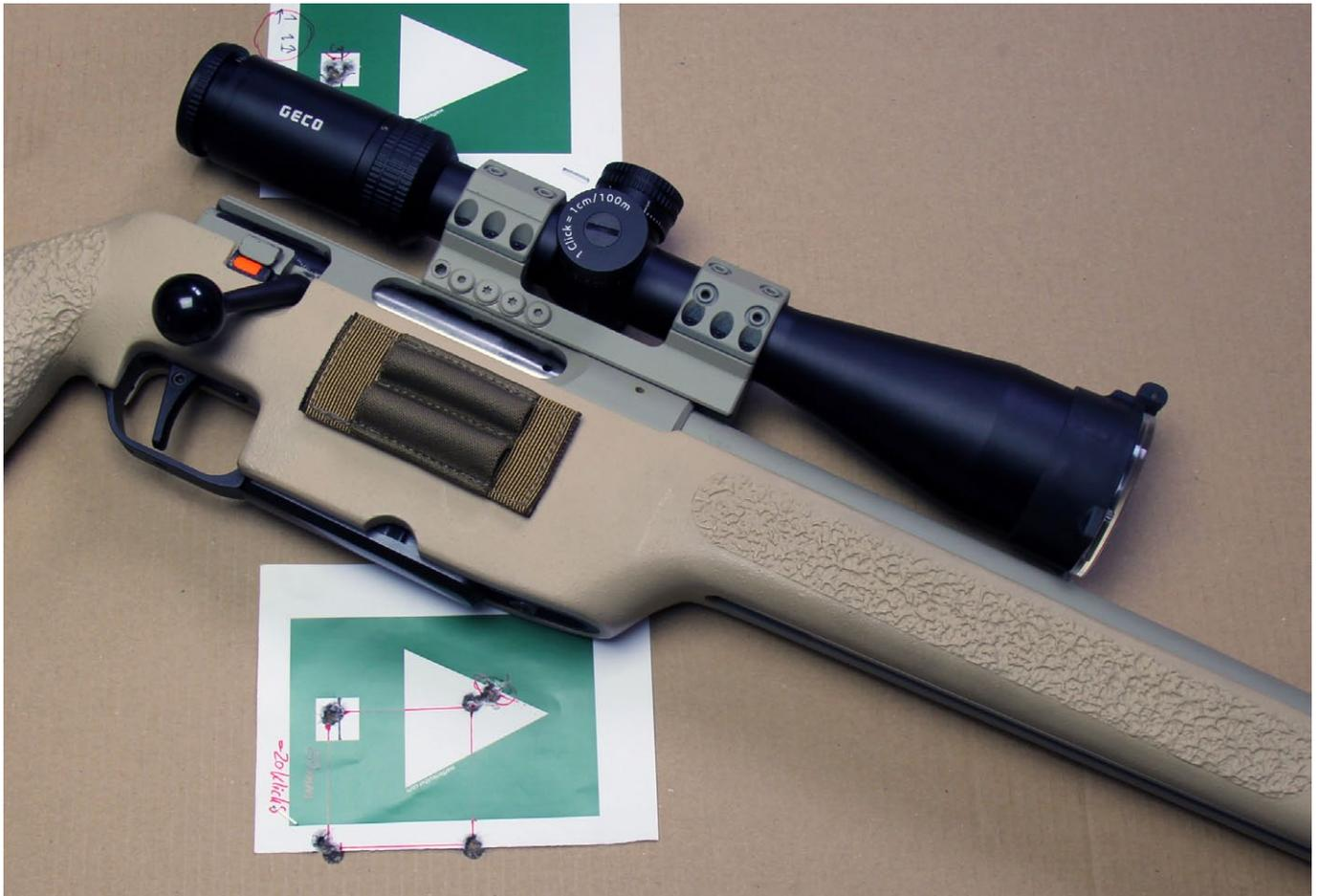
Höhen- und Seitenturm arbeiten im clockwise-Prinzip mit mil-Klickmaß von 1 cm/100 m
