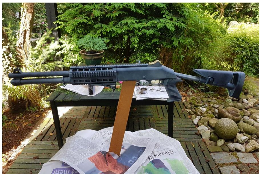
Die erste, dünne Schicht der Grundierung ist bereits aufgetragen. Beachte die abgeklebte Visiereinrichtung
