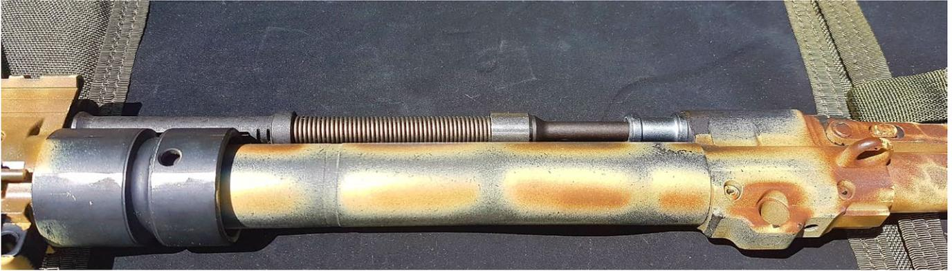
Hitzebeständig: Rohr eines HK MR.223 nach rund 1.500 Schuss
