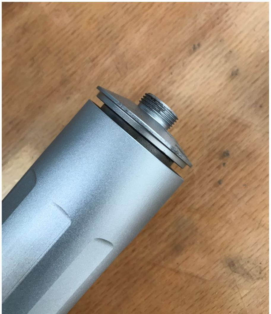
Der vordere Abschluss des KDA ist nur mit dem Innenmodul verbunden, das am hinteren Ende des Außenrohrs mit diesem verschweißt wird. Dadurch kann sich das Innere des Dämpfers bei Erwärmung nach vorne ausdehnen, ohne dass die Außenhülle reißt
