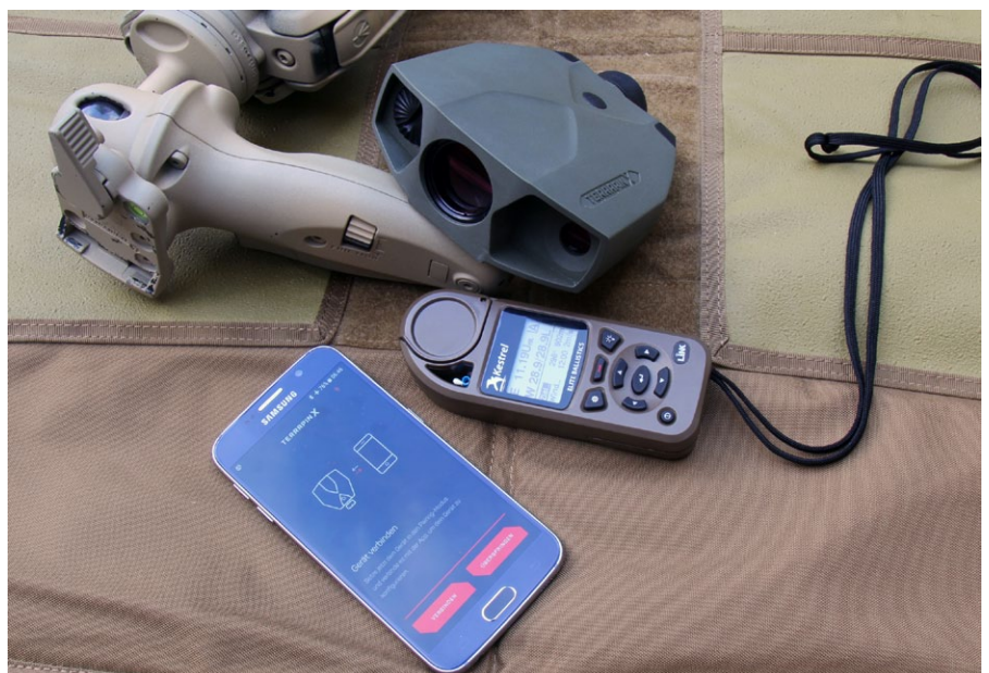
Der TERRAPIN X vernetzt sich mit einem Kestrel oder einem Smartphone, welches die haus eigene TERRAPIN X Mobile App besitzt
