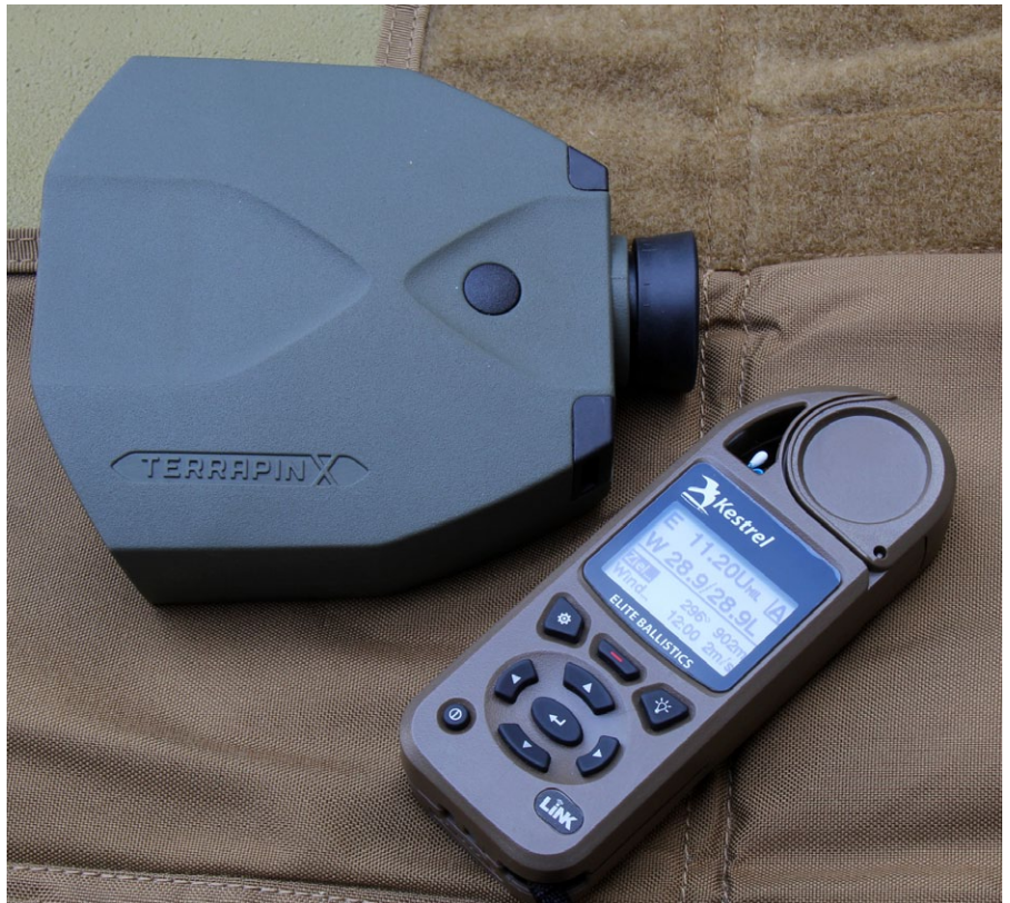
Die Interkonnektivität von Entfernungsmesser und Kestrel bringt eine deutliche Zeitersparnis bei der Ermittlung der Korrekturdaten. Der Kestrel muss Bluetooth-fähig sein (Kestrel 5700 Elite Ballistics)
