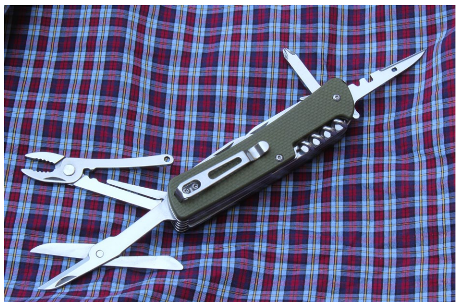
Die Federn von Zange und Schere werden erst beim vollständigen Öffnen belastet. Torx und Dorn lassen sich nur ausklappen, wenn Zange und Schere geöffnet sind
