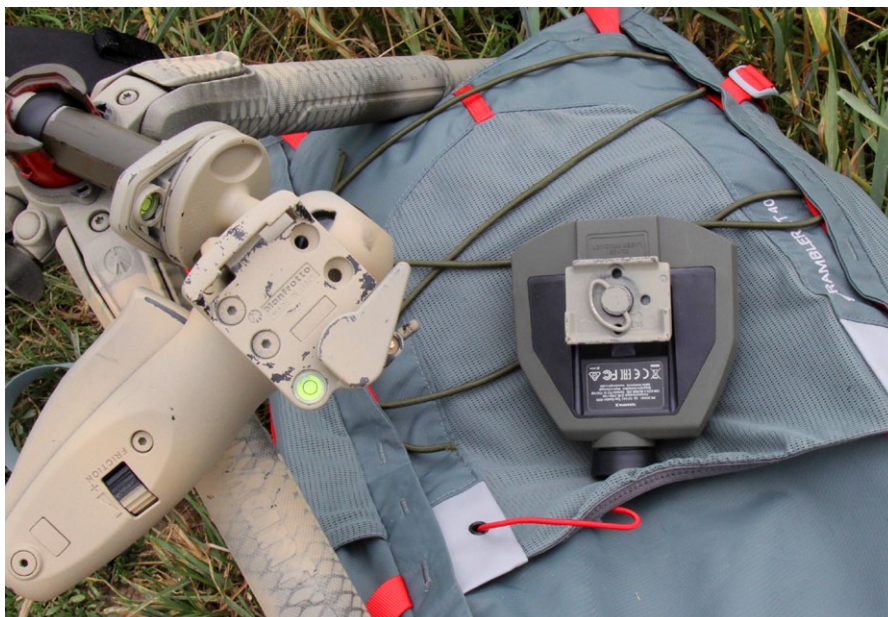
Der TERRAPIN X besitzt ein 1/4"-20 UNC Gewinde und kann handelsübliche Stativadapter aufnehmen
