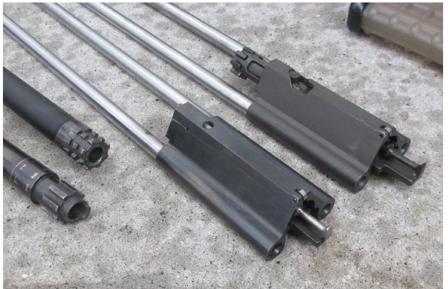
Verschlüsse und Läufe, links 9 mm und rechts .223 Rem
