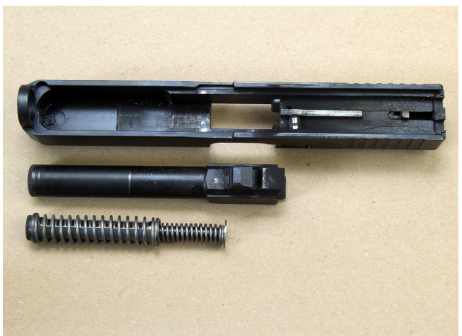
Nach 2.000 Schuss zeigte die Innenseite des Verschlusses deutliche Ablagerungen
