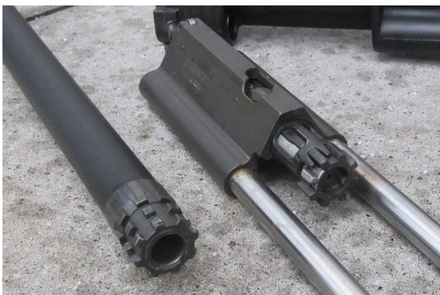
Im Gegensatz zum AUG-Z verfügt der Verschlusskopf des OA-UG über sieben Warzen
