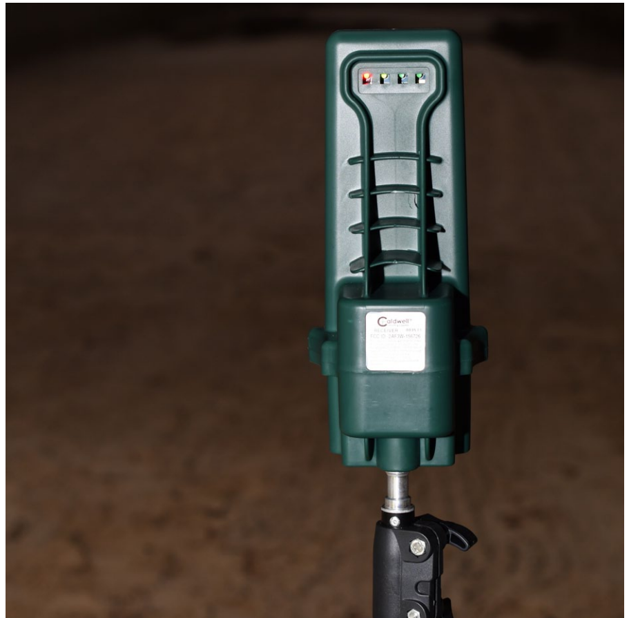
Grobe Ausrichtung des Empfängers auf den Sender
