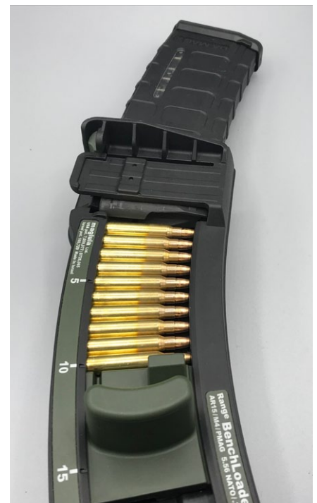
BENCHLOADER mit Patronen, darunter der geführte Schieber zum Hineindrücken der Munition in das eingesetzte Magazin.
