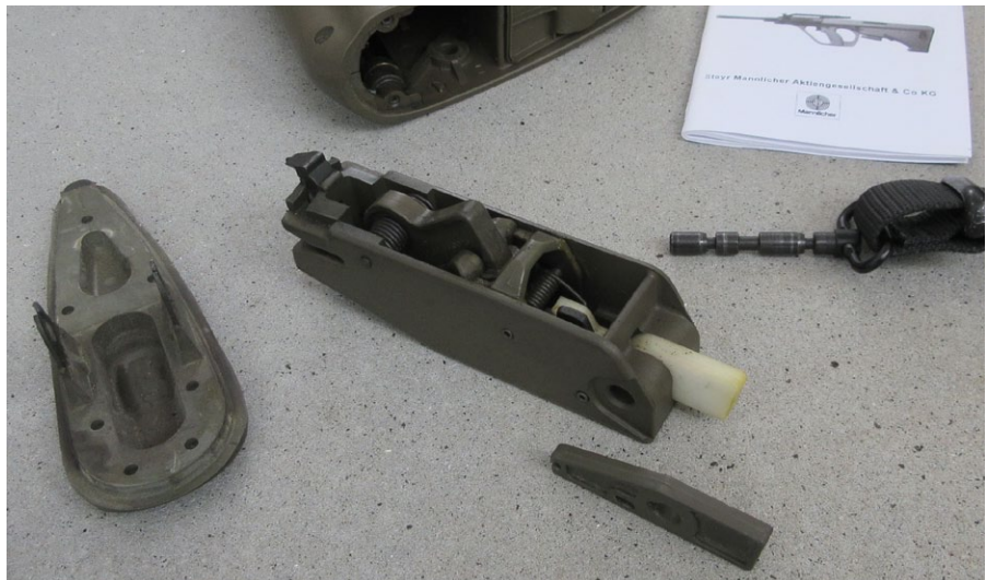
Schlagstückeinheit mit eingebautem Trigger Tamer (weiß). Davor das Originalteil (oliv)
