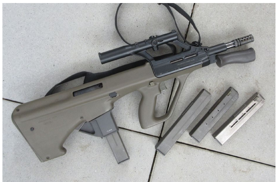
OA-UG mit MBH 9mm Wechselsystem und angeklapptem Vordergriff
