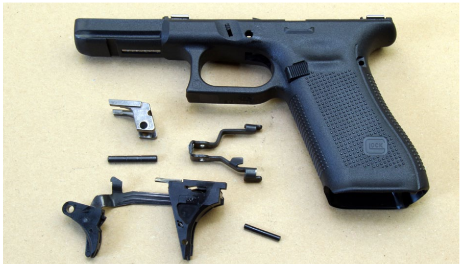
Griffstück komplett zerlegt. Im Vergleich zu vorhergehenden Generationen sind weniger Handgriffe erforderlich
