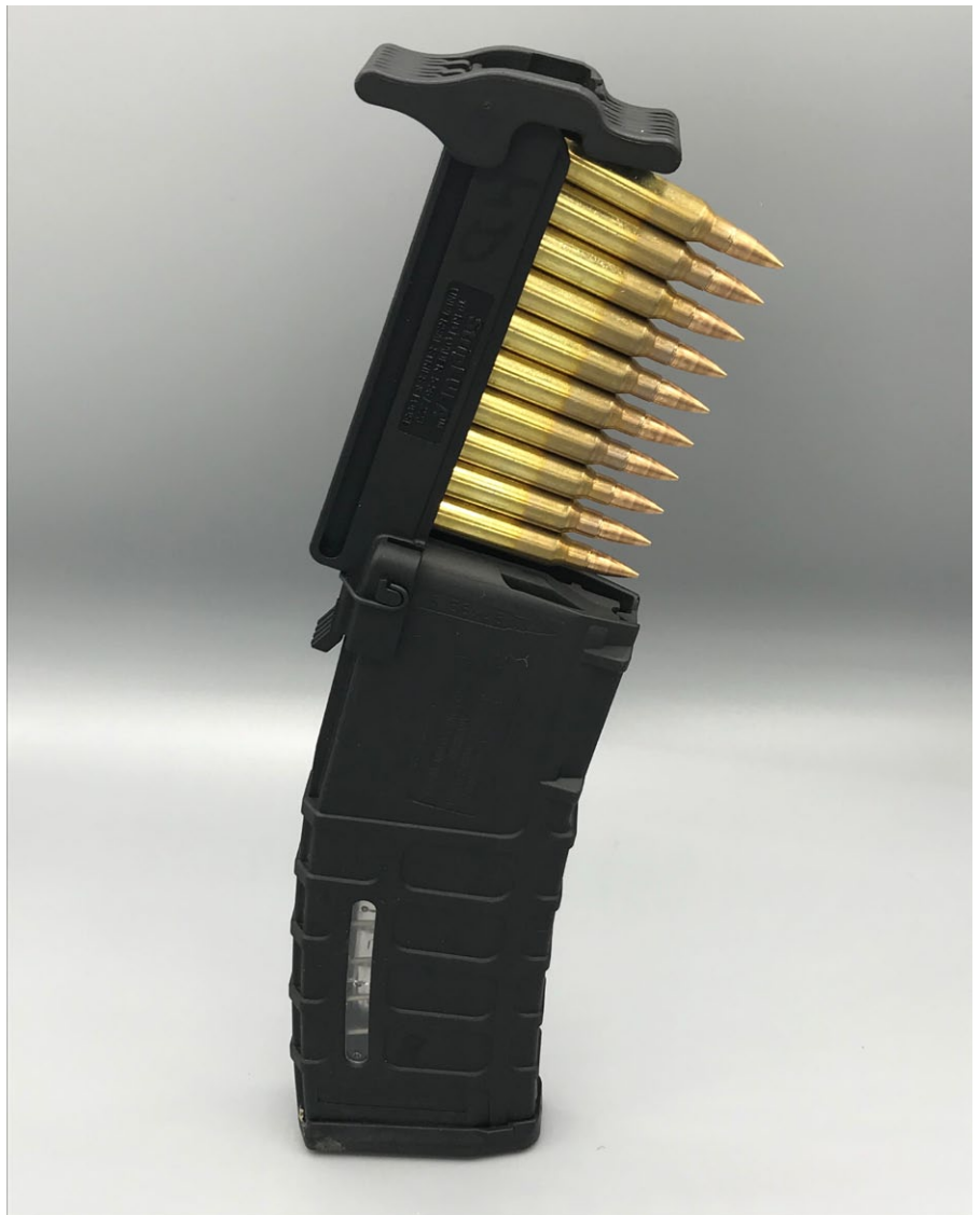
Aufgesteckter STRIPLULA mit eingesetztem Ladestreifen. Der Schieber ist bereits in die Ladeposition geklappt. Wird er in Richtung Magazin gedrückt, so schiebt er die Patronen vom Ladestreifen und in das Magazin.
