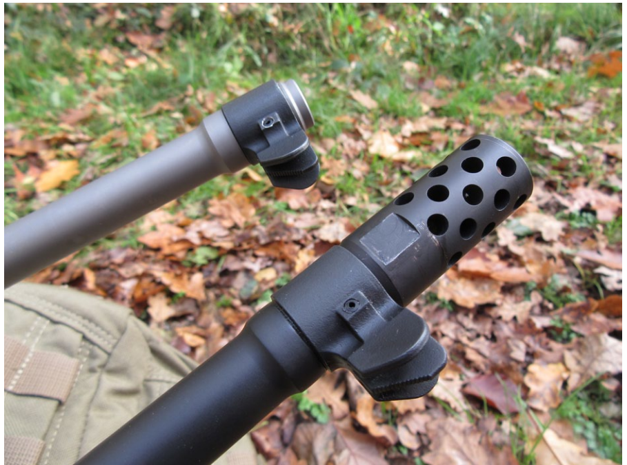
Die Kunststoffversion verfügt über ein 5/8x24 UNEF-Gewinde. Neben der Mündungsbremse liegt auch ein Gewindegewindenschutz der Waffe bei
