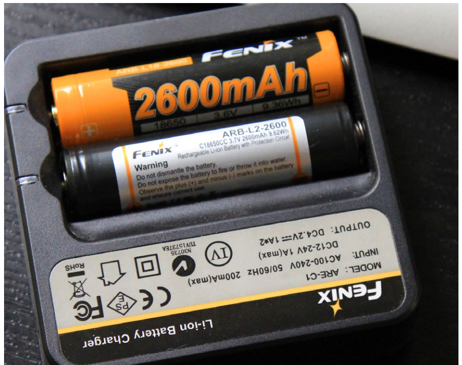
Fenix hat das Design der hauseigenen ARB-L2 Akkus geändert. Funktion und Einsatz bleiben unverändert. Die Bezeichnung 18650 bezieht sich übrigens auf die Maße mit 18 mm Durchmesser und 65 mm Länge.
