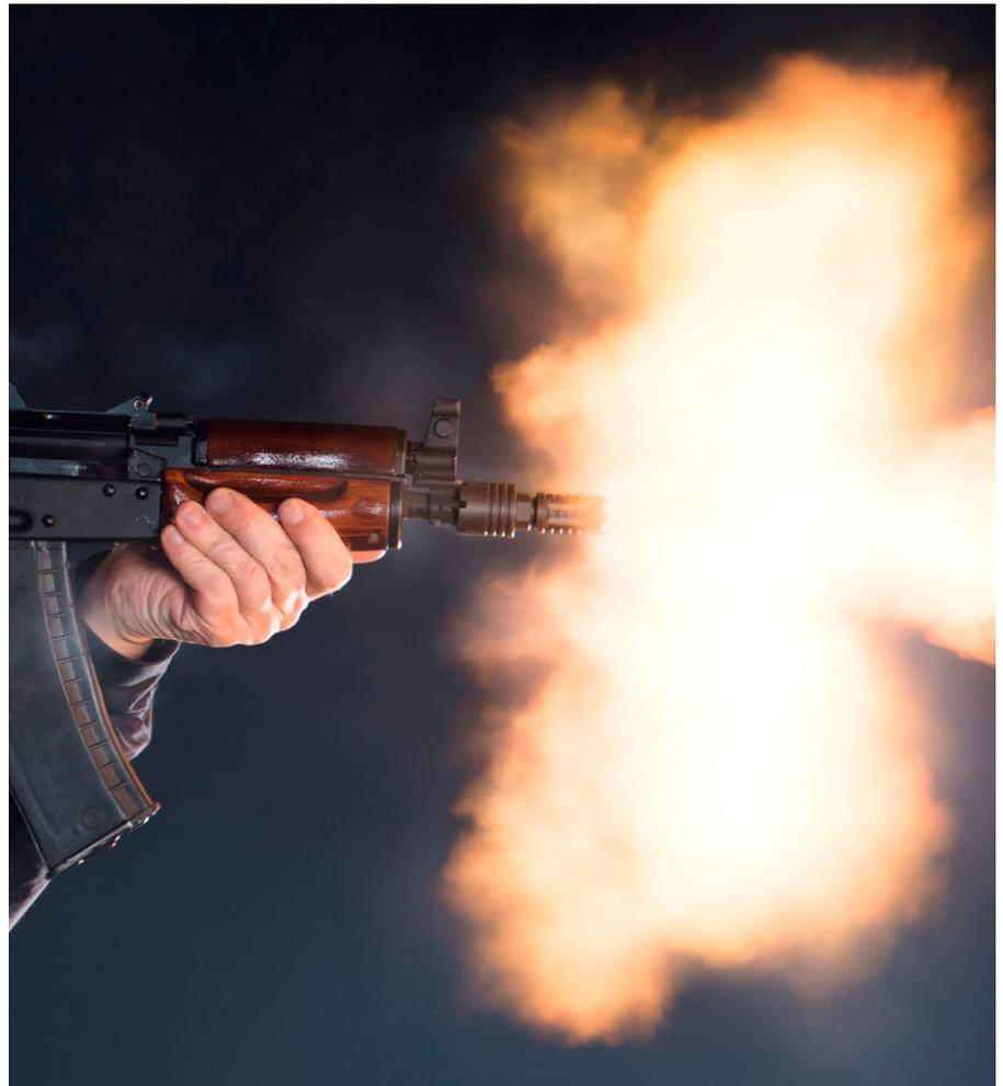
Bereits reduziertes Mündungsfeuer einer AKS-74U mit AKSU SOF Kompensator.
