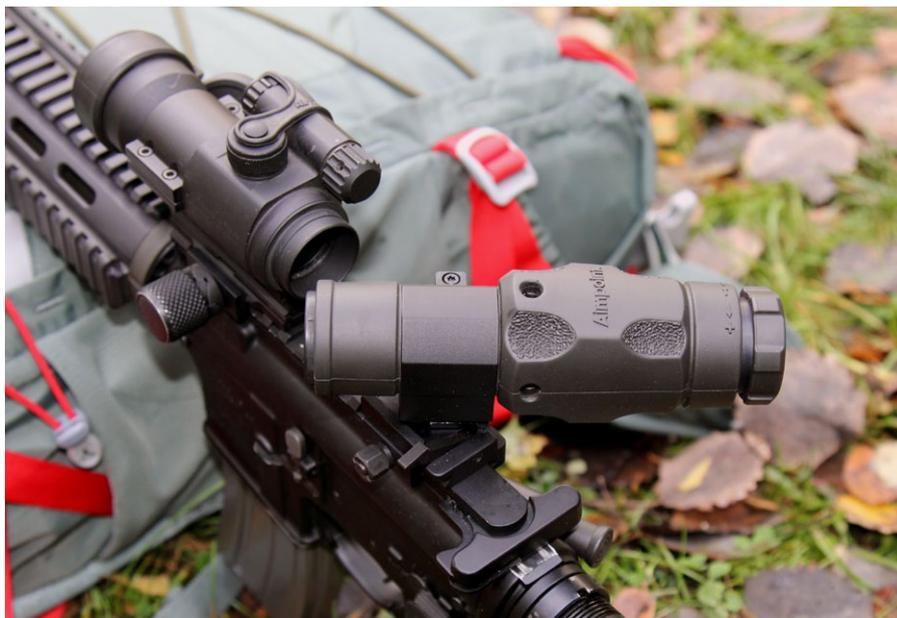
Der Magnifier aufgesetzt aber noch nicht eingeschwenkt. Gut zu erkennen die Bedienelemente am Magnifier: Höhen- und Seitenkorrekturschraube für die Positionierung des Leuchtpunktes und Drehung zur Dioptrienanpassung am Okular
