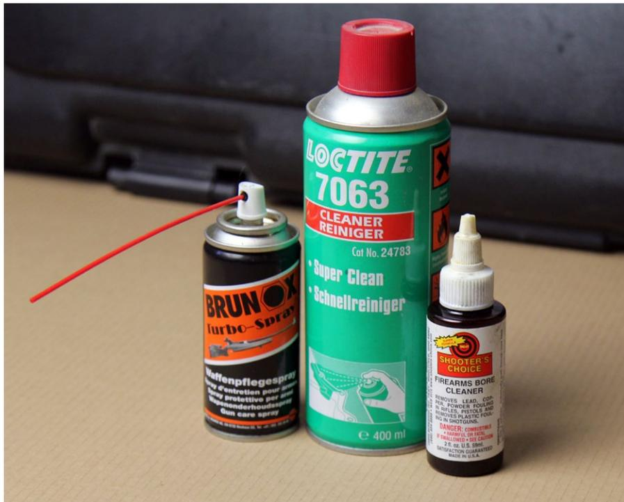
Zum Lösen von Pulverrückständen: BRUNOX-ÖL oder bei starker Verschmutzung Bremsenreiniger (ohne Duftnote). Um den Geschossabrieb aus dem Lauf zu entfernen kommt ammoniakhaltige Lösung (bspw. Shooter Choice) zum Einsatz
