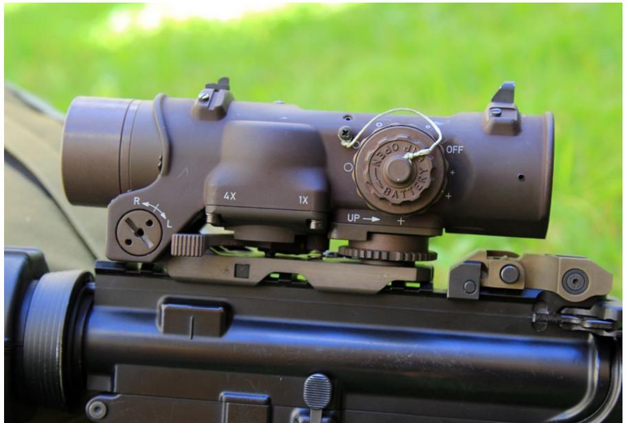
Die Seitenverstellung befindet sich am Gerät vorn und kann mit einer Münze oder Patronenhülse bedient werden. Das Stellrad für die Höhe ist ohne Werkzeug handhabbar. Es kann über eine Sperrklinke fixiert werden. Der Umschalthebel von 4x zu 1x ist intuitiv mit dem Daumen bedienbar.
