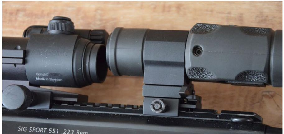
Flipmount mit Twistmount Base. Gut zu erkennen der federbelastete Entriegelungshebel. Der Höhenunterschied von Comp M2 und Magnifier wird intern ausgeglichen
