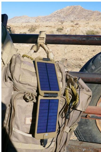
Befestigung des Solarmoduls am Rucksack
