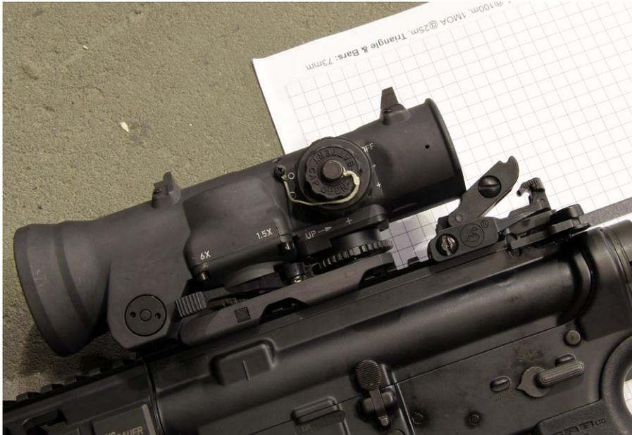
Vorsicht Falle: Wird eine federgelagerte Klappkimmer versehentlich ausgelöst, drückt diese von unten gegen das ELCAN. Eine erhebliche Treffpunktverlagerung ist hier die Folge.
