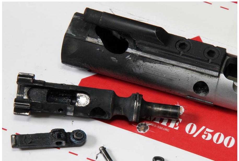
Bei jeder zweiten Detailreinigung sollte die Ausziehkralle am Verschlusskopf entfernt werden, um den Schlagbolzenkanal zu säubern. Auch die Ausziehkralle selbst sollte von Messingresten und Schmauch befreit werden
