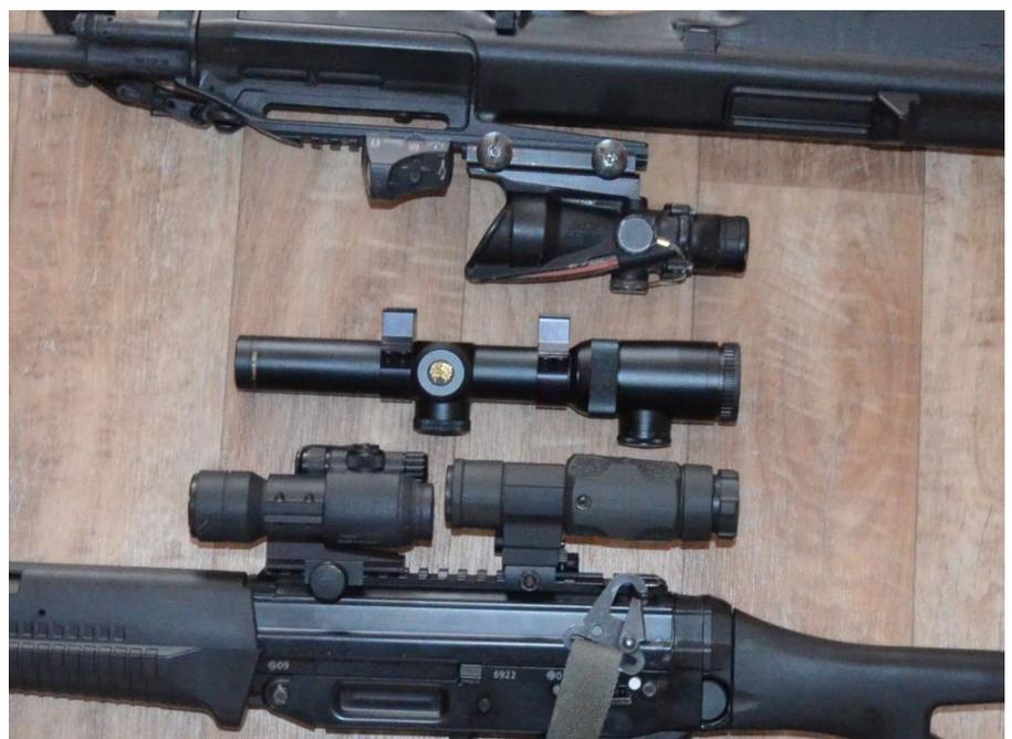
Vergleich des Platzverbrauches auf der Picatinny-Schiene von Aimpoint + Magnifier, variablem ZF und fixem ZF mit versetztem Leuchtpunktvisier
