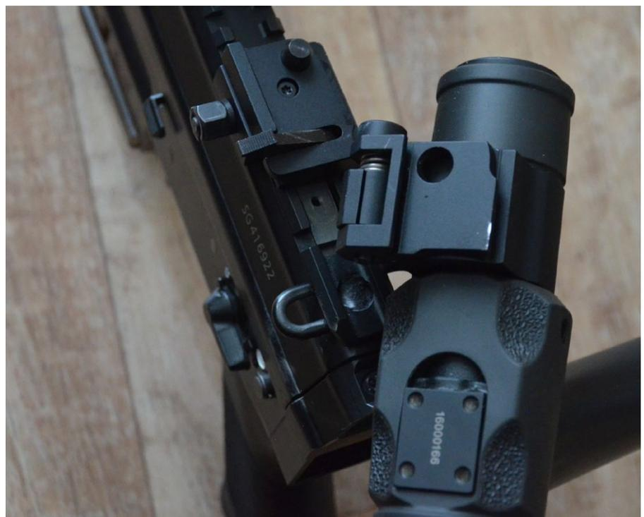
Blick von oben auf die Twistmount Base und von unten auf den Flipmount. Der Magnifier wird zur Montage auf den Zapfen gesetzt und eingeschwenkt
