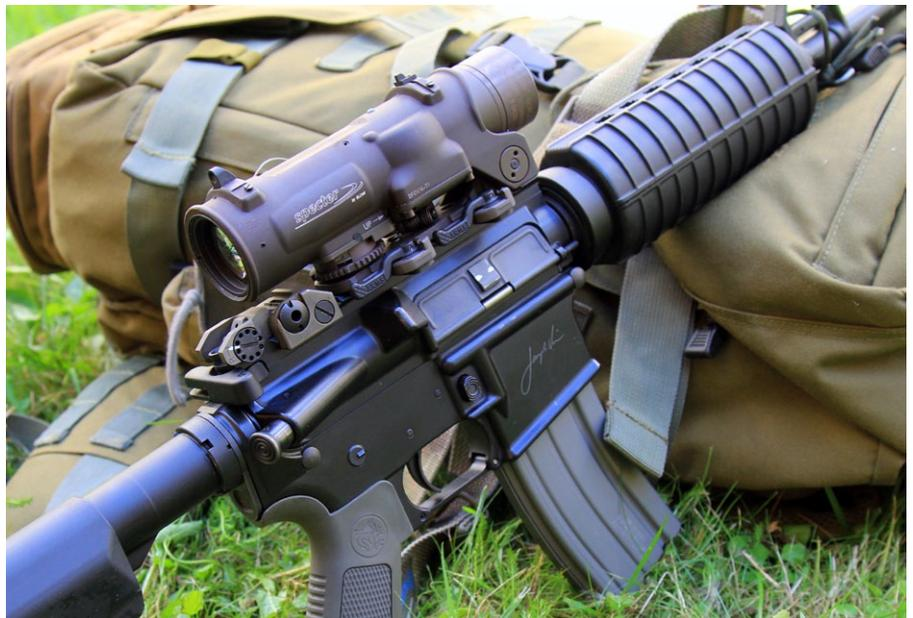
Bei ELCAN Zieloptiken ist eine Spannmontage von ARMS grds. inkludiert. Bei einem Zielfernrohr müsste sie extra beschafft werden. Die Sperrklinke der Höhenverstellung ist im Bild entriegelt.
