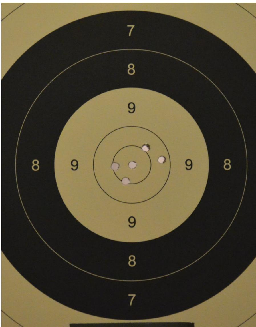
Parallaxetest auf 25 m. Geschossen wurde mit gerade noch sichtbarem Leuchtpunkt bei riesigem Schatten im Sehfeld - dieses Fehlermaß kann kein Schütze übersehen
