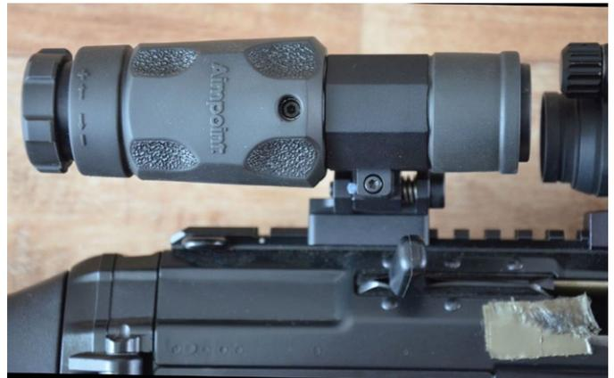
Blick auf den Spannhebel eines Sig 551 Sport mit vor- und weggeklapptem Magnifier. Weder Magnifier noch Flipmount ragen im weggeklappten Zustand weiter in den Weg des Spannhebels
