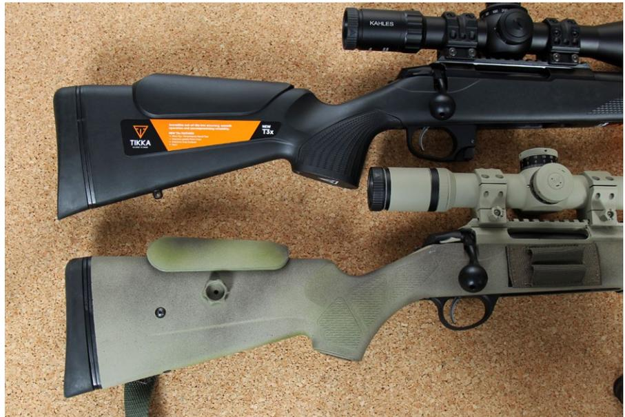
Die höhenverstellbare Schaftbacke ist optional, nicht jede T3x CTR besitzt eine. Das ist aber weder Mangel noch Nachteil. Solange das Zielfernrohr tiefst möglich montiert wird, ist eine entspannte und reproduzierbare Kopfposition machbar.
