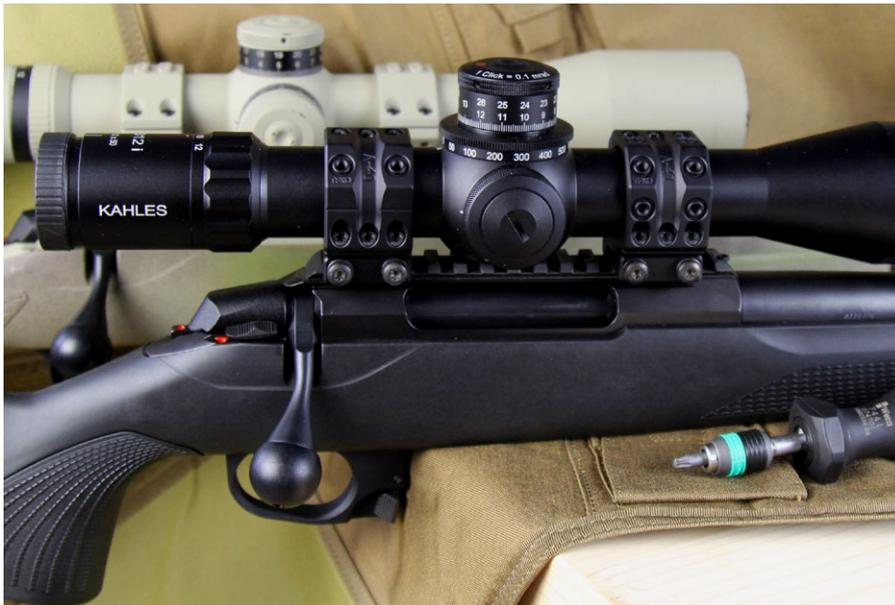
Schrauben an einer ZF-Montage sollten grds. mit einem Drehmomentschrauber angezogen werden.
