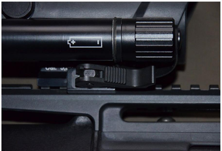
Der Verschluss der Schnellmontage im Detail. Der geriffelte Part wird zur Entriegelung nach vorne geschoben, dann kann der Hebel nach hinten geschwenkt werden.
