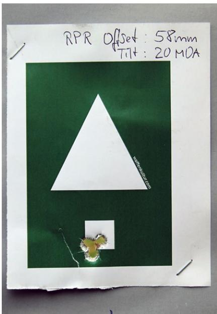
25 Meter: Ein Tiefschuss von 29 mm erzeugt einen Fleckschuss auf 100 Meter
