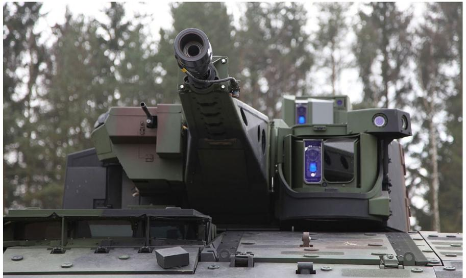
Der Mittelkaliberturm LANCE könnte die Feuerkraft des BOXER deutlich erhöhen (Foto - Rheinmetall Defence)
