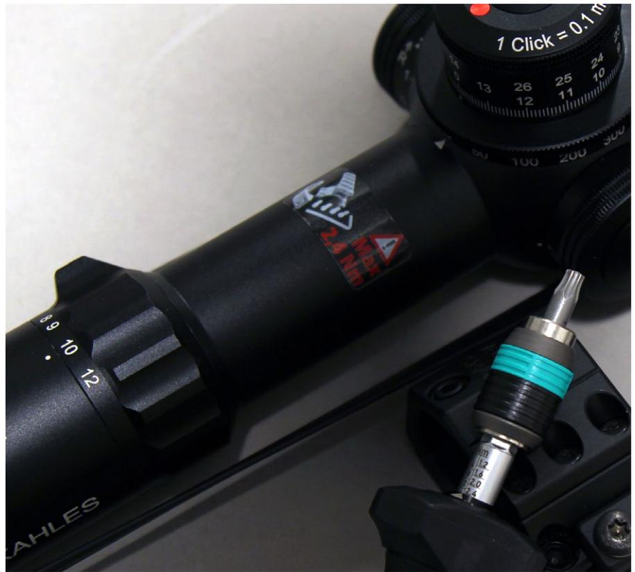
ZF-Hersteller Kahles gibt ein max. Drehmoment von 2,4 Nm für die Ringkappen der ZF-Halterung vor. Am WERA Drehmomentschlüssel kann dieser Wert exakt eingestellt werden.
