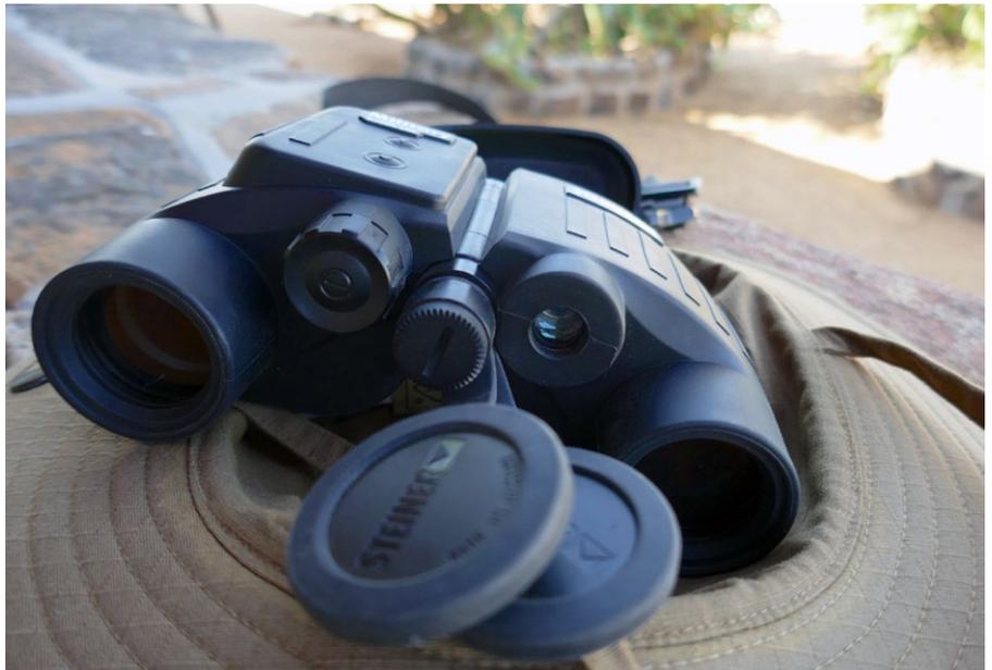
Die Gummistaubkappen der Objektivseite. Zu sehen sind weiterhin die Laser-Messoptik (im Bild rechts) und der Deckel des Batteriefaches (im Bild links)
