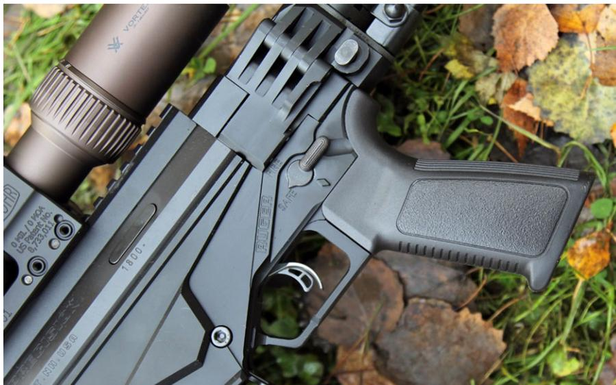
AR-15-like: Die Sicherung ist beidseitig einsetzbar, der Abzug ab Werk phänomenal und das Griffstück kann gegen alle AR-15 Griffe ausgetauscht werden
