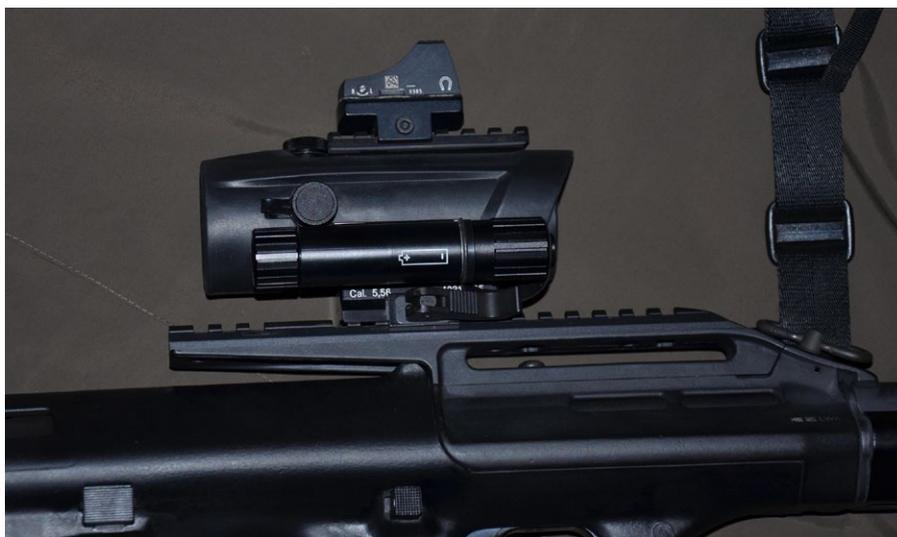
ZO 4x30i montiert auf einem Steyr AUG-Z. Als alternative Visierung, u.a. für das Schießen von der linken Schulter, ist ein Docter Sight Gen. 3 aufgesetzt.
