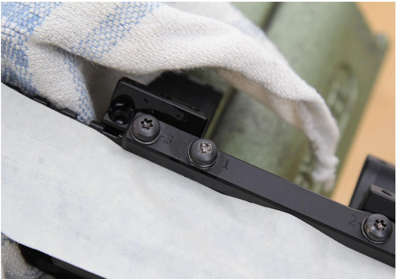
Ein wahrer „Innensechsrund“ ist entstanden. Beim Versuch eine Montage feldmäßig zu lösen, ist der Anwender abgerutscht. Die Schraube ist nach wie vor fest-fest.
