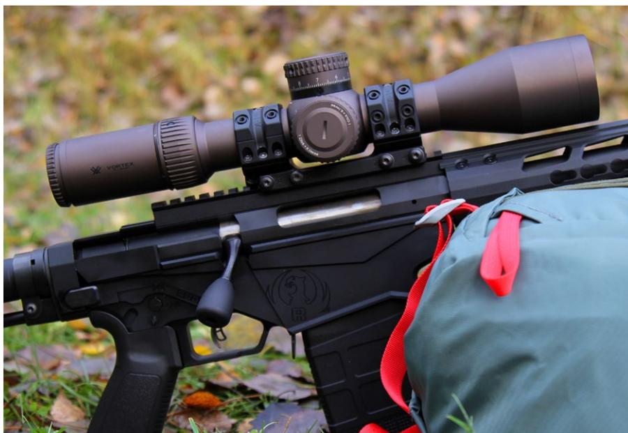
So tief wie möglich: Mit einem 56-mm-Objektiv wäre mit der gewählten Montage vermutlich nicht mehr genug Spielraum zum Vorderschaft. Zielfernrohre mit 50-mm-Objektiv passen problemlos
