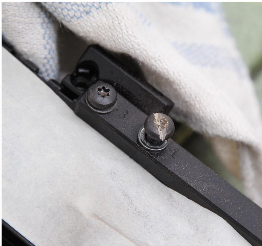
Mit einem Schlitzschraubendreher entsprechender Größe kann die Schraube jetzt gelöst werden. Das ist die letzte Option, die ein Anwender hat, bevor die Schraube aufgebohrt werden müsste. Wobei Beschädigungen an ZF-Montage bzw. Picatinny-Rail der Waffe nicht auszuschließen sind.
