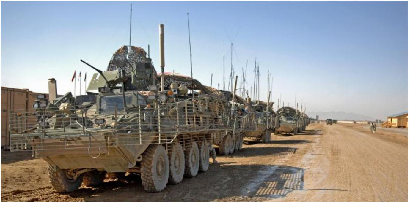
Für den Einsatz in urbanem Gelände werden die Fahrzeuge mitunter stark modifiziert - Stryker ICV mit Käfigpanzerung gegen Panzerabwehrraketen und Jammerantennen gegen Sprengfallen
