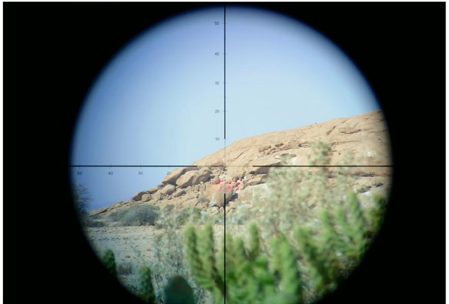
Blick durch das Steiner 8x30 LRF während einer Messung. Zu sehen ist die Strichplatte sowie das Messergebnis von 1.083 m. Die Aufnahme ist mit einer handgehaltenen Kamera gemacht. Die Lesbarkeit der Entfernungsangabe ist bei Durchblick gut und besser als auf dem Foto
