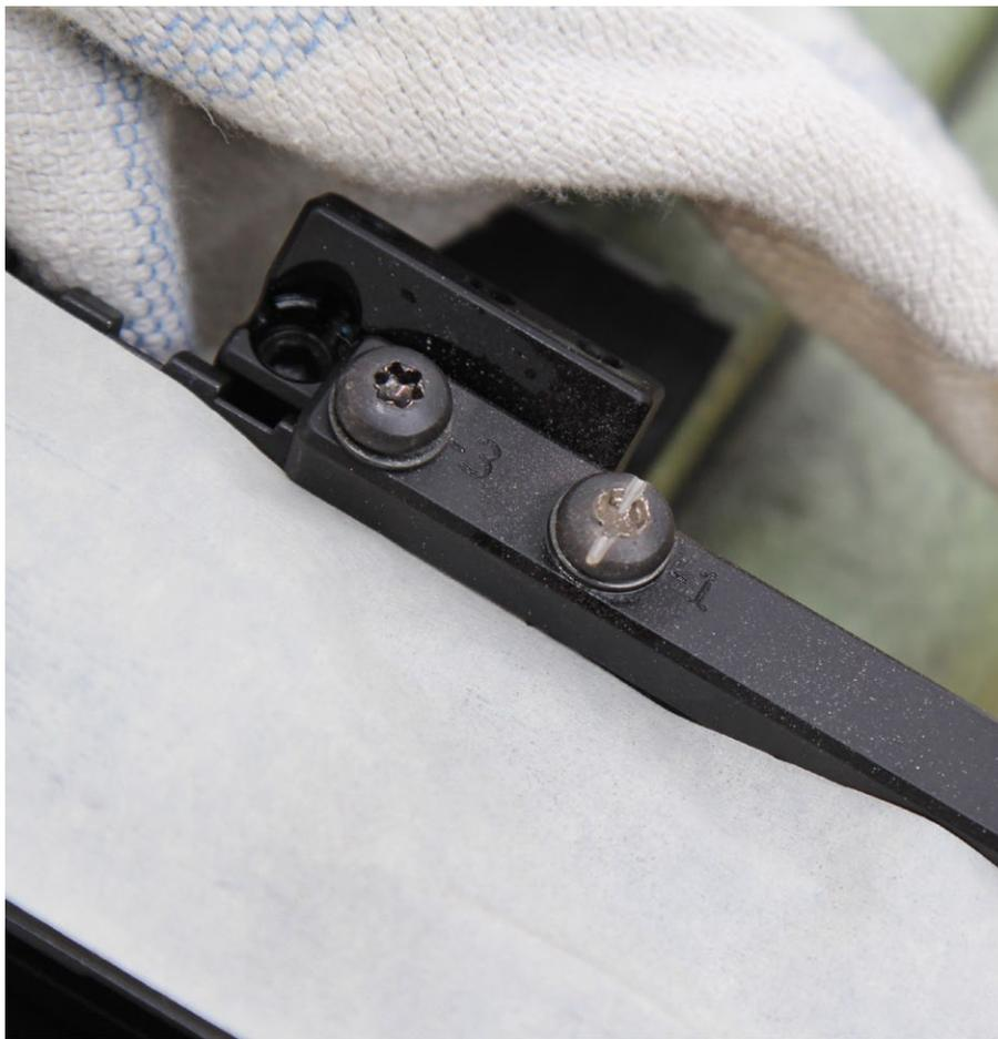
Um eine Kraftübertragung überhaupt wieder möglich zu machen, wird ein Schlitz in den Schraubenkopf gefräst.
