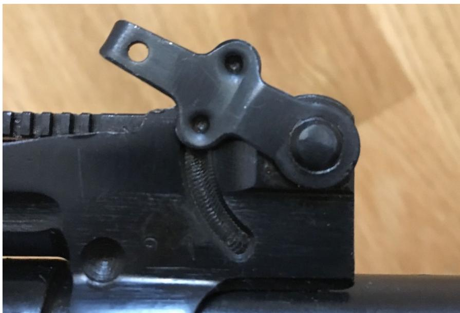
Zerlegehebel des Gassystems in seiner ersten Öffnungsposition: Das Gasrohr samt Gaskolben kann entnommen werden, während das unter Federspannung stehende zweite Teilstück des Gasgestänges weiter im Block unterhalb des Zerlegehebels gehalten wird. Erst eine weitere Rotation des Hebels nach rechts gibt es frei.
