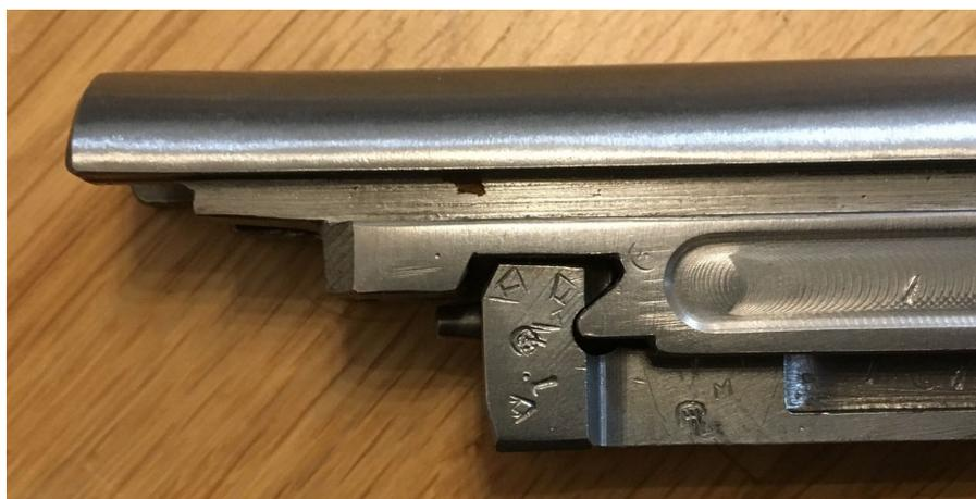
Verschlussträger mit Verschluss in entriegelter Position.
