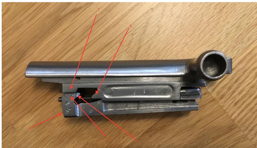
Verschluss und Verschlussträger in verriegelter Stellung: Der am hinteren Ende des Verschlussträgers ausgeformte Vorsprung (1) hat beim Vorlaufen den hinteren Absatz (2) des Verschlusses nach unten gezwungen und hält ihn in dieser Position. Beim Zurücklaufen greift die hakenförmige Steuerfläche (3) des Verschlussträgers in ihr Gegenstück (4), zwingt dadurch den Verschluss mit seiner Abstützfläche (5) am hinteren Ende nach oben und hebt dadurch die Verriegelung auf.
