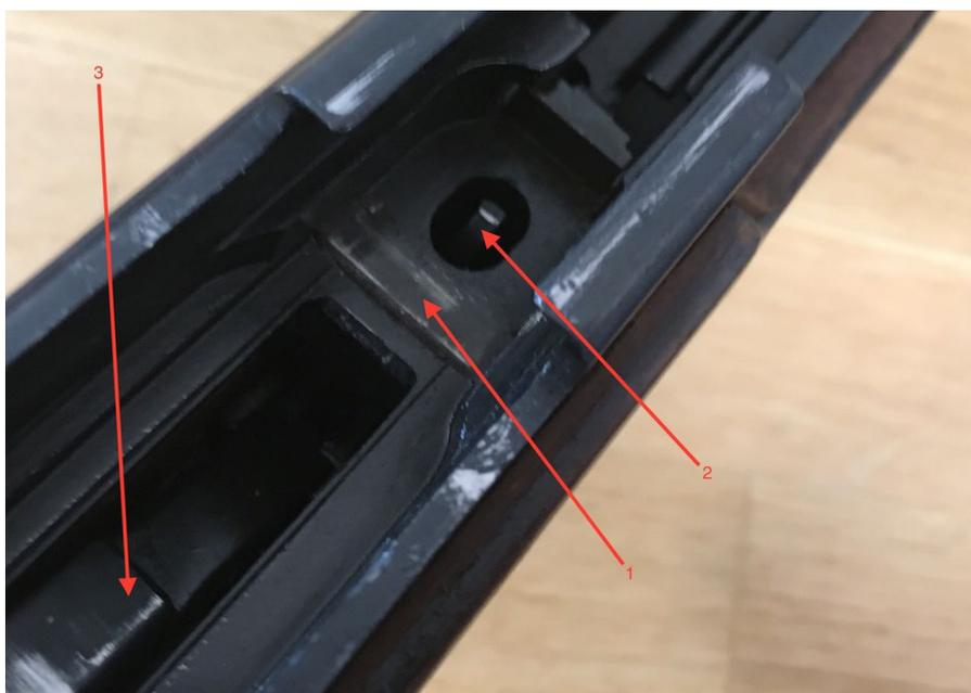
An der Vorderkante des quadratischen Querbolzens (1) stützt sich der Verschluss nach hinten in verriegelter Stellung ab. Das obere Ende der Steuerstange (2) sorgt dafür, dass der Hammer (3) nur bei verriegeltem Verschluss ausgelöst werden kann. Oben rechts sind der Zubringer und der starre Auswerfer zu sehen.
