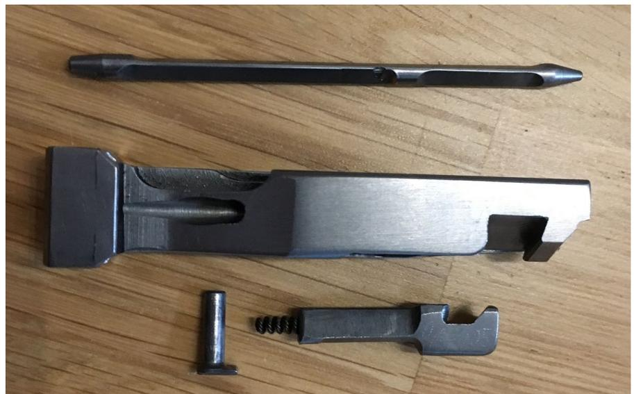
Der zerlegte Verschluss. Beim Zusammenbau ist unbedingt auf die richtige Einbaulage des Schlagbolzens zu achten.
