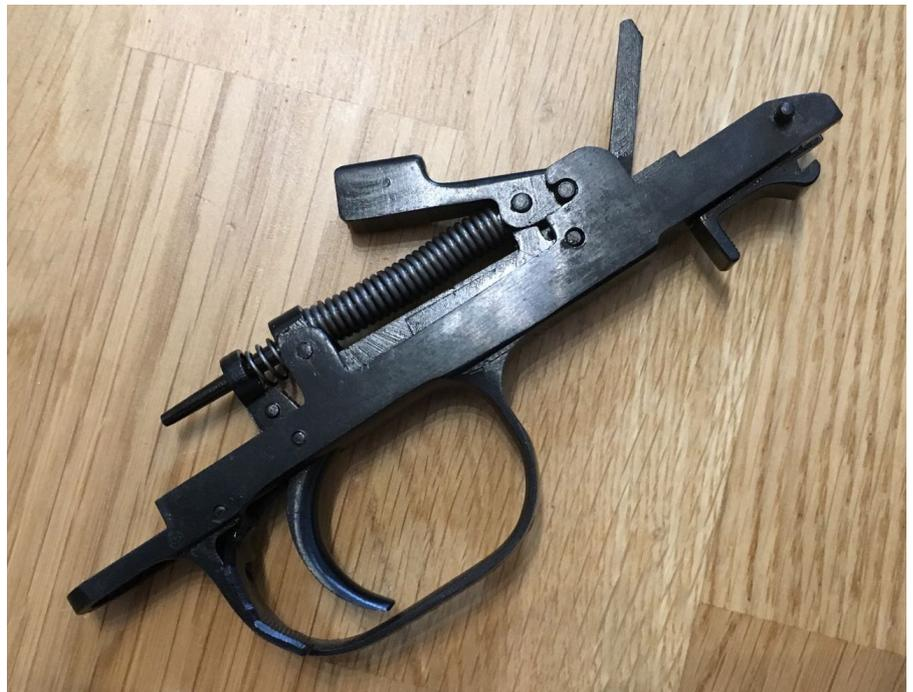
Abzugseinheit mit gespanntem Hammer und der charakteristisch nach oben ragenden Steuerstange.
