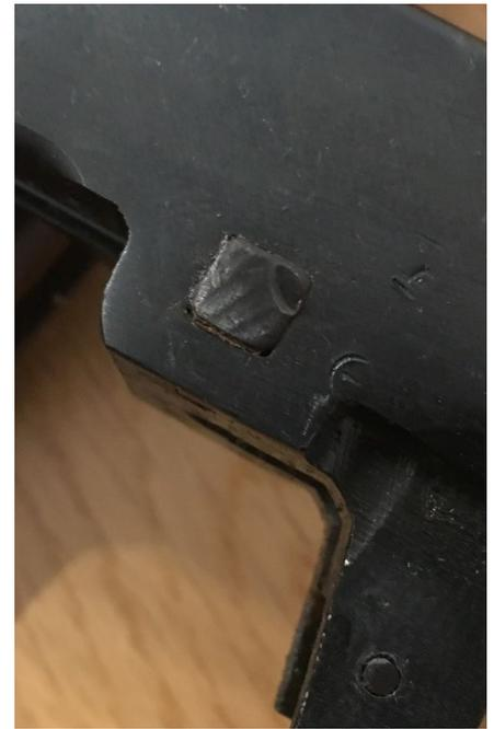
An dem quadratischen Bolzen in der Bildmitte stützt sich der Verschluss in verriegelter Stellung ab.
