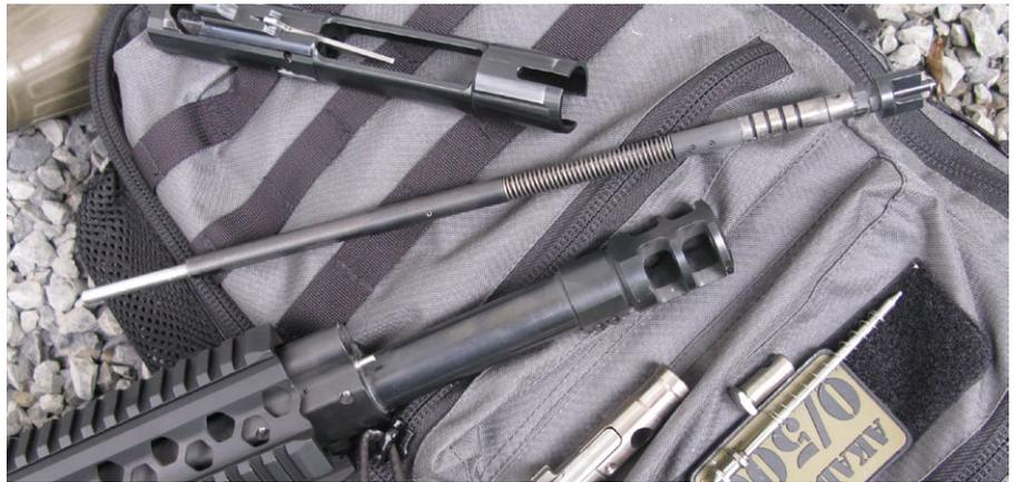
Die Antriebsstange kann komplett mit Feder und Gaskolben ohne Demontage des Vorderschafts nach vorne aus dem Gasblock gezogen werden. Mit dieser Konstruktion können bei der Reinigung im freien keine Kleinteile verloren gehen.
