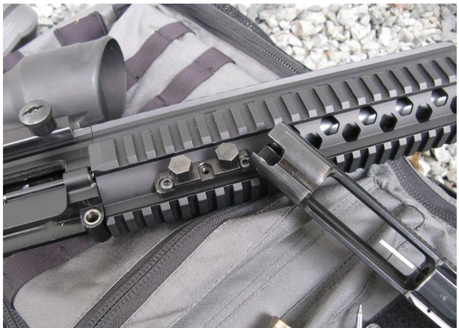
Auf der gegenüber liegenden Seite des Verschlussträgers liegt eine Nut zum Lösen der beiden Schrauben, die den Vorderschaft fixieren.
