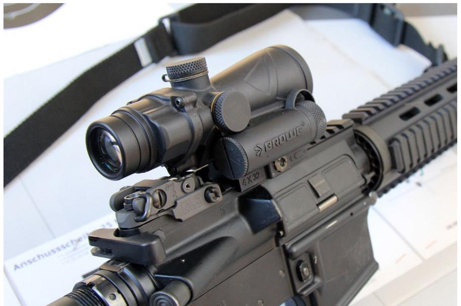
Optiken mit einer permanenten 4-fach Vergrößerung bieten Vorteile bei der Zielerkennung bei größeren Entfernungen. Meist besitzen sie auch ein ballistisches Absehen, so wie das BROWE BCO 4x32.
