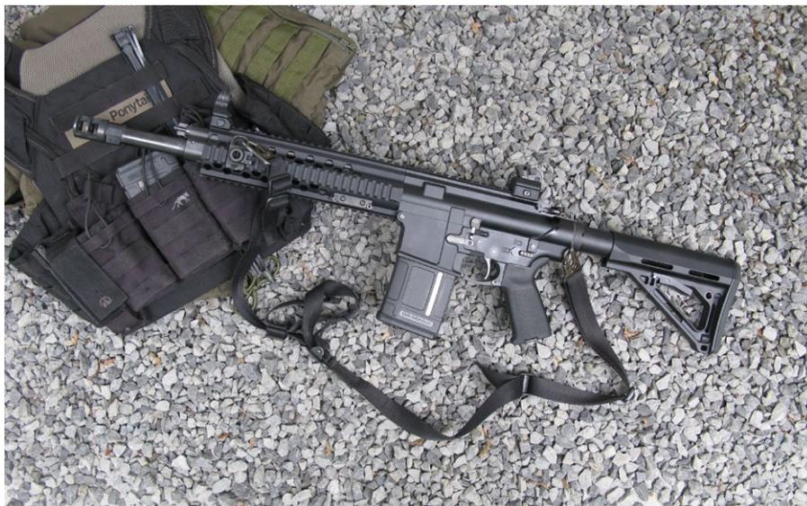
Die BR10 mit HK-typischer, offener Visierung. Bei der verstellbaren Lochkimme und Ringkorn von Centurion Arms befindet sich jedoch im Gegensatz zum Produkt von H&K die Visierlinie auf gleicher Höhe wie das AR-15-Korn. Die Riemenbefestigung ist alternativ mit QD-Riemenbügeln auch am Schubschaft möglich.
