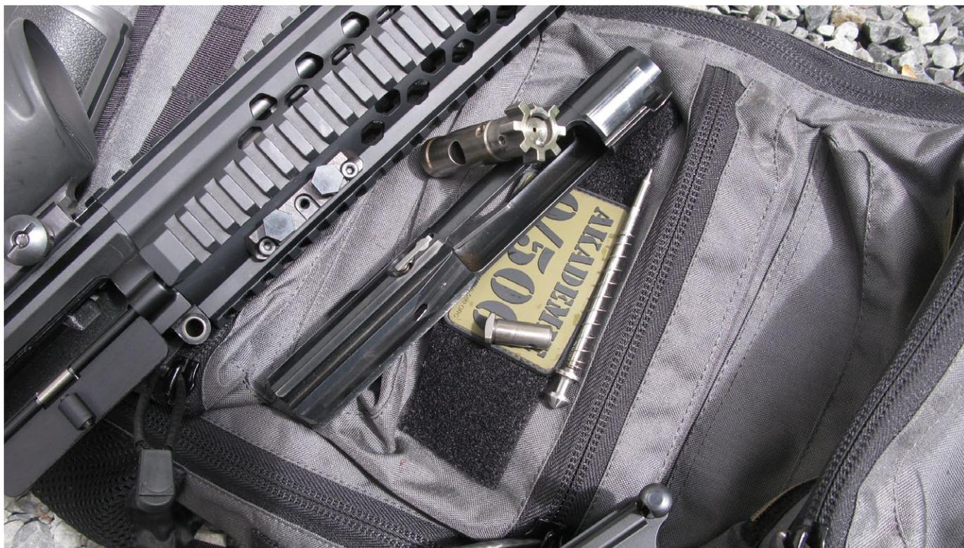
Verschlussträger mit Verschlusskopf und Schlagbolzen. Wie bei anderen AR-10 Modellen ist der Schlagbolzen gefedert gelagert.
