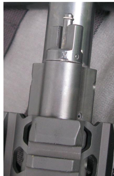
Das X auf der verstellbaren Gasentnahme markiert die Stellung mit komplett verschlossener Gasbohrung.
