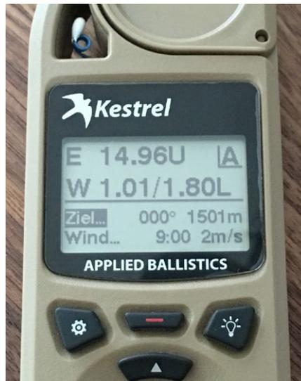
Die wichtigsten Daten im Überblick. Sind alle Daten erfasst, lassen sich mit dem Kestrel schnell die notwendigen Klicks zur Korrektur berechnen. Lediglich Wind, Windrichtung und Entfernung sind einzugeben. Für die Entfernung lässt sich auch mit Tabellen arbeiten, sodass schnell und ohne neue Eingaben auf Veränderungen reagiert werden kann.
