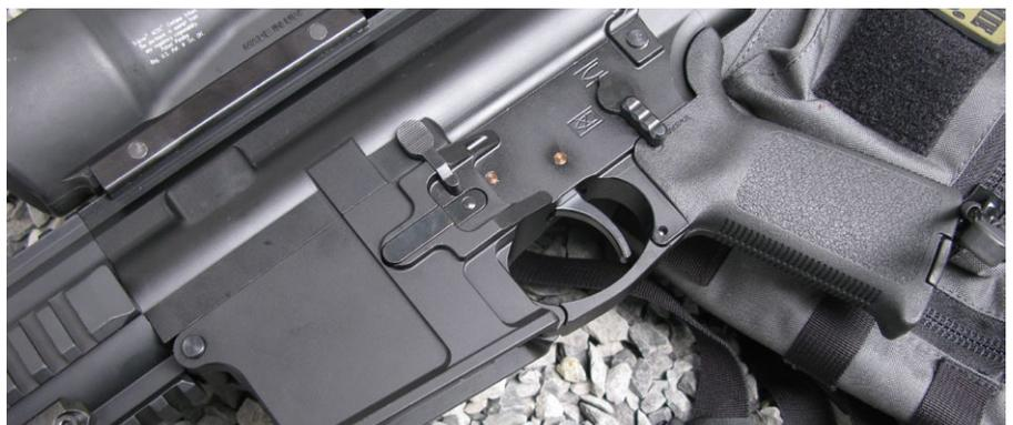
Der Abzugsbügel ist untypisch nach vorne klappbar. Die Lage der Bolzen des Abzugs entspricht dem HK MR308.
