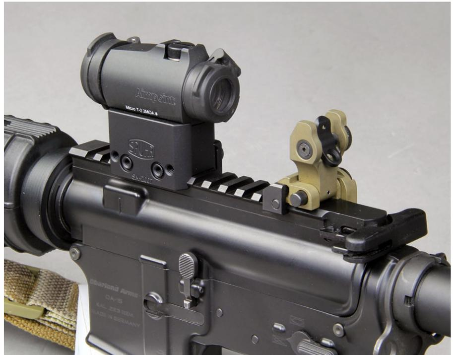
Bei der Montage einer Rotpunktoptik gibt es zwei Varianten in der Bauhöhe: Der sog. „Full Co-Witness“ oder der „1/3 Co-Witness“, bei dem Rotpunkt und offene Visierung nicht auf einer Ebene liegen. Hier sollte der Anwender entscheiden, was ihm beim Schießen besser liegt.
