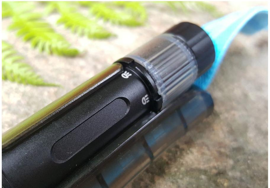
Lichtverteiler: Die Rotationslinse bietet zwei Positionen, ist aber etwas schwergängig
