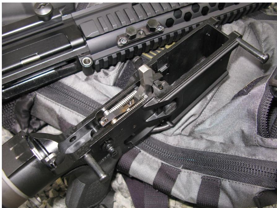
Die Abzugseinheit mit den beiden Federn und dem einstellbaren Triggerstop. Ein Nachjustieren des bereits werkseitig ideal eingestellten Abzugs ist nicht notwendig.
