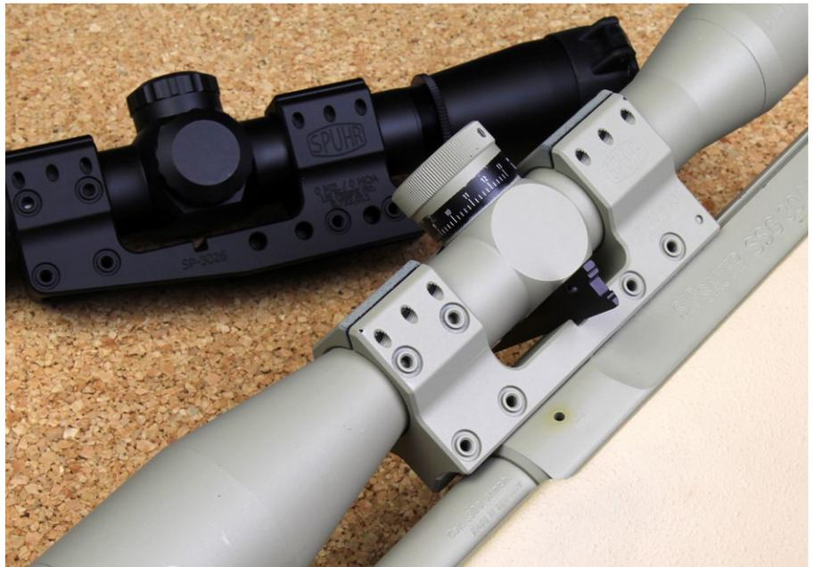
Die Ausrichthilfe wird in die korrespondierende Aussparung der Blockmontage gelegt. Das Zielfernrohr ist ausgerichtet, wenn die Oberkante der Ausrichthilfe bündig mit der Unterkante des ZF verläuft.
