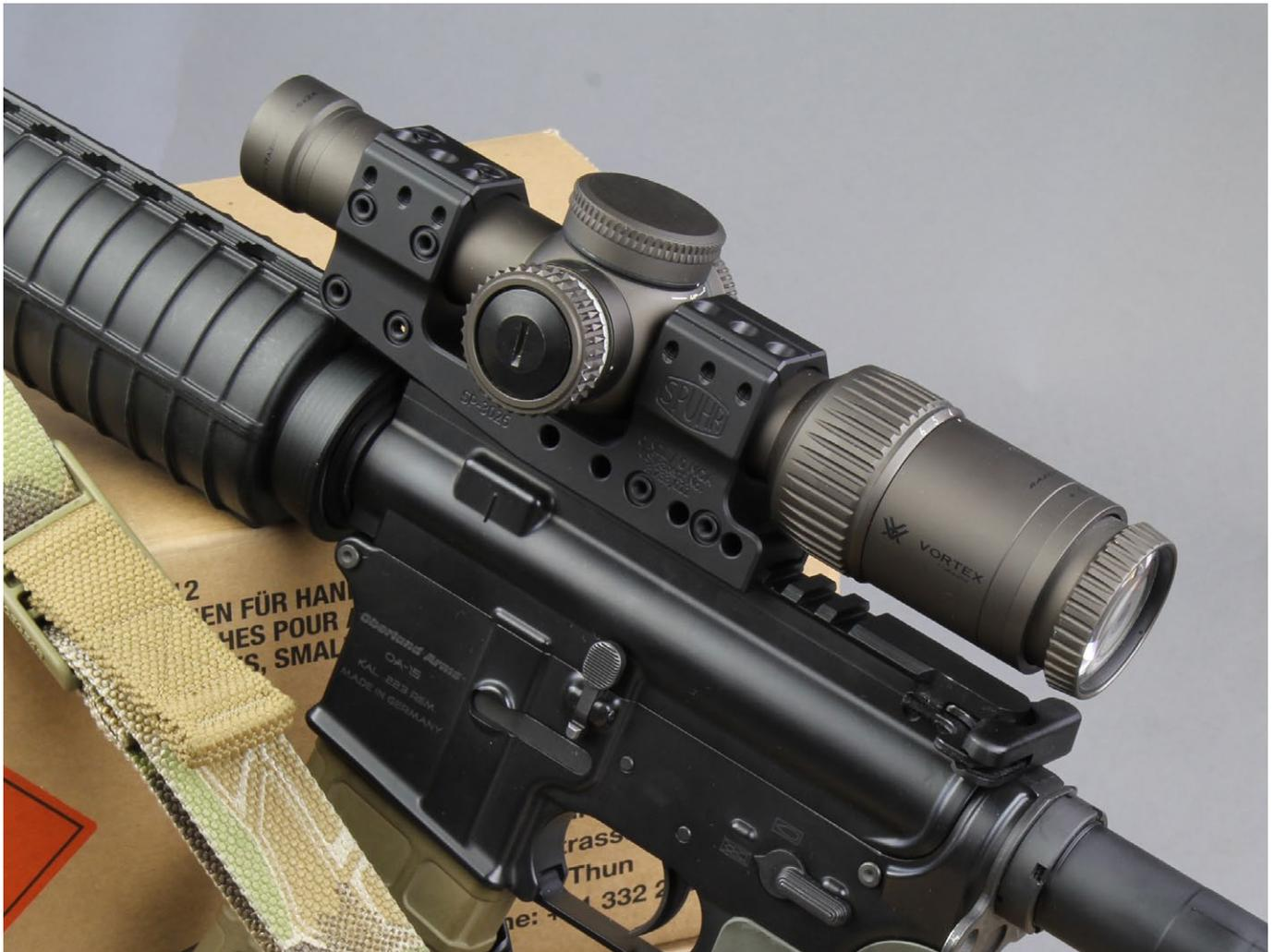
Das Vortex 1-6x24 Razor HD gehört zur Gruppe der Zielfernrohre mit variabler Vergrößerung. Neben dem ZF muss zusätzlich noch eine ZF-Montage erworben werden.
