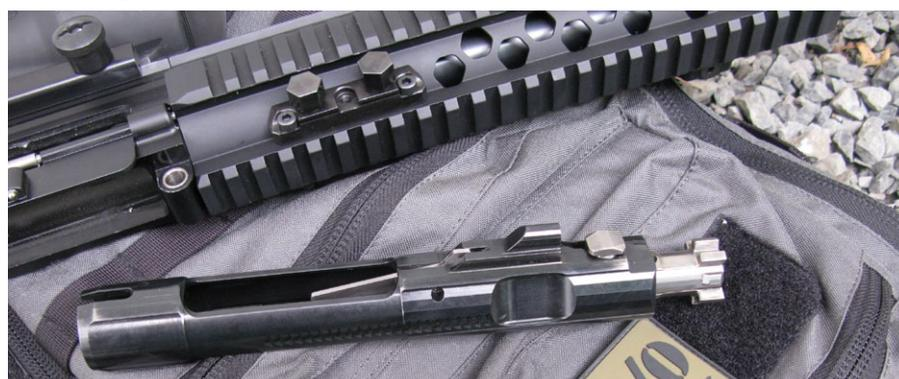
Der Verschlussträger komplett montiert. Oben die Nase der automatischen Schlagbolzensicherung, die nach Betätigen des Abzuges durch das Schlagstück deaktiviert wird.
