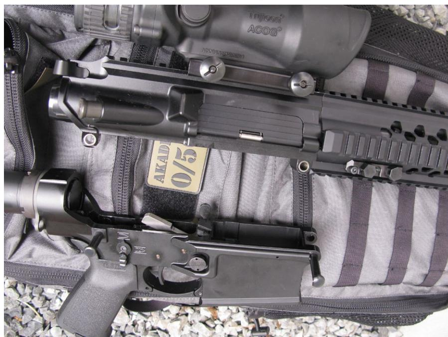
Gehäuseober- und Unterteil bestehen aus einem hochfesten Duralgehäuse. Im Gehäuseoberteil sind Stahlbüchsen eingelassen.
