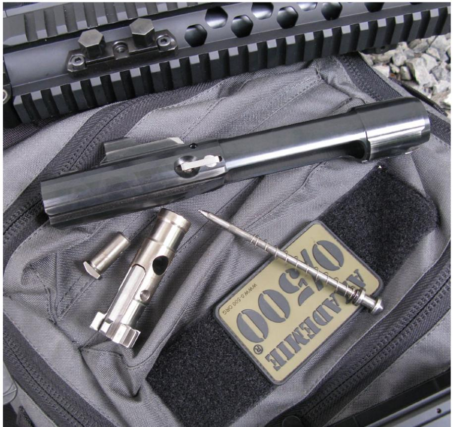
Zerlegter Verschluss. Nach dem Eindrücken der federgelagerten Wippe wird der Schlagbolzen freigegeben. Der AR-15-typische Splint wird nicht benötigt. Verschlusskopf, Steuerbolzen und Schlagbolzen sind Plasmanitriert. Der Verschlussträger ist im QPQ-Verfahren Teniferbehandelt.
