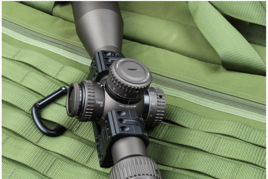
Der Parallaxenausgleich arbeitet in „Yards“. Nach der ersten Umdrehung des Höhenturms zeigt sich ein kleiner Zapfen.
