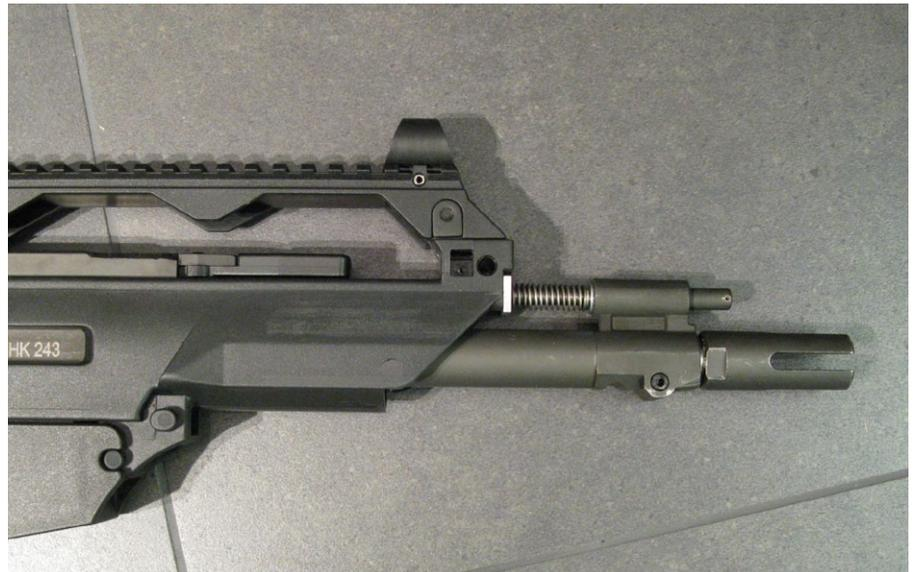
Vorderschaft demontiert: Zu sehen ist die neugefertigte Antriebsstange mit dem kleinen Abstützblech am Gehäuse
