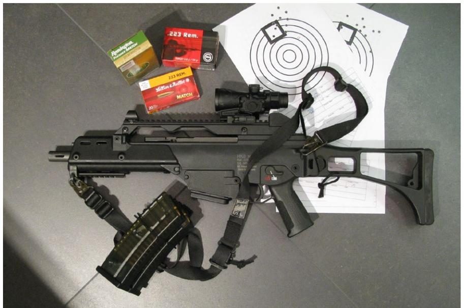
Ausgestattet mit einer 4x32 Browe Tactical Optic BTO lieferte die Kurzversion Streukreise von 5 bis 6 cm auf 100 m. Die Bohrung in der Montage des BTO erlaubt einen Co-Witness mit der offenen Visierung
