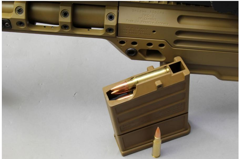
Made in Bavaria. Das zweireihige Kunststoffmagazin fasst 15 Patronen und führt über die Mitte zu. Außerdem im Bild zu sehen, die vier verlustsicher integrierten Klemmschrauben, welche beim Laufwechsel gelöst werden müssen.
