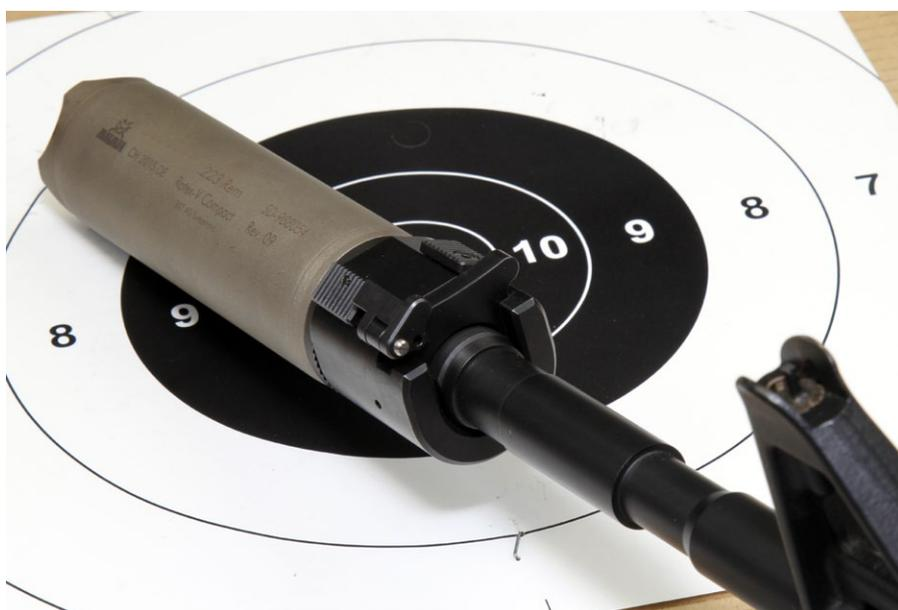
Kupplungsschieber und Sicherung geschlossen
