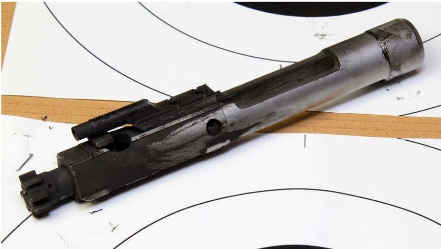
Verschlussbaugruppe eines AR-15 nach etwa 200 Schuss mit dem Rotex-V Compact
