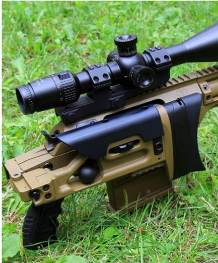
Im abgeklappten Zustand sichert der Schaft den Kammerstengel.
