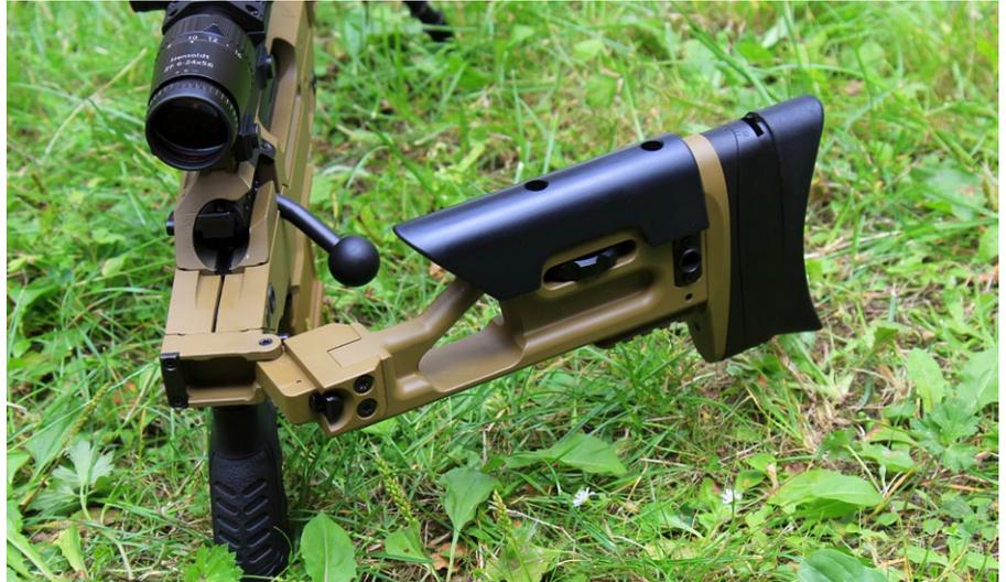
Die Schulterstütze ist nach rechts abklappbar. Schaftlänge, Schaftbackenhöhe und Schaftkappenwinkel und -höhe sind frei verstellbar. Eine Picatinnychnittstelle erlaubt das Anbringen von Zubehör, wie z.B. Erdsporn oder Distanzplatte
