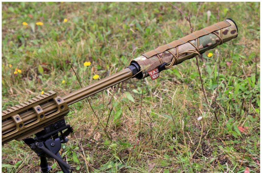
Der kaltgehämmerte Lauf ist geflutet. Der haus-eigene Signaturverzerrer Mod. X2 verlängert die Waffe effektiv um 19 cm. Die Schalldruckpegelreduktion wird vom Hersteller mit 30 db angegeben.
