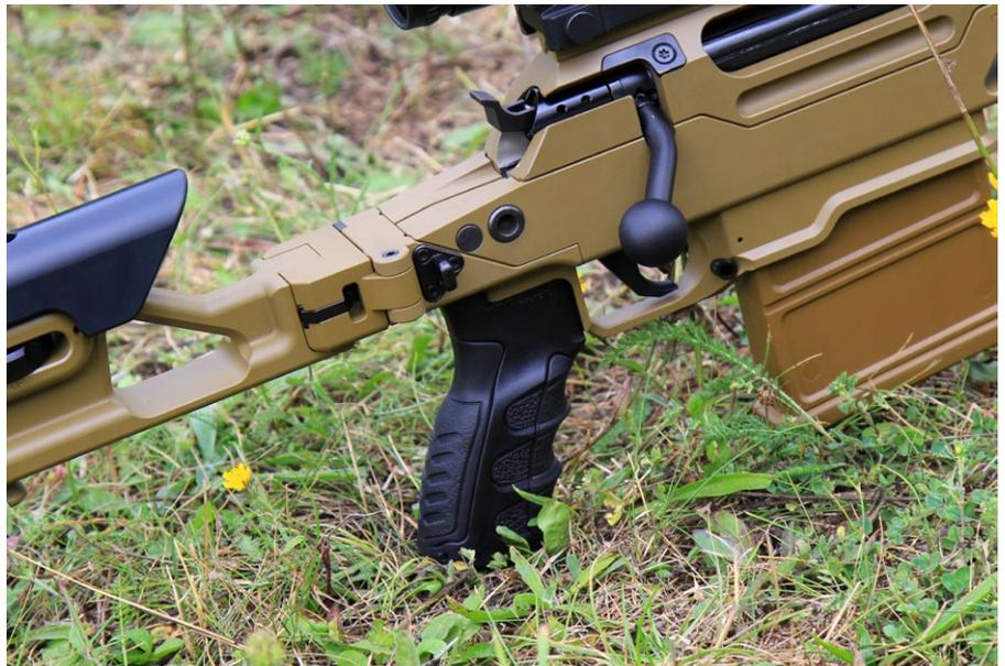
Der Abstand zwischen dem Griff und dem Abzug lässt sich je nach Handgröße anpassen. Insgesamt besteht die Möglichkeit, den Abzug um 20 mm zu verschieben.
