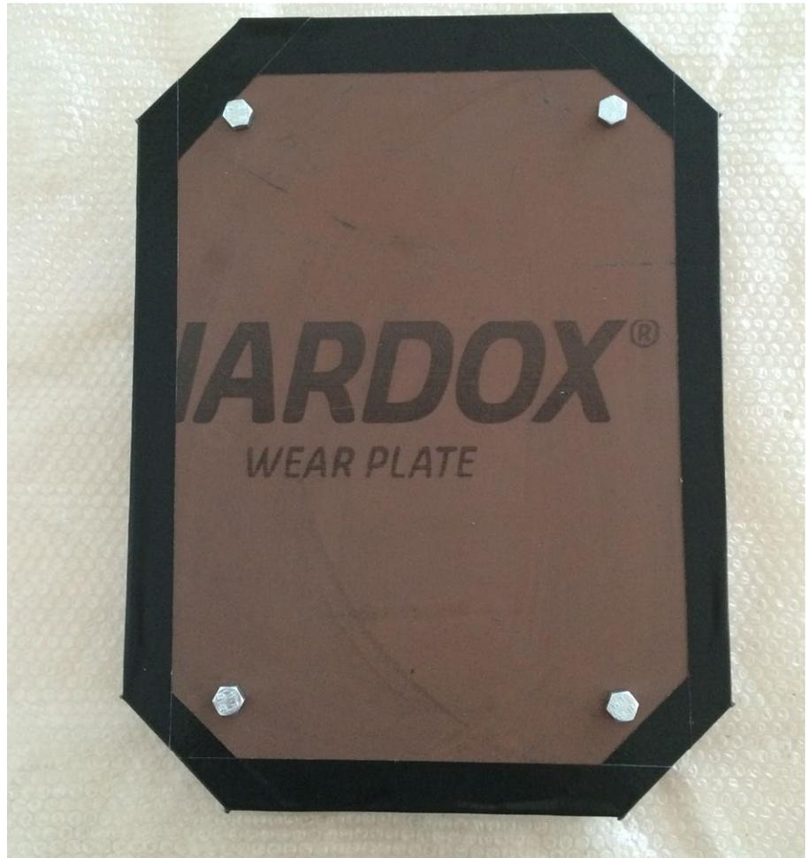
Scharfe Kanten können mit Gewebeband umklebt werden. Empfehlenswert ist, die Kanten im Herstellungsprozess gleich mit entgraten zu lassen.
