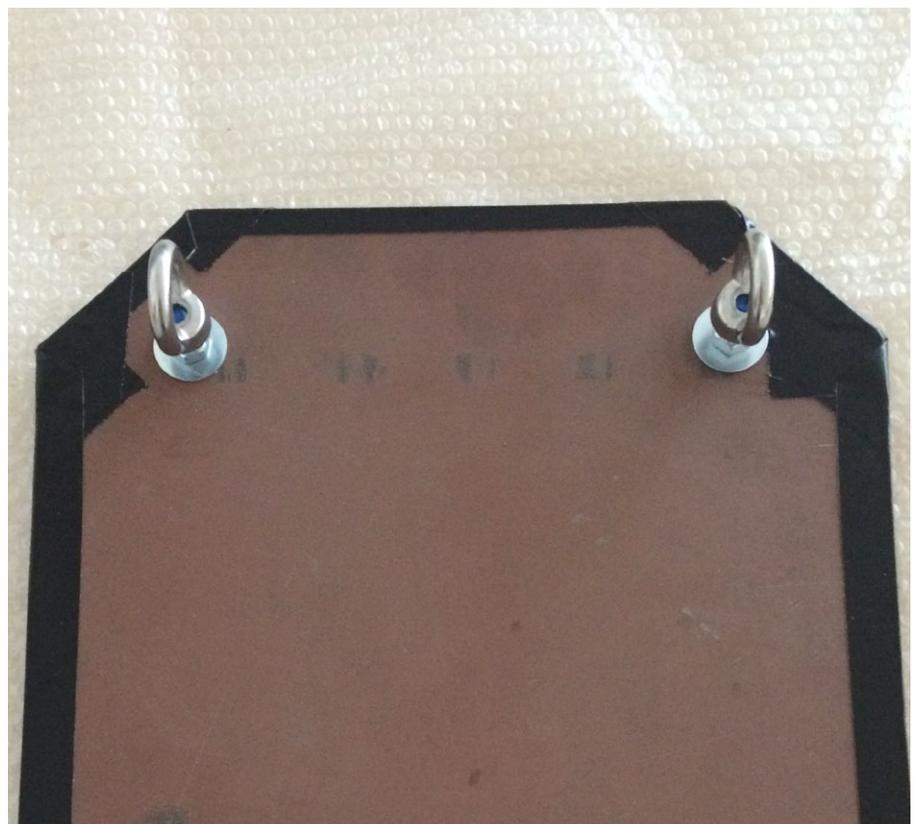
Vier Sechskantschrauben M8x35 mit Unterlegscheiben 25 mm sowie zwei Muttern M8 und zwei Ringmuttern M8 dienen als Befestigung für die Halteelemente.
