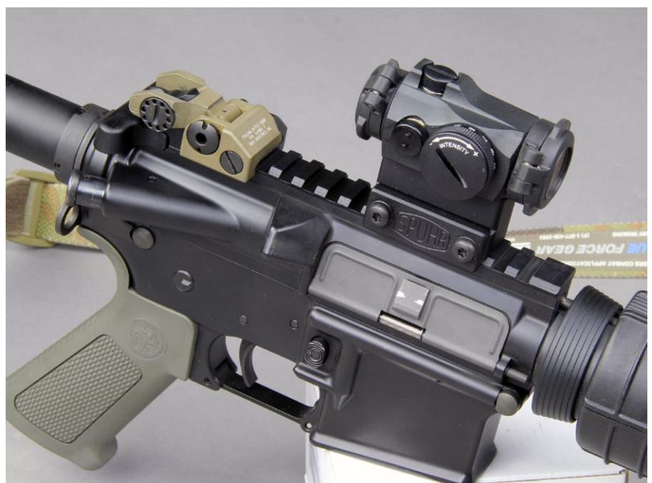
Neu beim T-2 ist der mechanische Schutz der oberen Verstellerschraube. Die beiden Noppen der Abdeckung der seitlichen Verstellerschraube dienen gleichzeitig als Werkzeug. Eine Back-Up Visierung sollte grundsätzlich vorhanden sein. Das Klappkorn ist vom Hersteller Troy.
