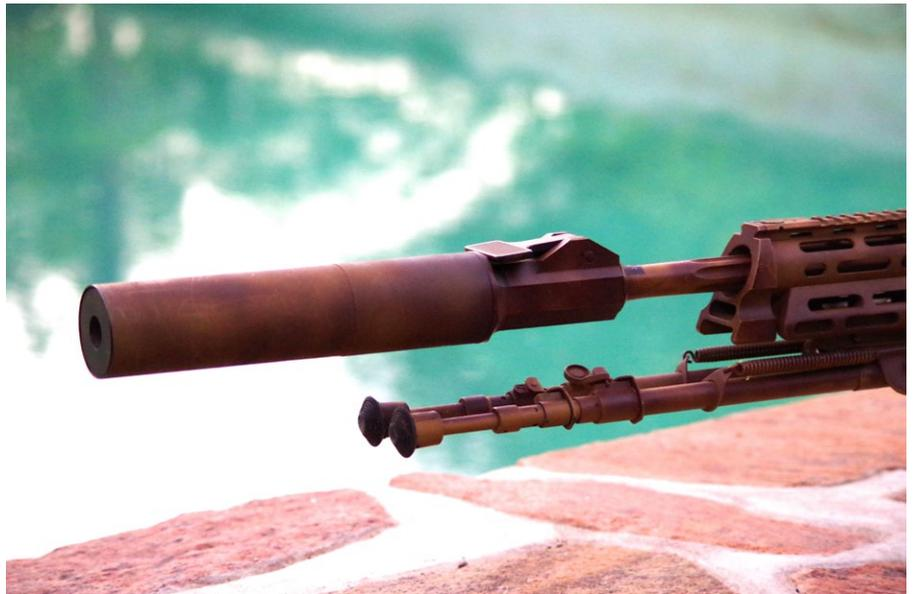
Der speziell für das DSR1 entwickelte Schalldämpfer mit Klemmvorrichtung für die Mündungsbremse
