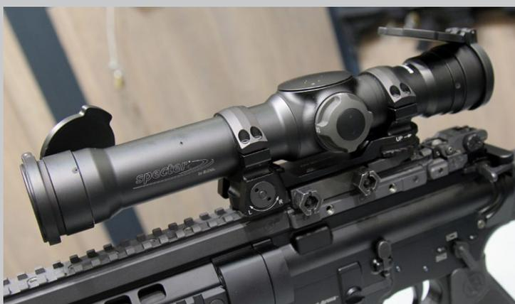
Ein Prototyp des Specter 1x / 3x / 9x war am Stand von Oberland Arms ausgestellt. Von der Bauweise her ähnelt das neue Specter mehr einem ZF. Die wählbaren Vergrößerungen betragen 1-fach bzw. 3-fach oder 9-fach. Bei 1-facher Vergrößerung ist nur der Rotpunkt illuminiert. Bei 3-fach das gesamte ballistische Absehen. Bei 9-fach vergrößert sich das ballistische Absehen. Die Lieferbarkeit wurde auf Sommer 2015 datiert. Der Endverbraucherpreis soll bei etwa 3.800 Euro liegen.
