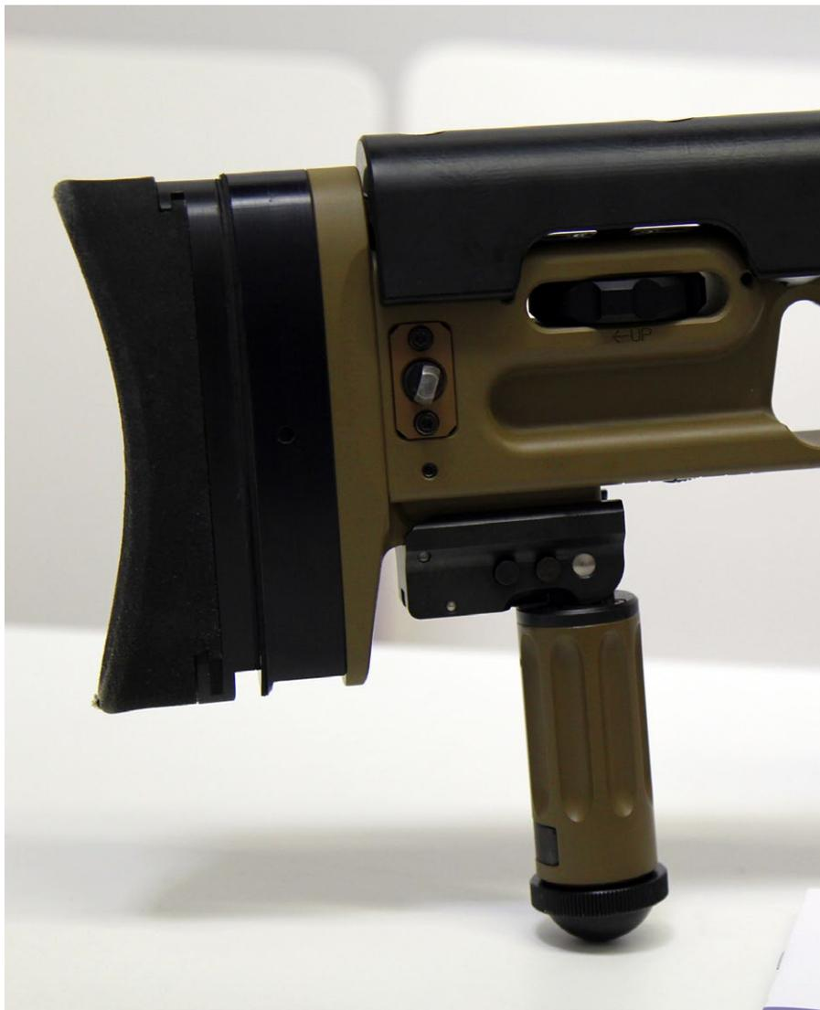
Über eine Picatinny-Schnittstelle am Schaft kann ein Hecksporn / Erddorn montiert werden.
