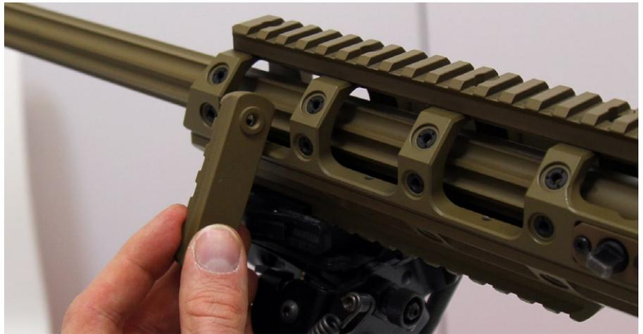
Optional verfügbare Picatinnyrillen für den Vorderschaft sind so konstruiert, dass sie sowohl Kraftschluss als auch Formschluss erzeugen, wodurch die Stabilität erhöht wird.
