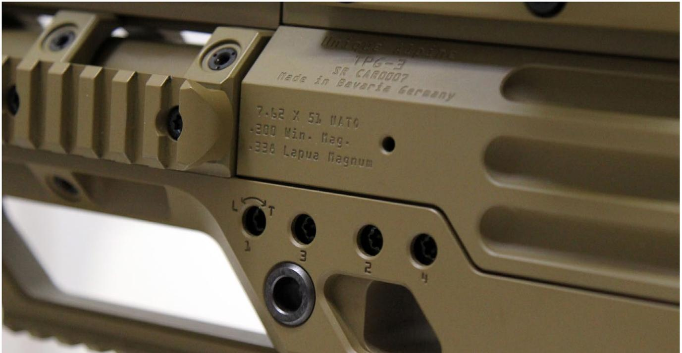
Auch wenn die BW keine Kaliberwechselfähigkeit fordert, das Merkmal bleibt auch bei der A5-Version bestehen. Die vier Schrauben sind entsprechend durchnummeriert und „unverlierbar“ in das Gehäuse integriert.
