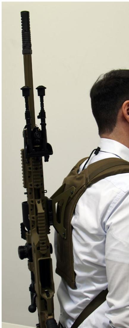
Der Ausrüster Lindnerhof-Taktik hat ein Tragesystem für die TPG-3 konstruiert. Die Waffe kann damit bspw. beim Abseilen sicher und robust geführt werden.
