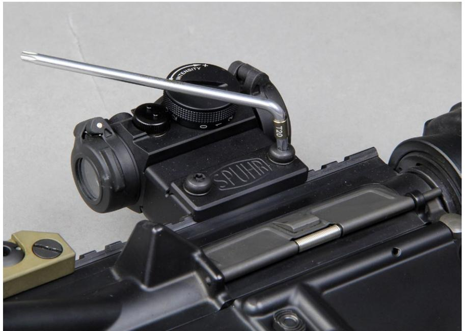
Zum Befestigen der SPUHR-Montage ist ein Torxschlüssel der Größe T20 erforderlich.
