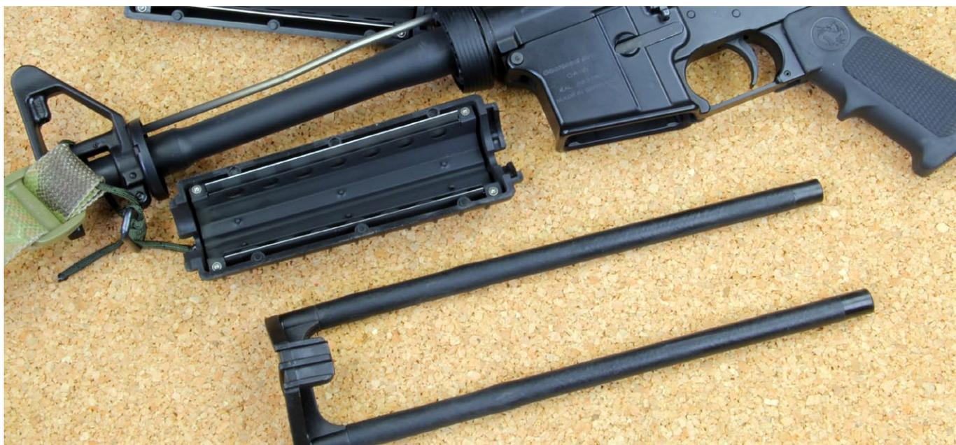
Oberland Arms verbaut serienmäßig an allen Black Label Gewehren einen Handschutz aus Eigenproduktion, mit einem doppelten Wärmeleitblech. Der Handschutz des M4 sollte nur mit dafür vorgesehenem Werkzeug demontiert werden.
