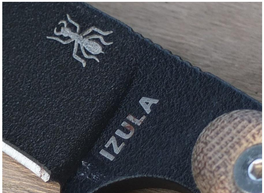
Aufgrund der erhöhten Korrosionsanfälligkeit des Stahls und der bewusst minimalistischen Pflege während des Langzeittests bildeten sich im Laufe der Zeit kleine Oxydationsansätze an den ungeschützten Stellen.
