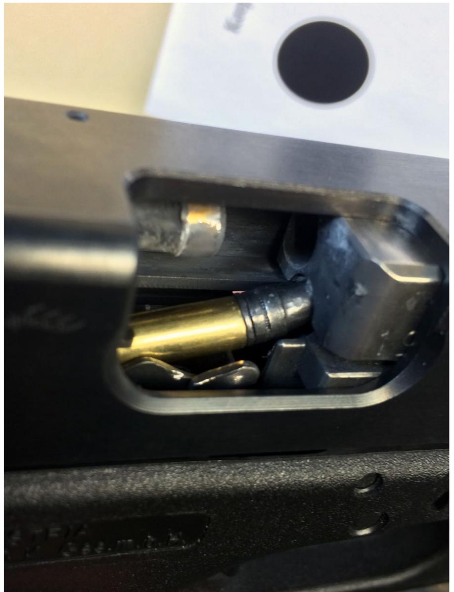
Zuführstörung: Gelegentlich verkeilen sich die weichen Bleigeschosse an der oberen Patronenlagerkante.
