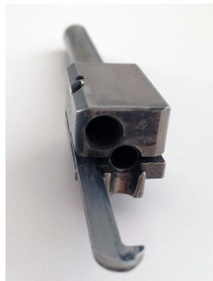
Laufblock mit Expansionskammer (oben links), Patronenlager und Zuführrampe. Im Vordergrund der hakenförmige Ausstoßer.
