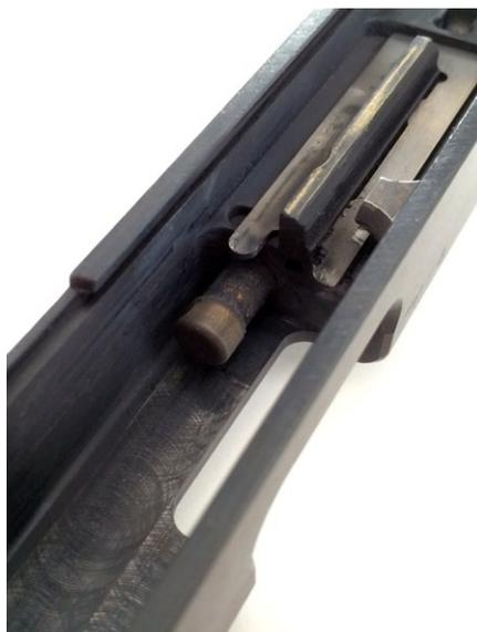
Der am Verschluss befestigte Rückstoßbolzen (Bildmitte).
