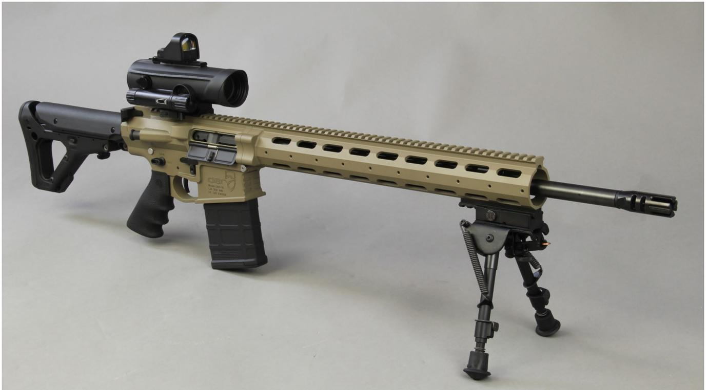
DAR-10 Designated Marksman Rifle Advanced mit einem 20" Heavy Barrel Light und dem DAR Heavy Tex Comp Mündungsfeuerdämpfer. Der Cerakote Farbton trägt die Nummer H-265 (Flat Dark Earth). Als Visiereinrichtung trägt die Waffe noch einen Prototyp des Zeiss 4x30. Der Hinterschaft ist ein längenverstellbarer MagPul UBR.
