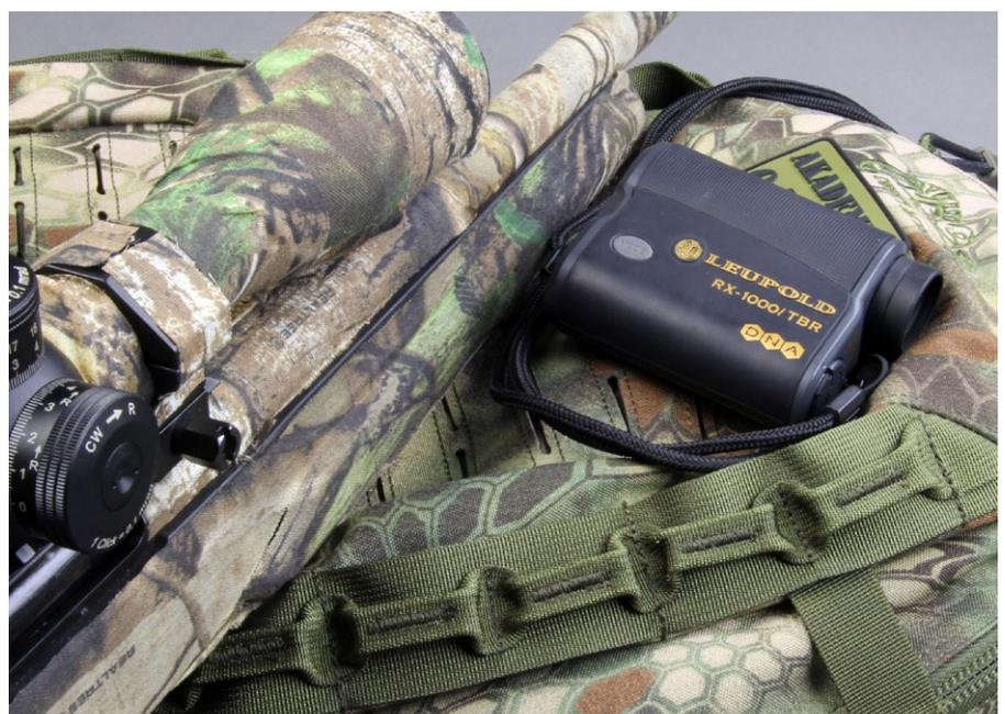
Der RX-1000i TBR ist kaum größer als eine Zigarettenschachtel, misst Entfernungen bis zu 910 m und gibt dem Schütze eine Flughöhenangabe in MIL. Der Neigungsmesser gleicht die lineare Entfernung mit der ballistischen Entfernung ab.
