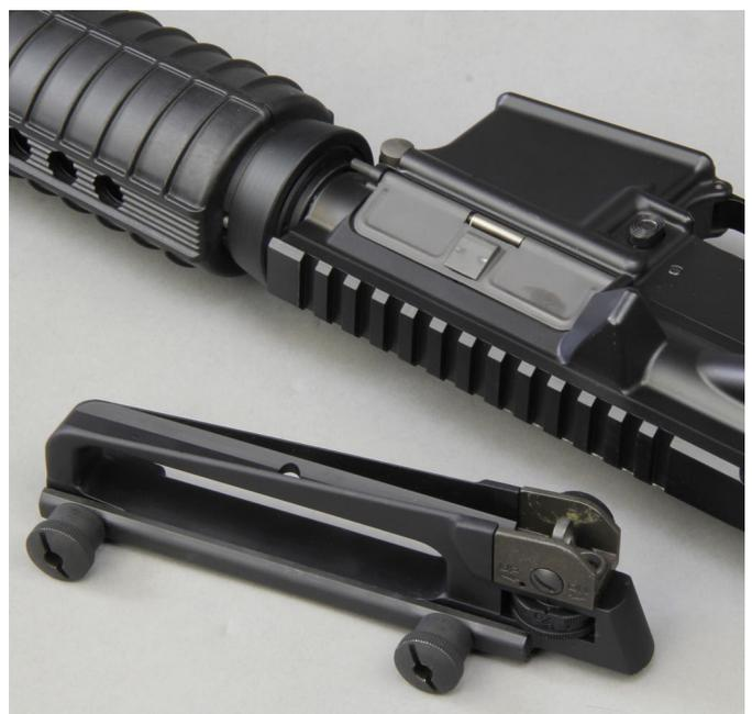
Die A2-Tragegriffvisierung ist abnehmbar. Das A3-Gehäuse kann mit anderen Visiereinrichtungen bestückt werden.
