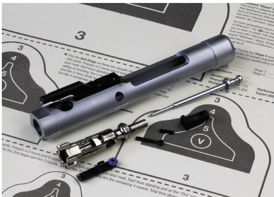
Der Verschlusskopf ist vernickelt. Unter der Ausziehkralle sitzt ein O-Ring (blau), wodurch leere Hülsen mit mehr Kraft ausgeworfen werden.
