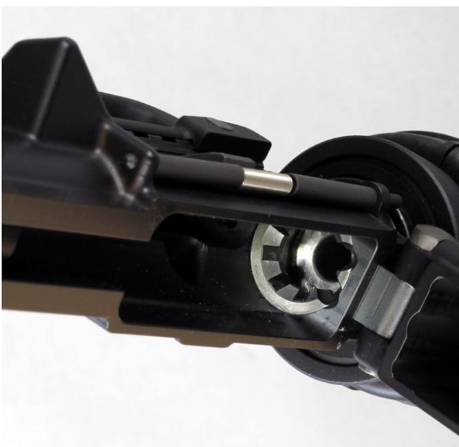
Die so genannten M4-Rampen helfen im Grenzbereich bei starker Verschmutzung oder Munitionsdefiziten Zuführstörungen zu vermeiden.
