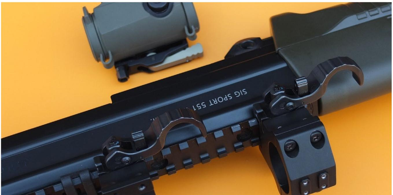
Die Ringe sollten so weit wie möglich auseinander montiert werden, da ein großer Montageabstand die Stoßunempfindlichkeit und die Wiederholgenauigkeit erhöht. Als Wechseloptik dient ein Aimpoint Micro T 1.
