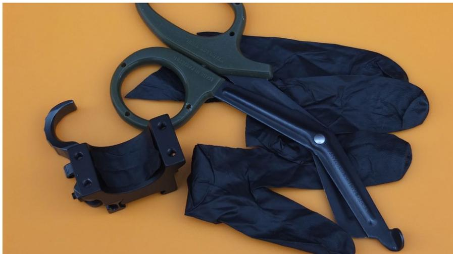
Das Einlegen von Kautschukstreifen erhöht den Reibwert zwischen ZF und Montage. Die ca. 0,1 mm dünnen Streifen lassen sich aus Nitril-Einmalhandschuhen zurechtschneiden.
