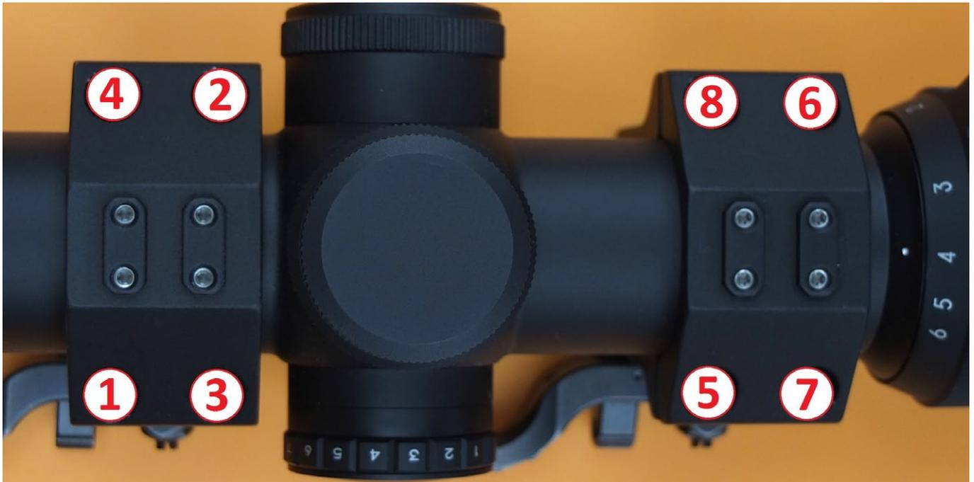
Die Schrauben der oberen Ringhälften sind gemäß der Nummerierung 1 – 8 in mehreren Durchgängen gleichmäßig anzuziehen. Vorsicht, nicht überdrehen!
