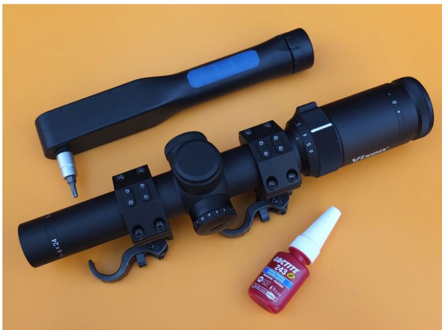
Als Schraubensicherung eignet sich das mit normalem Handwerkszeug wieder lösbare Loctite 243 (blau). Ein Drehmomentschlüssel gewährleistet exaktes und wiederholgenaues Arbeiten.
