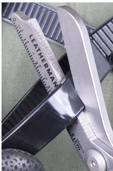
Die messerscharfe Verzahnung auf der unteren Schneide arbeitet äußerst effektiv. Die Schneidleistung des Tools überzeugte während der Erprobung.
