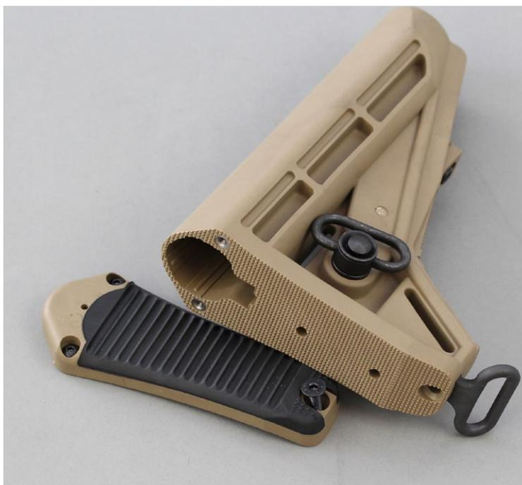
Die Kappe ist abschraubbar. Der Mil-Spec Schaft kann auch ohne benutzt werden. Die untere Schraube fixiert gleichzeitig die Riemenöse. Die QD-Öse findet sowohl rechts als auch links eine Aufnahme.
