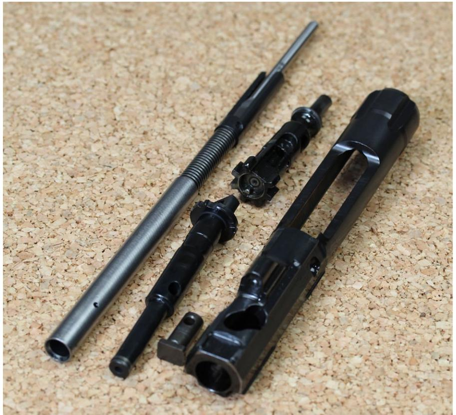
Die Funktionsteile der SIG 516 nachdem sie mit FIREClean bearbeitet wurden: Gasdüse und Pistonstange sowie die Verschlussbaugruppe.
