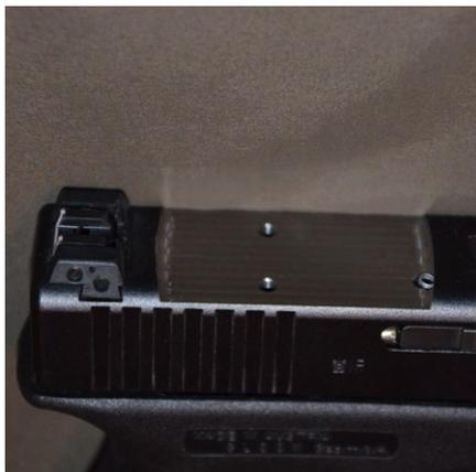
Im vorderen Bereich der Fräsung liegt die Schlagbolzensicherungsfeder ohne aufgesetztes LPV zum Großteil frei. Mittig die Montagebohrungen für das LPV.
