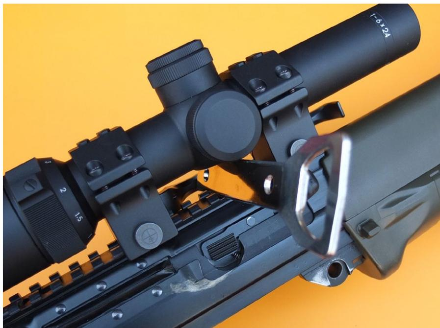
Das lotrechte Ausrichten des Absehens ist mithilfe eines Blechstreifens schnell und präzise erledigt.
