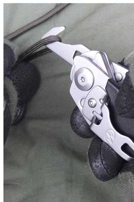
Der Gurtcutter kann wie ein Spyderco-Klappmesser einhändig geöffnet werden. Die V-förmige Schneide durchtrennt Paracord und Kabelbinder problemlos.
