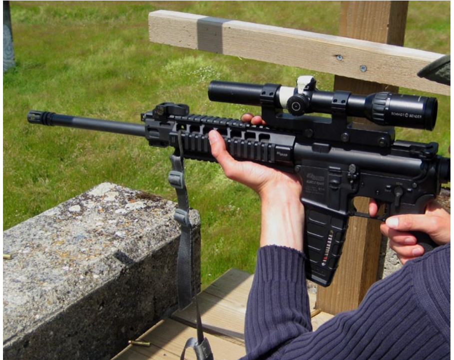
Das hier montierte 1,5-6x20 PM Flash Dot verfügt über eine Klickverstellung im mil-System (10mm auf 100m). Auch die Drehrichtung der Verstelltürme entspricht mit cw (clockwise) dem europäischen Standard.
