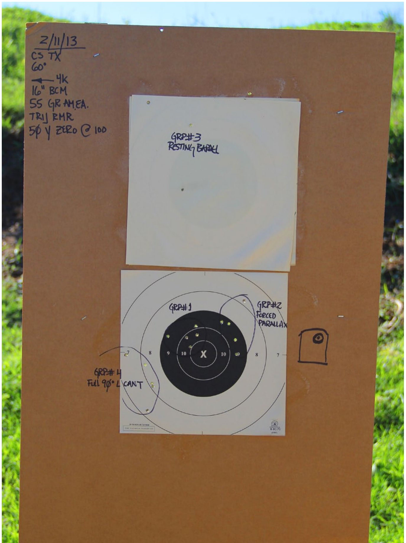
...im Ergebnis vergrößerte sich die Gruppe extrem (GRP#3 oben). GRP#2 zeigt das Resultat eines bewusst herbeigeführten Parallaxenfehlers mit Rotpunkt nach rechts oben verschoben. GRP#4 zeigt die Ablage, wenn das Gewehr um 90° nach links verkantet wird. Im Vergleich dazu GRP#1, die aus einem normalen Liegendanschlag heraus geschossen wurde. Alle Gruppen wurden auf 100 Yard mit einem 50-Yard-Zero geschossen.
