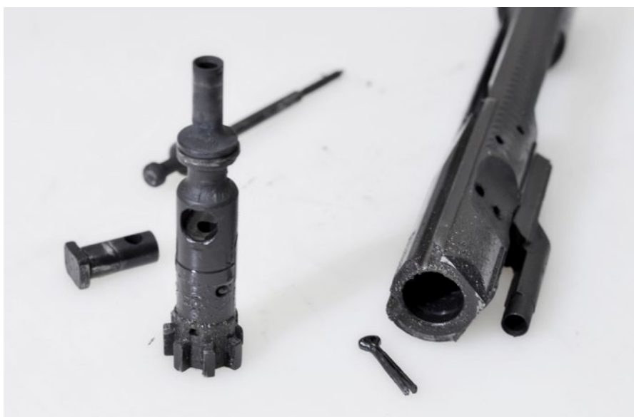
Die Verschlussbaugruppe verschmutzt relativ stark gleich ändern...
