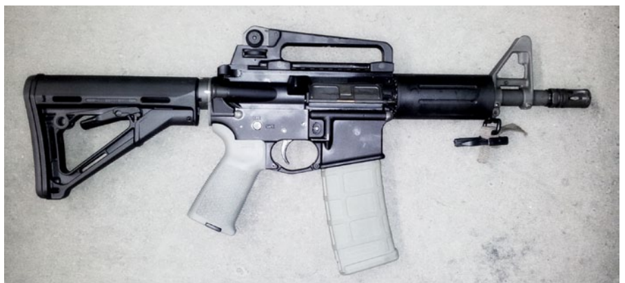
Das originale 7,5" Sabre Defense Wechselsystem mit dem Donor Lower Receiver
