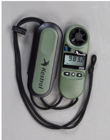
Beim 2500 NV zeigt ein Tendenzindikator in Pfeilform die Luftdruckveränderung der letzten drei Stunden an. (hier: stark steigend)
