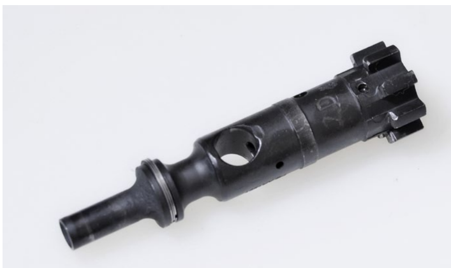
Starke Verschleißerscheinungen an den Ecken der Verriegelungswarzen nach etwa 1.000 Schuss
