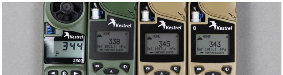
Der Hersteller gibt bei der Höhenmessung eine Toleranz von 15 Metern an. Unsere vier Testgeräte weisen eine Differenz von sieben Metern aus. Der Referenzluftdruck ist jeweils auf 1013,15 HPa eingestellt.
