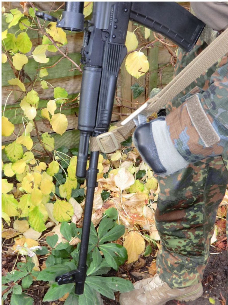
Die vordere Stellung des VCAS ermöglicht es die Waffe dicht am Körper zu tragen.
