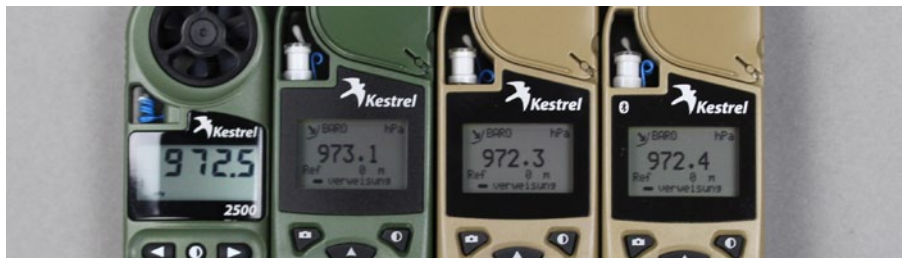
Der Luftdruckmesser hat eine Differenz von 0,8 HPa.
