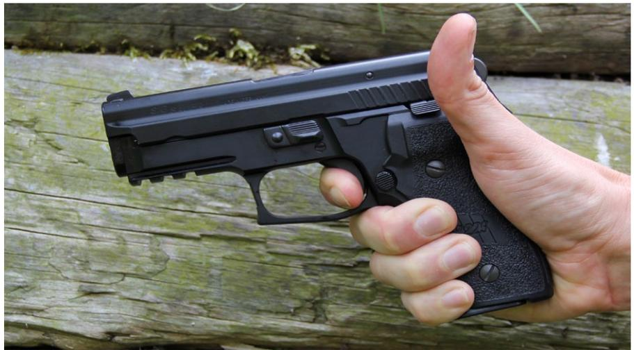
Der Schuss wurde ausgelöst, der Finger befindet sich am hinteren Endpunkt.
