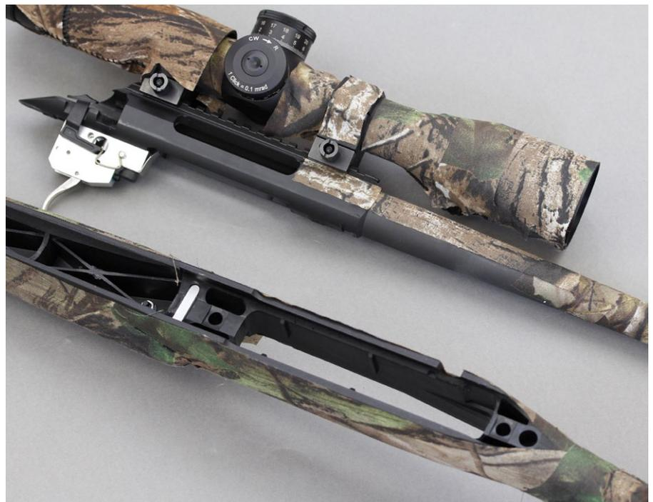
Um das Freischwingverhalten des Laufes nicht negativ zu beeinflussen, sollte im hinteren Bereich die Laufunterseite nicht beklebt werden. Kontaktstellen zwischen Lauf und Schaft sind zu vermeiden.
