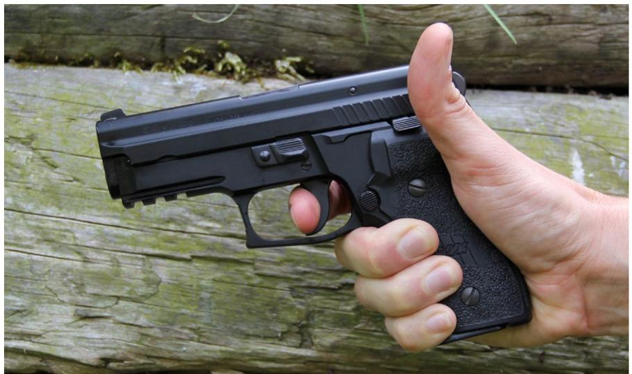
Mittels Trigger Reset wird der Abzug bis zur ersten Rastung nach vorn geführt. Mit dem kurzen Abzugsweg müssen jetzt etwa 5 kg überwunden werden.
