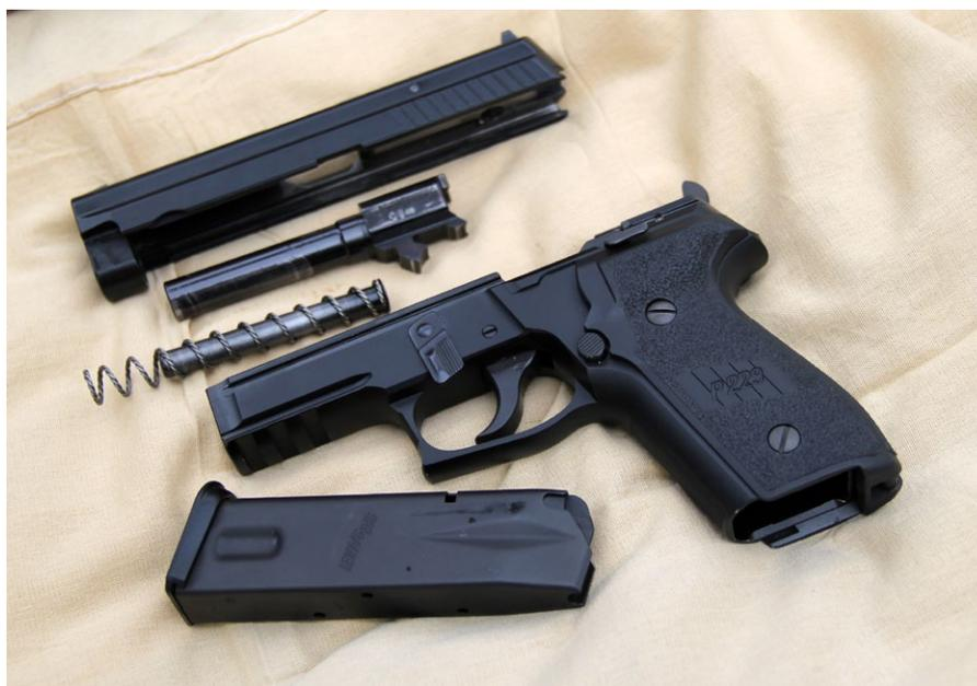
Weder beim Zerlegen der P229 noch im Funktionsprinzip gibt es Überraschungen. Alles entspricht der großen Schwester P226. Allerdings fehlt der Entspannhebel, welcher für das DAK-Abzugssystem nicht notwendig ist.
