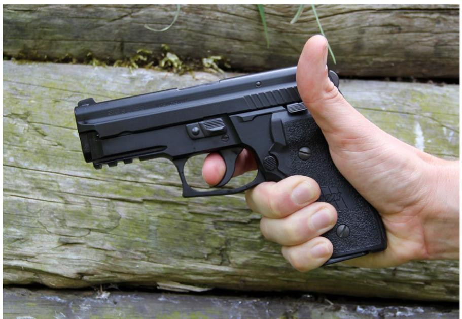
Oder der Abzug wird wieder ganz nach vorn geführt, bis er zum zweiten Mal einrastet. Jetzt müssen nur 3,5 kg Widerstand überwunden werden, allerdings mit einem langen Abzugsweg.
