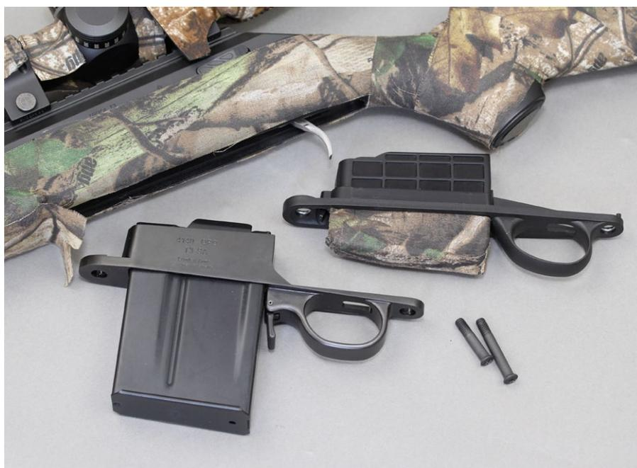
Der Austausch der Magazinaufnahme erfordert Umbauarbeiten, die einen Rückbau hin zum Originalteil erschweren bzw. unmöglich machen, da am Kunststoffschäft Material abgetragen werden muss.
