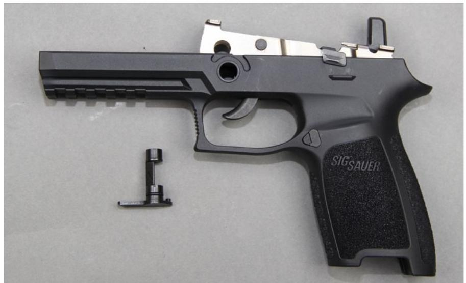
Wird der Zerlegehebel herausgezogen, kann auch die Abzugseinheit entnommen werden.
