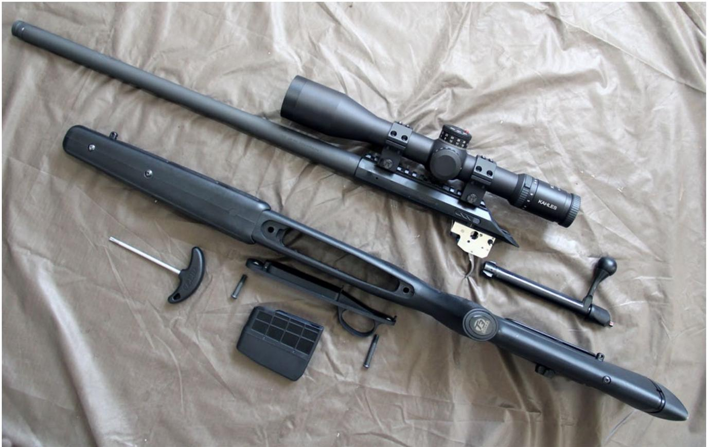
Das Zerlegen einer T3 ist denkbar einfach. Der Schlüssel wird mitgeliefert. Die Riemenösen lassen sich problemlos an die linke oder auch rechte Seite des Schafts anschrauben.
