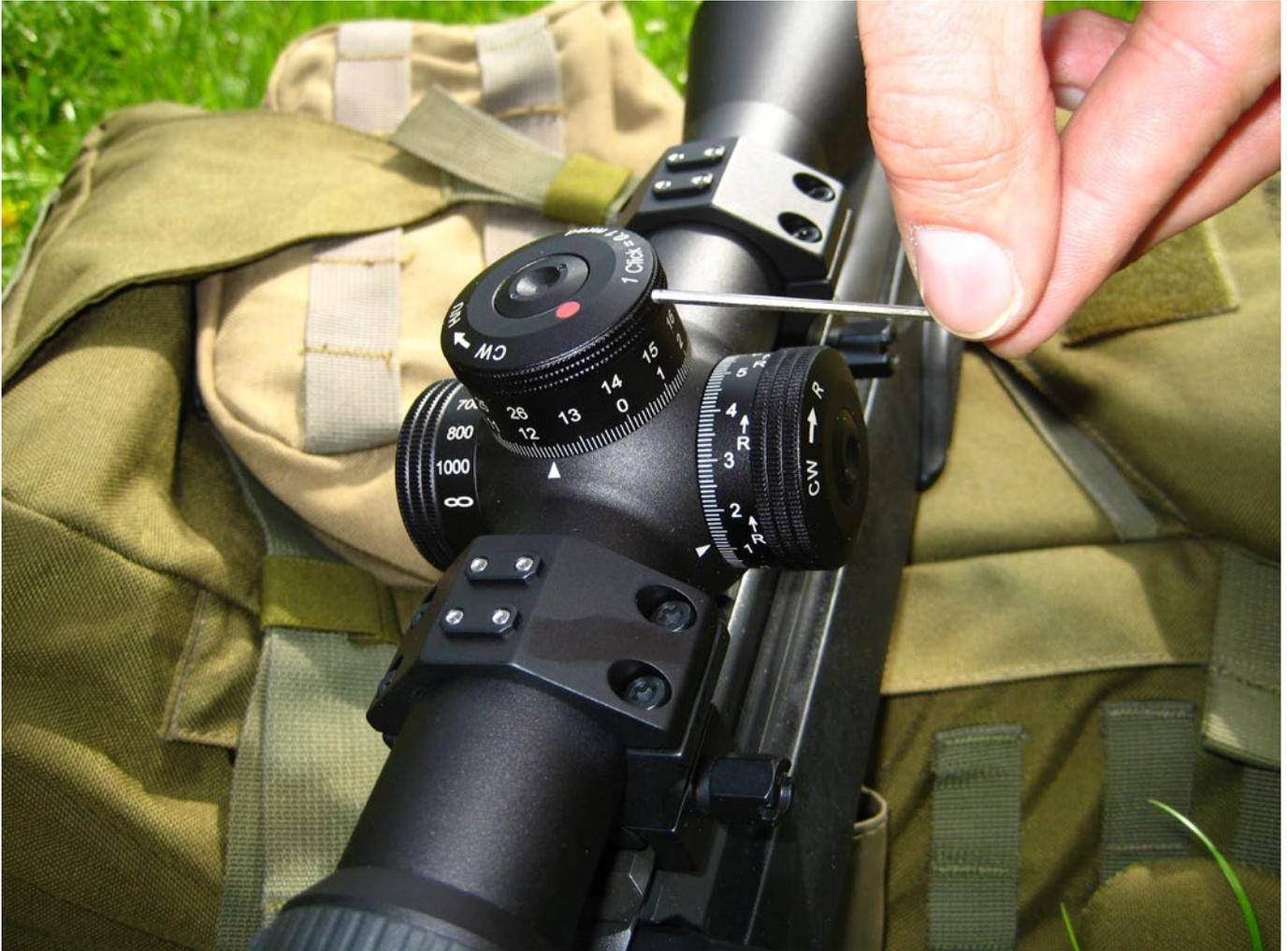
Am Ende werden die Verstelltürme wieder „genullt“. Der Innensechskantschlüssel dient dabei gleichzeitig als Hebel.
