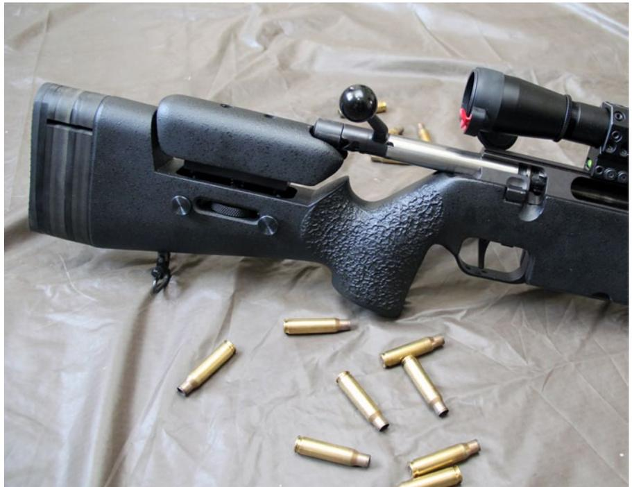
Die höhenverstellbare Schaftbacke besitzt eine Aussparung, welche den Repetiervorgang weiterhin störungsfrei ermöglicht.
