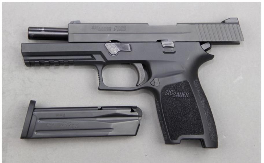
Das feldmäßige Zerlegen erfolgt SIG Sauer typisch über einen Zerlegehebel an der linken Griffstückseite.
