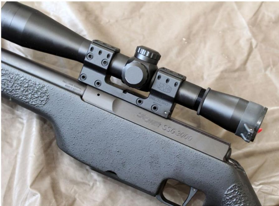
Auf der 12 mm Prismenschiene sitzt eine Montage von Spuhr mit 20 MOA Vorneigung.
