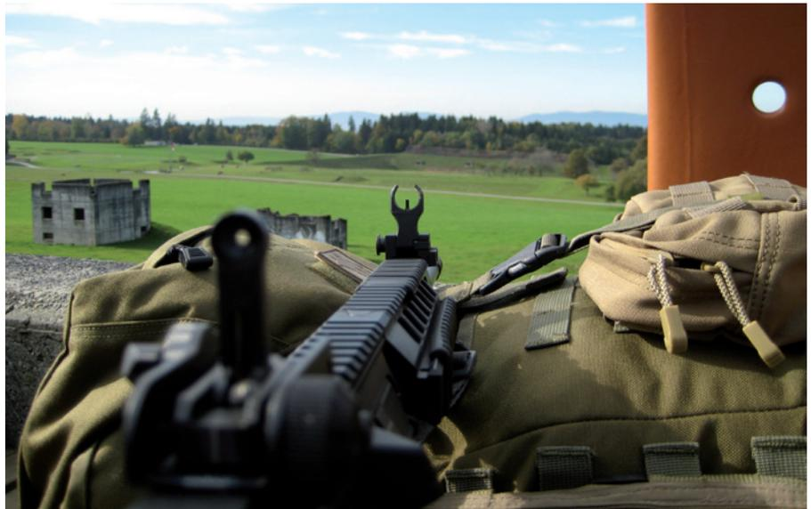
Über die Hälfte aller Schussabgaben absolvierte die SIG 516 über eine offene Visierung: Die Lochkimme stammt von MaTech das Klappkorn von Samson. Trotz der relativ kurzen Visierlinie waren Treffer auf 550 Meter realisierbar.
