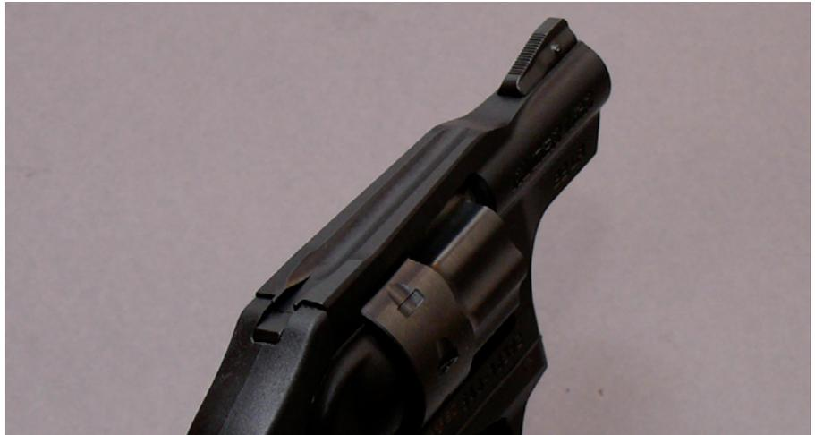
Die Visiereinrichtung des LCR-22 ist einfach gehalten. Ein Austausch des Korns ist möglich und empfehlenswert.
