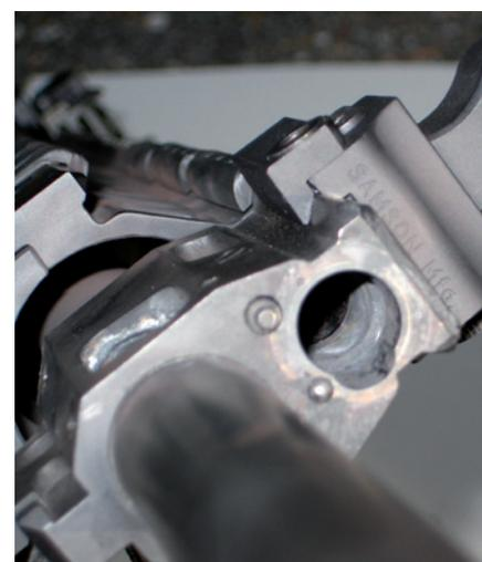
Auch innerhalb der Aufnahme im Gasblock lagert sich Pulverschmauch ab. Diese Stelle hat zwar keinen funktionsrelevanten Einfluss, sollte aber dennoch von Zeit zu Zeit mit gereinigt werden. Das Gasventil lässt sich dann leichter entnehmen.
