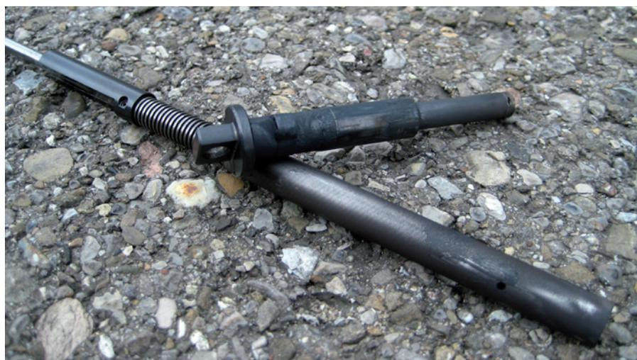
Im Bild das verschmutzte Gasventil (oben) mit Gasstange inklusive Gasstangenfeder. Der Ausbau und das Zerlegen dauern zehn Sekunden. Der Einbau wiederum dauert nicht viel länger.
