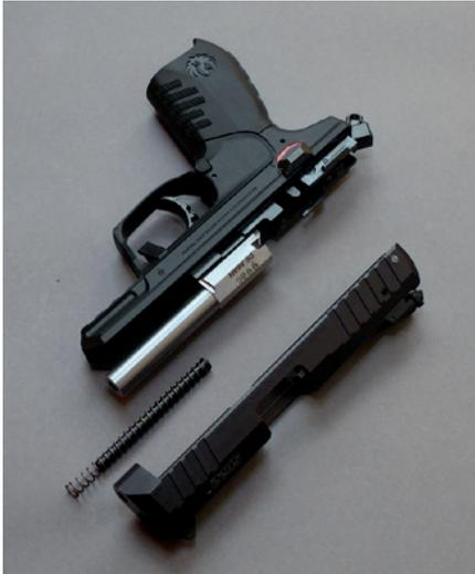
Der Schlitten ist aus Aluminium, das Griffstück aus Polymerkunststoff. Der unverriegelte Masseverschluss und die Schließfeder entsprechen dem rückstoßarmen Randfeuerkaliber.
