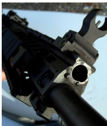
Die Aufnahme für das Gasventil. Diese nimmt aufgrund des Funktionsprinzips viel Verschmutzung auf. Die Schmauchablagerungen sind nach 500 Schuss ganz erheblich. Reinigungsintervalle sollten hier nicht unnötig verzögert werden.
